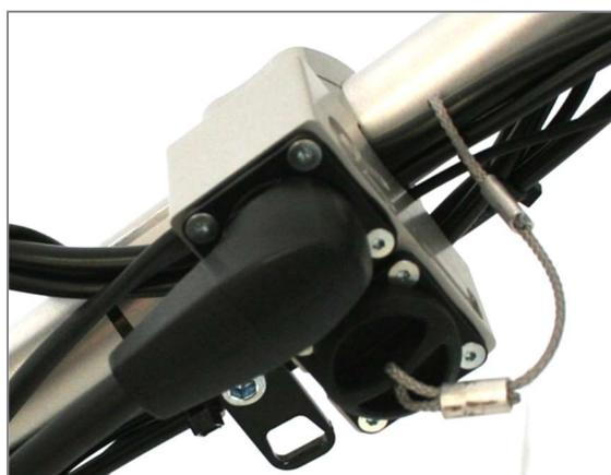
Figura 34: Batteria destra collegata; connettore magnetico nella presa "R"
