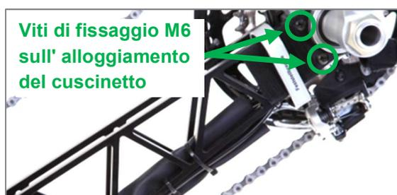
Figura 13: Viti di fissaggio M6 sull'alloggiamento del cuscinetto
