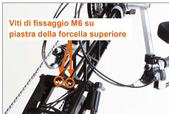
Figura 12: Viti di fissaggio M6 su piastra della forcella superiore
