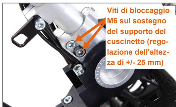
Figura 15: Viti di bloccaggio M6 per la regolazione dell'altezza della posizione del cuscinetto di movimento
