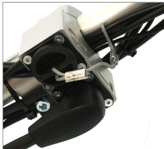
Figura 35: Batteria sinistra collegata; connettore magnetico nella presa "L"
