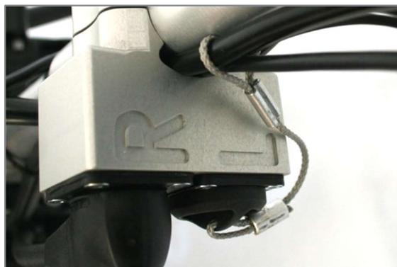
Figura 33: Supporto presa sul piantone con contrassegno "R" per batteria destra e "L" per batteria sinistra (vista dall'alto)
