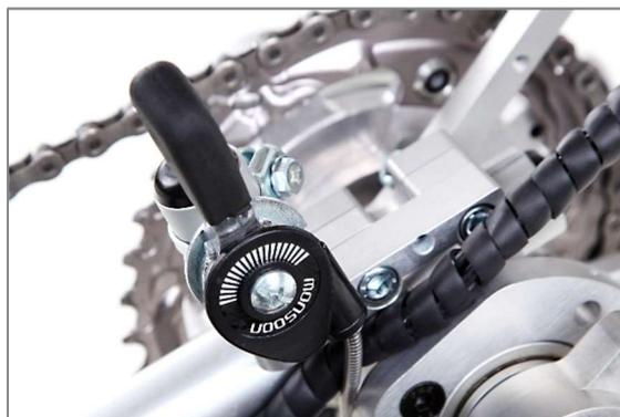
Figura 29: Freno di stazionamento mediante leva di arresto
