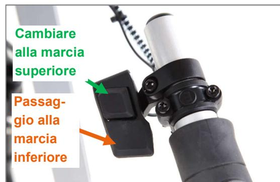
Figura 20: Pulsanti per passare ad una marcia superiore o inferiore
