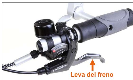
Figura 26: Leva del freno
