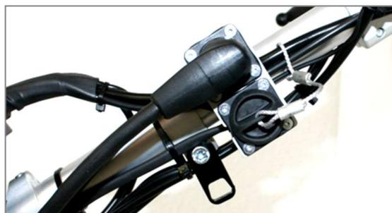
Figura 31: Dispositivo di riposizionamento sul piantone
