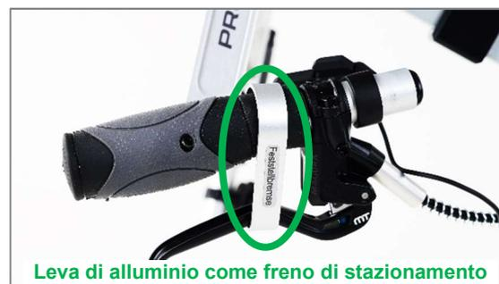
Figura 28: Leva di alluminio come freno di stazionamento
