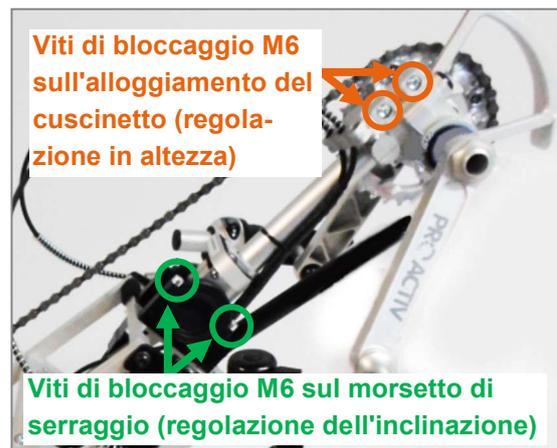
Figura 14: Viti di bloccaggio M6 per la regolazione dell'inclinazione e dell'altezza della posizione del cuscinetto di movimento
