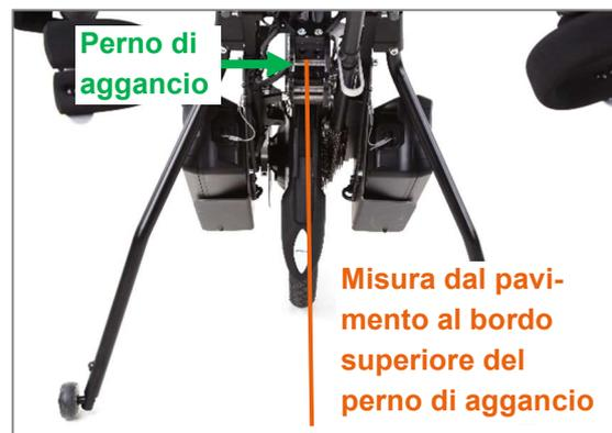
Figura 10: Misura dal pavimento al bordo superiore del perno di aggancio
