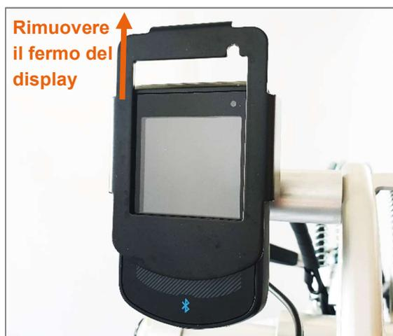
Figura 40: Rimozione del fermo del display
