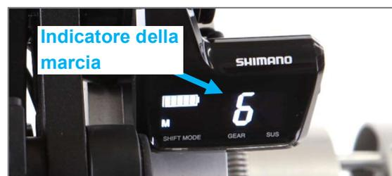
Figura 21: Indicatore della marcia attualmente inserita sul display
