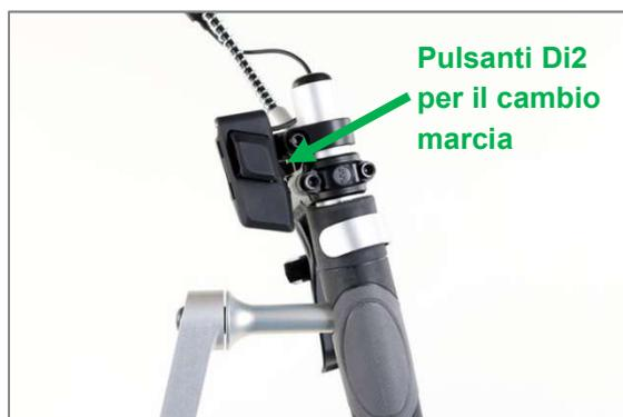
Figura 19: Comando mediante pulsanti
