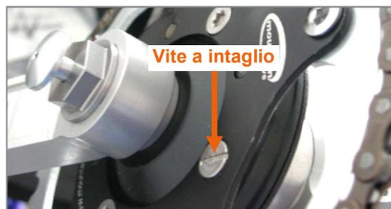
Figura 24: Vite a intaglio da ingrassare
