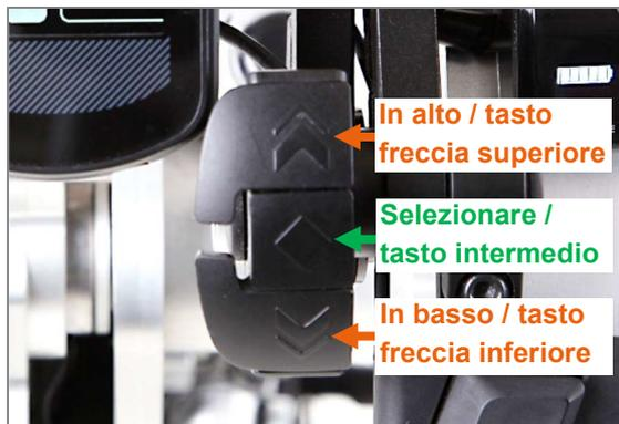
Figura 36: Tasti dell'unità di controllo
