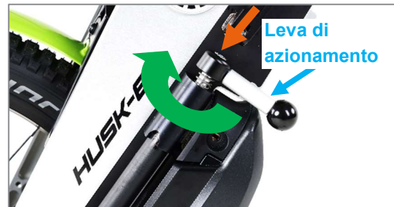
Figura 6: Premere verso il basso e ruotare la leva di azionamento
