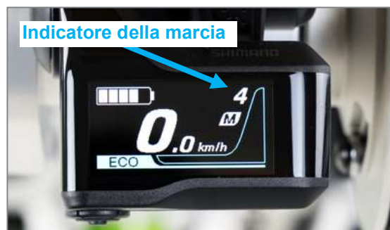
Figura 26: Indicatore della marcia attualmente inserita sul display
