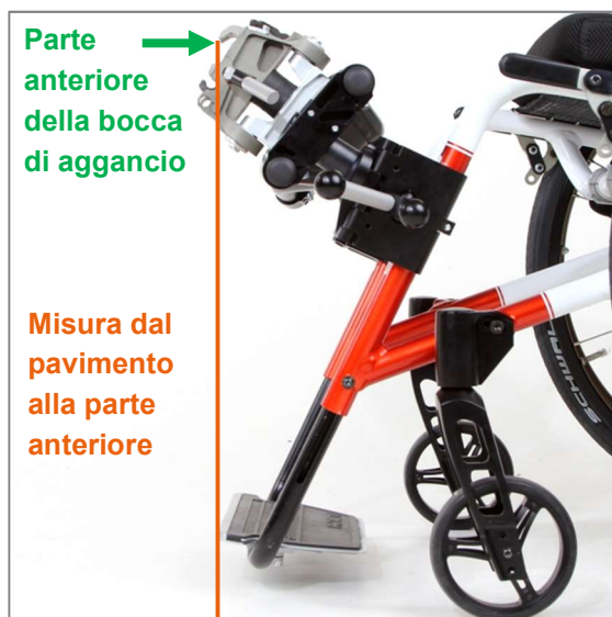
Figura 9: Misura dal pavimento alla parte anteriore della bocca di aggancio
