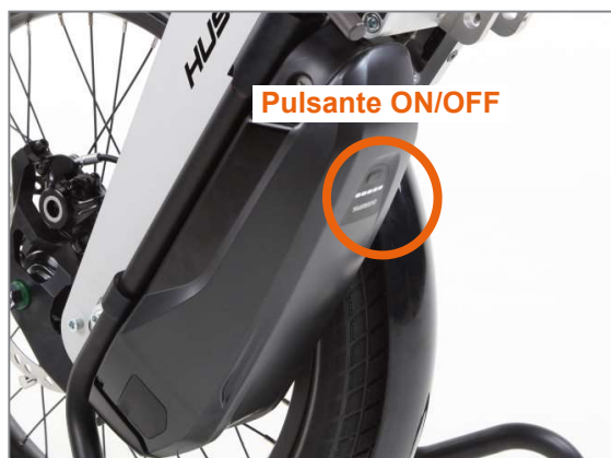
Figura 38: Accensione e spegnimento della batteria
