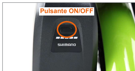
Figura 34: Pulsante di accensione e spegnimento sulla batteria
