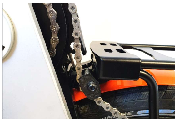
Figura 47: Portapacchi applicato, il supporto di rinvio della catena mette in tensione la catena
