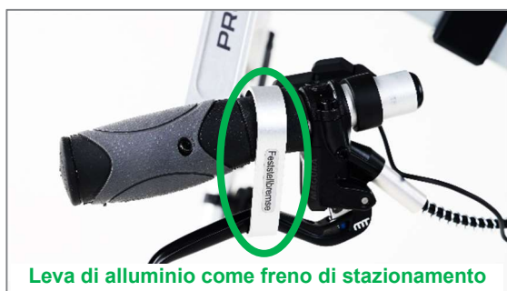
Figura 30: Leva di alluminio come freno di stazionamento
