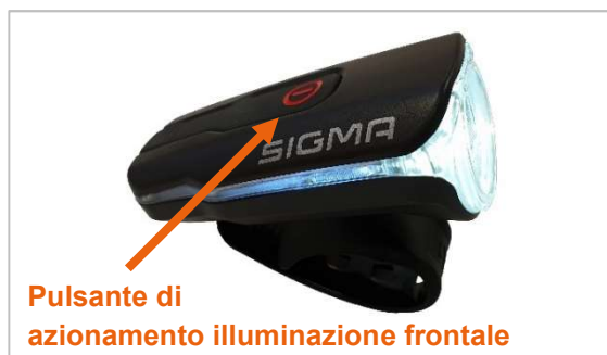
Figura 39: Pulsante di azionamento dell'illuminazione frontale
