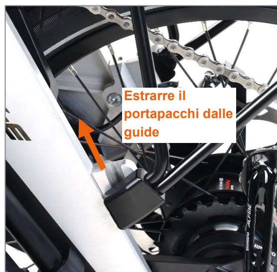
Figura 45: Estrarre il portapacchi dalle guide
