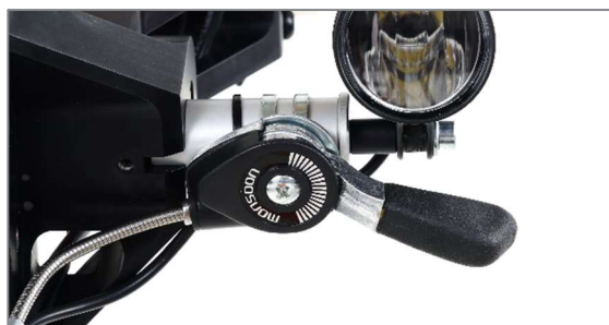
Figura 29: Freno di stazionamento mediante leva di arresto
