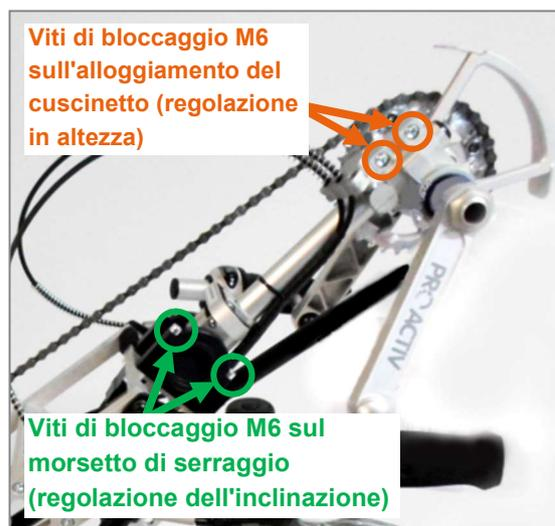
Figura 7: Viti di bloccaggio M6 per la regolazione dell'inclinazione e dell'altezza della posizione del cuscinetto di movimento
