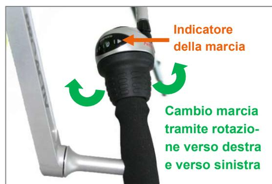
Figura 17: Cambio marcia tramite impugnatura girevole con cambio a mozzo Shimano Nexus
