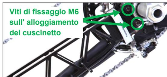
Figura 6: Viti di fissaggio M6 sull'alloggiamento del cuscinetto
