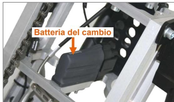
Figura 20: Batteria del cambio elettronico Alfine Di2
