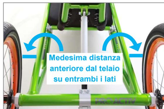
Figura 51: Distanza anteriore dal telaio
