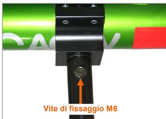
Figura 44: Viti di fissaggio M6 sui morsetti di serraggio sul tubo asse
