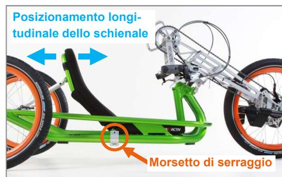
Figura 35: Morsetto di serraggio per il posizionamento longitudinale dello schienale
