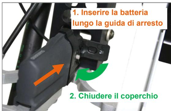
Figura 23: Dopo la ricarica collegare nuovamente la batteria
