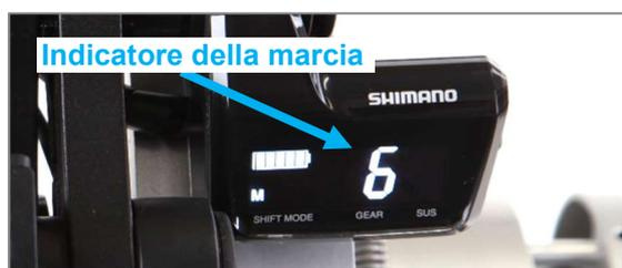
Figura 14: Indicatore della marcia attualmente inserita sul display
