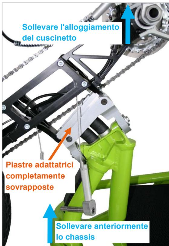
Figura 61: Piastre adattatrici di unità motrice e chassis una sopra l'altra
