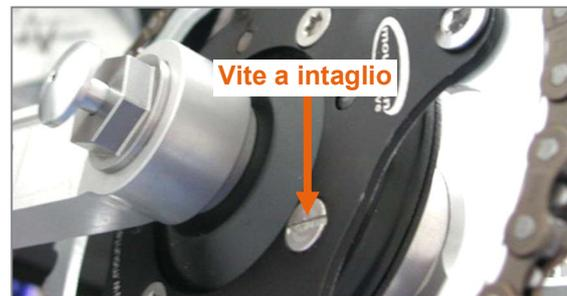
Figura 25: Vite a intaglio da ingrassare
