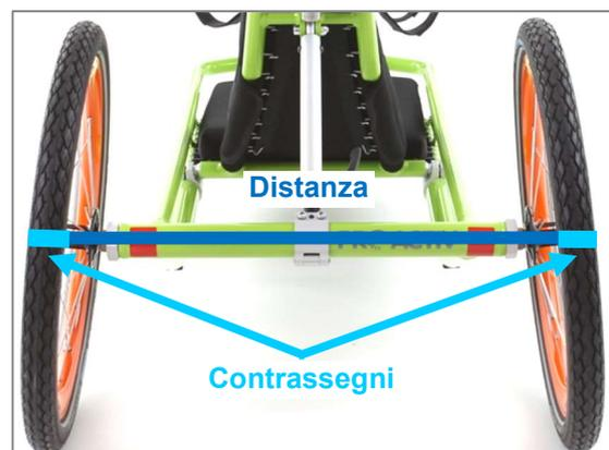
Figura 52: Distanza tra i contrassegni degli pneumatici (ad altezza asse), posteriormente
