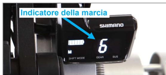
Figura 19: Indicatore della marcia attualmente inserita sul display
