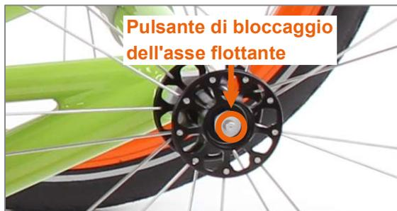
Figura 46: Pulsante di bloccaggio dell'asse flottante al centro dell'asse ruota
