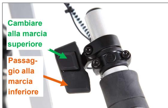
Figura 18: Pulsanti per passare ad una marcia superiore o inferiore
