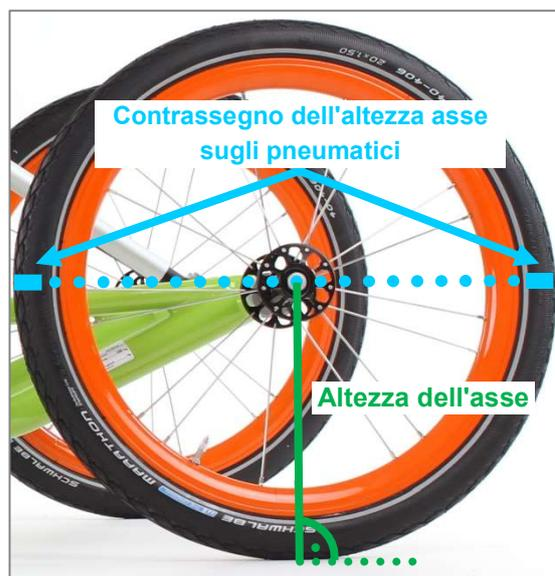
Figura 48: Contrassegno dell'altezza asse anteriormente e posteriormente su entrambi gli pneumatici delle ruote
