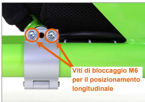
Figura 36: Regolazione longitudinale dello schienale tramite viti di bloccaggio M6 e morsetti di serraggio sul telaio del prodotto
