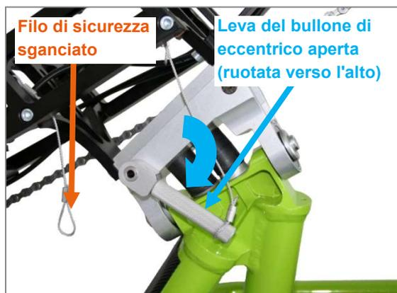
Figura 64: Leva del bullone di eccentrico aperta e filo di sicurezza sganciato
