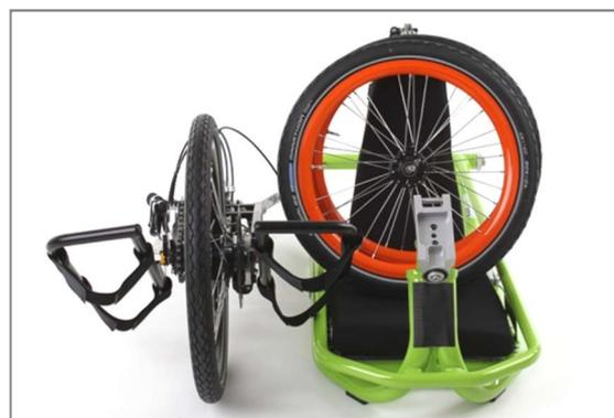
Figura 67: Ingombro: chassis e unità motrice separate e ruote rimosse
