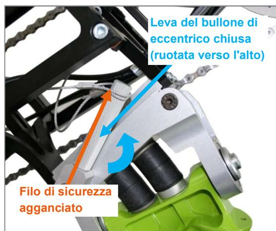
Figura 63: Unità motrice completamente adattata
