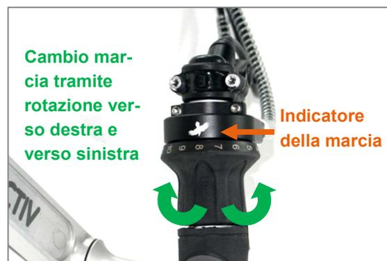
Figura 16: Cambio marcia tramite impugnatura girevole con cambio a mozzo Rohloff
