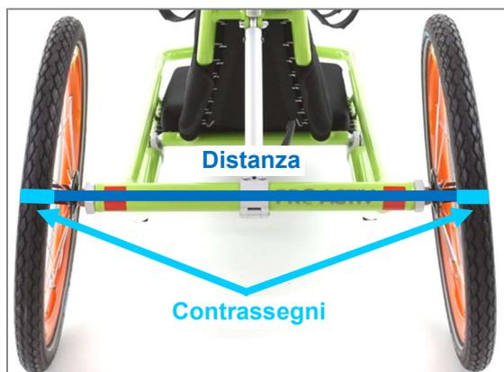
Figura 49: Distanza tra i contrassegni degli pneumatici (ad altezza asse), posteriormente
