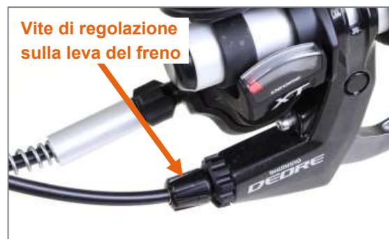
Figura 28: Vite di regolazione sulla leva del freno
