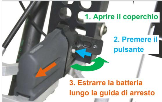
Figura 21: Rimuovere la batteria per la ricarica
