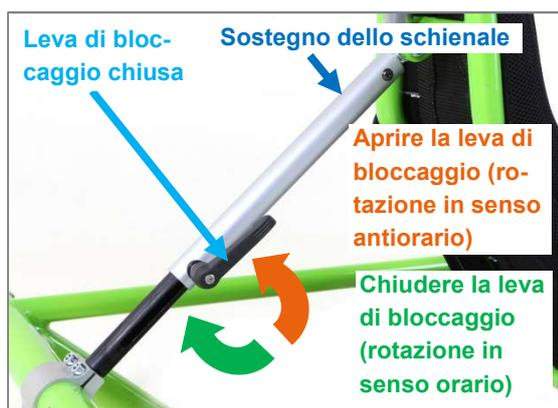
Figura 33: Regolazione dell'inclinazione dello schienale tramite leva di bloccaggio
