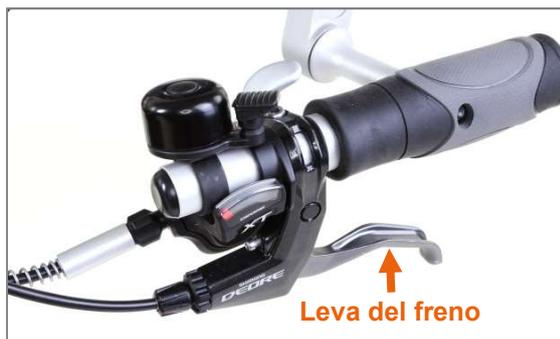
Figura 27: Leva del freno
