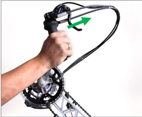
Figura 11: Corretto posizionamento dell'impugnatura con cambio a mozzo Rohloff
