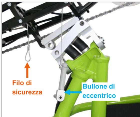
Figura 60: Bocca di aggancio dell'unità motrice sull'albero di aggancio sullo chassis, bullone di eccentrico non ancora inserito
