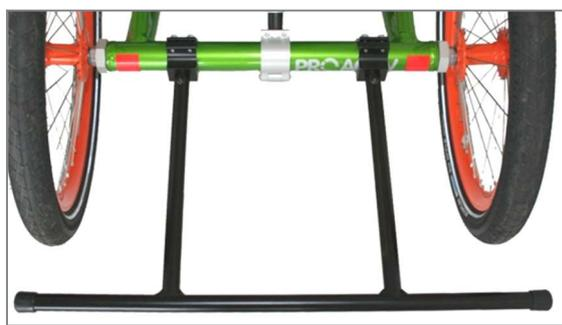
Figura 43: Protezione contro i tamponamenti
