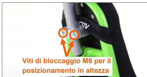
Figura 39: Regolazione in altezza del supporto nuca tramite due viti di bloccaggio M6 sul tubo di supporto del supporto nuca
