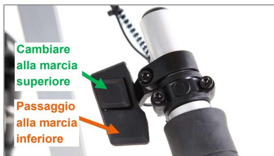
Figura 13: Pulsanti per passare ad una marcia superiore o inferiore
