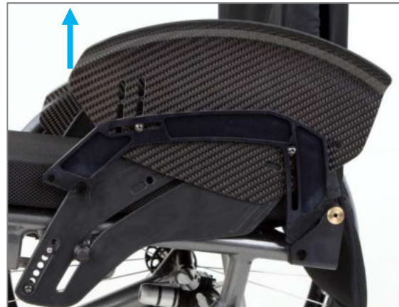
Figura 47: Spondina paraspruzzi tirata anteriormente fuori dalla guida piastra laterale (vista senza ruota motrice)
