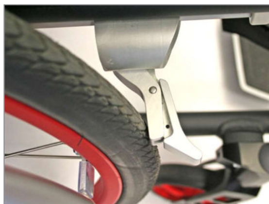
Figura 159: Elemento frenante a contatto con lo pneumatico
