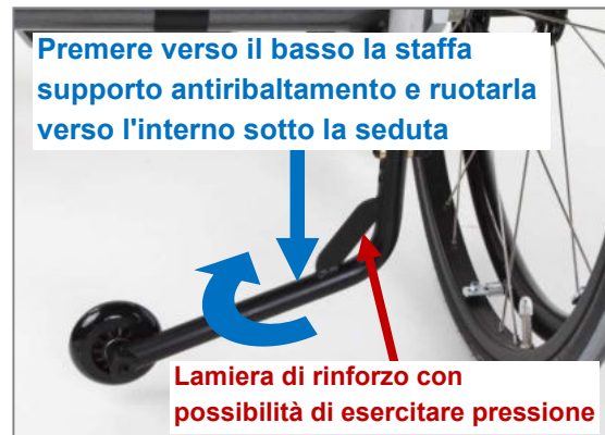
Figura 123: Portare il supporto antiribaltamento in posizione passiva (vista posteriore)
