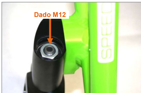
Figura 92: Tappo in alluminio rimosso e dado M12 visibile
