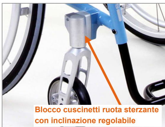
Figura 80: Blocco cuscinetti ruota sterzante con inclinazione regolabile
