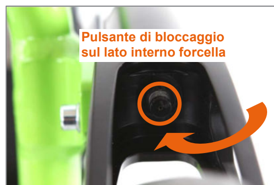
Figura 95: Forcella ruota sterzante con asse flottante e pulsante di bloccaggio
