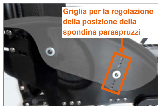
Figura 37: Griglia per la regolazione della posizione della spondina paraspruzzi (vista senza ruota motrice)
