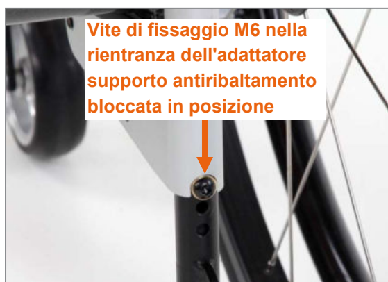
Figura 122: Supporto antiribaltamento bloccata correttamente in posizione
