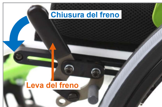
Figura 138: Freno aperto; la chiusura viene effettuata premendo in avanti verso il basso la leva del freno
