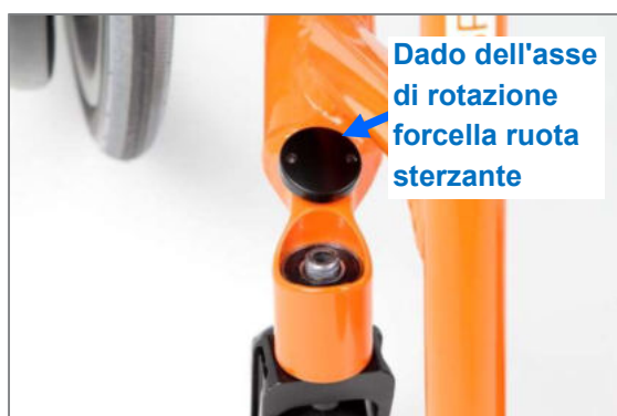
Figura 94: Dado dell'asse di rotazione forcella ruota sterzante completamente rimosso
