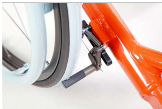
Figura 147: Freno chiuso; il bullone del freno comprime lo pneumatico per circa 4 mm
