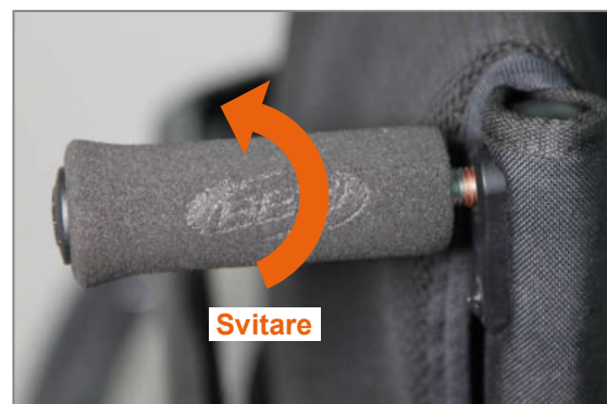
Figura 171: Svitare la maniglia di spinta in orizzontale dal tubo dello schienale
