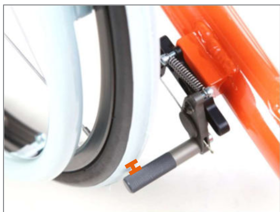
Figura 151: Distanza tra i bulloni del freno e gli pneumatici compresa tra ca. 3 e max. 4 mm con il freno aperto
