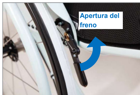
Figura 148: Freno chiuso; l'apertura viene effettuata tirando la leva del freno all'indietro verso l'alto.
