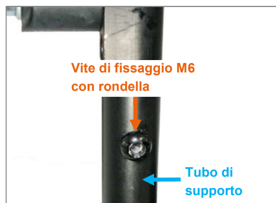
Figura 113: Vite di fissaggio M6 con rondella per la regolazione della lunghezza della gamba
