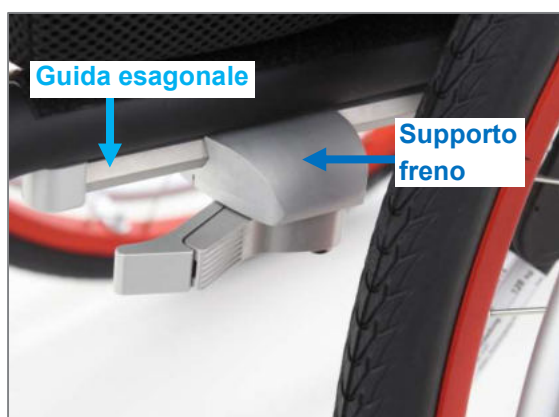
Figura 157: Guida esagonale e supporto freno
