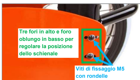
Figura 5: Regolazione della posizione dello schienale tramite i fori nella piastra laterale o nella spondina paraspruzzi
