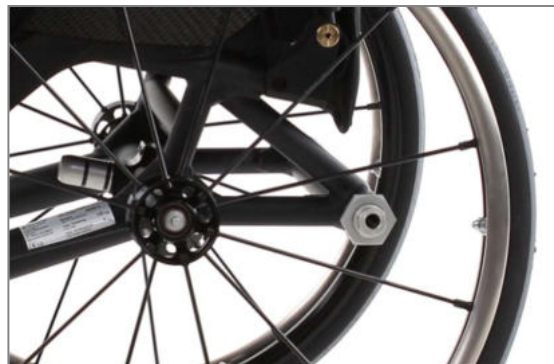
Figura 69: Prolungamento interasse saldato fisso (SPEEDY F2 sovradimensionata)
