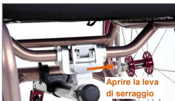
Figura 133: Tirare in avanti la leva di serraggio per aprirla
