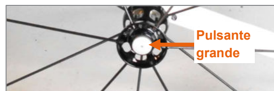
Figura 56: Asse flottante con supporto di comando e pulsante grande
