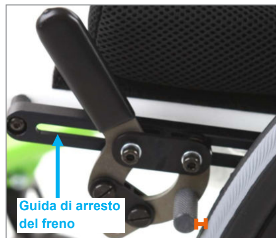
Figura 141: Distanza tra i bulloni del freno e gli pneumatici compresa tra circa 3 e max. 4 mm con il freno aperto
