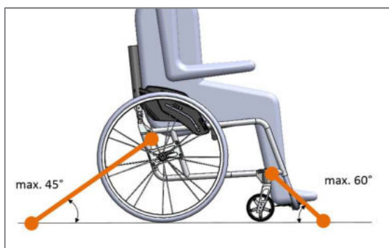
Figura 186: Andamento dei retrattori anteriormente e posteriormente con angolazione di ancoraggio massima e punti di collegamento (vista dal lato)
