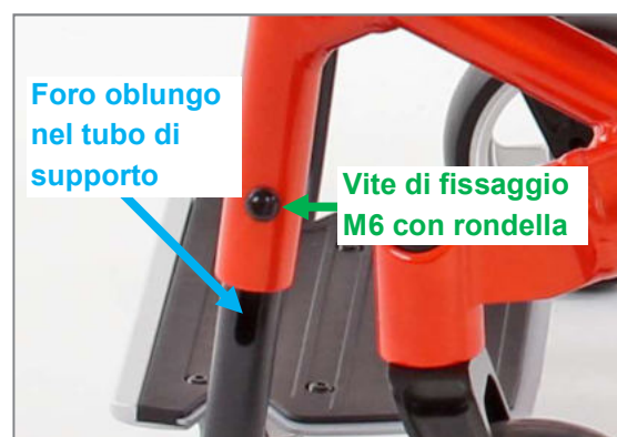
Figura 102: Vite di fissaggio M6 con rondella e foro oblungo nel tubo di supporto poggiatesta per la regolazione della lunghezza della gamba
