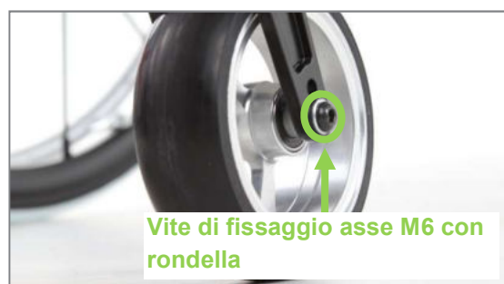
Figura 85: Vite di fissaggio M6 dell'asse ruota sterzante (vista dal lato esterno del prodotto)
