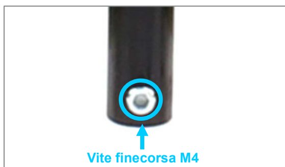
Figura 175: Vite finecorsa inserita sulla maniglia di spinta arretrata
