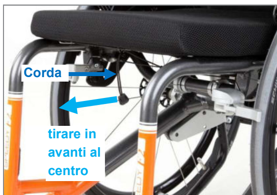
Figura 46: Corda per l'azionamento del bullone di bloccaggio
