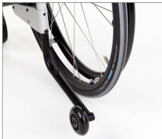
Figura 119: Posizione attiva del supporto antiribaltamento (vista posteriore)
