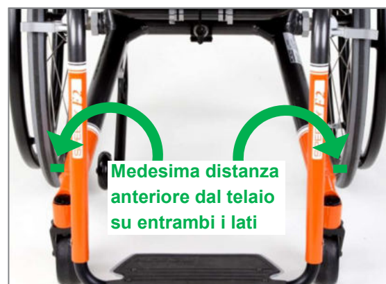
Figura 63: Distanza anteriore dal telaio (SPEEDY F2 sovradimensionata)
