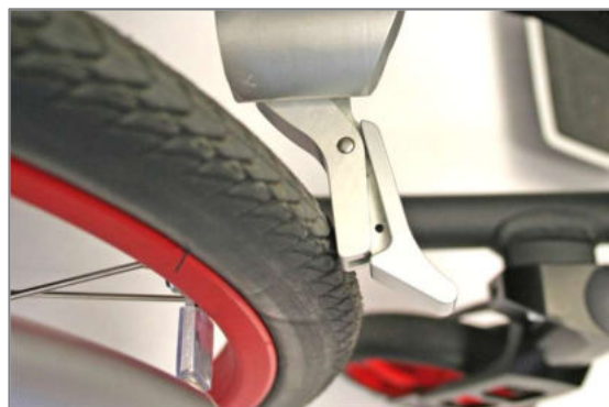
Figura 166: Elemento frenante a contatto con lo pneumatico
