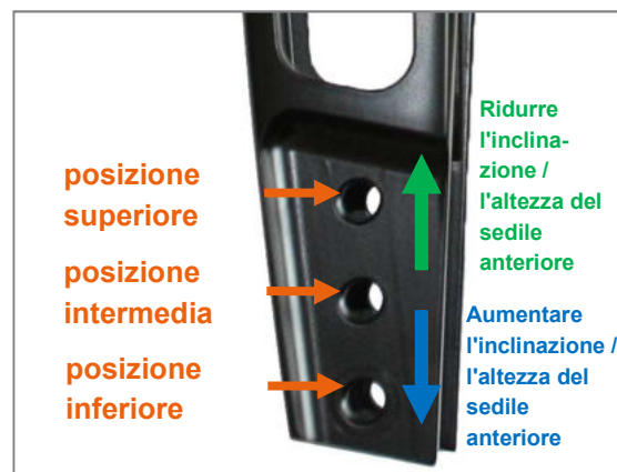
Figura 2: Tre posizioni nella forcella della ruota sterzante per il posizionamento della ruota sterzante ed effetto sull'altezza del sedile anteriore
