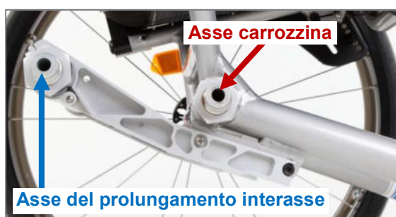
Figura 77: Asse carrozzina e asse del prolungamento interasse (vista dal lato esterno del prodotto senza ruota motrice)
