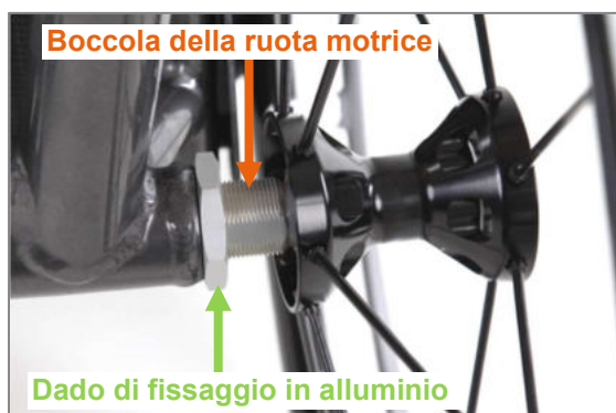
Figura 61: Boccola della ruota motrice e dado di fissaggio in alluminio (vista posteriore)
