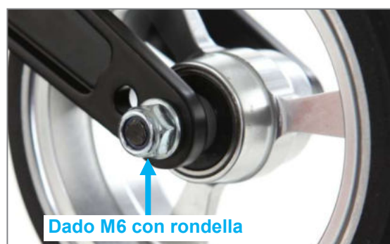
Figura 86: Dado M6 dell'asse ruota sterzante (vista dal lato interno del prodotto)
