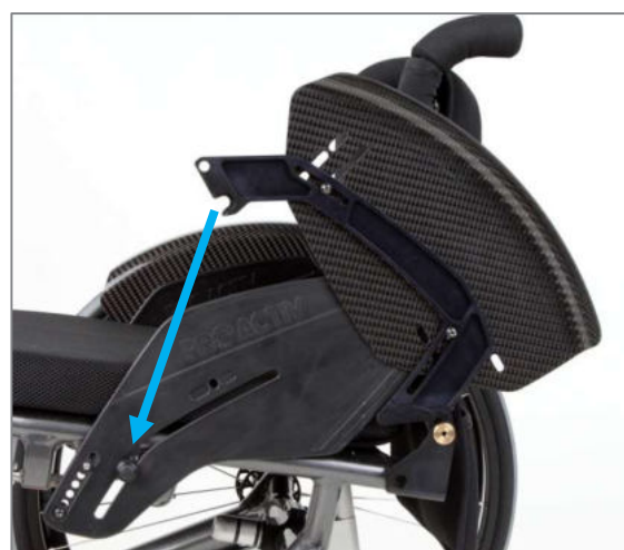
Figura 48: Staffa di sostegno inserita sull'albero snodato schienale (vista senza ruota motrice)
