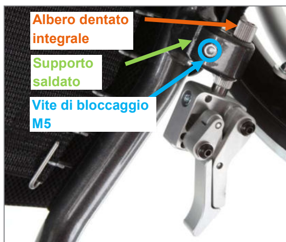
Figura 164: Panoramica delle denominazioni del freno integrale (vista inferiore prodotto)
