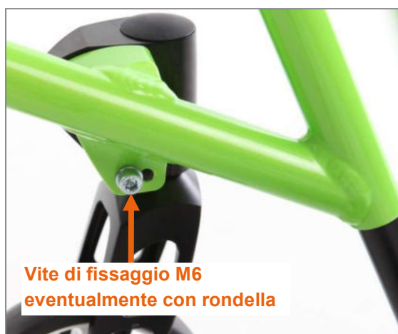
Figura 98: Vite di fissaggio M6 sul lato interno del telaio, rondella presente sui telai a forma di G, ma non sui telai a forma di V
