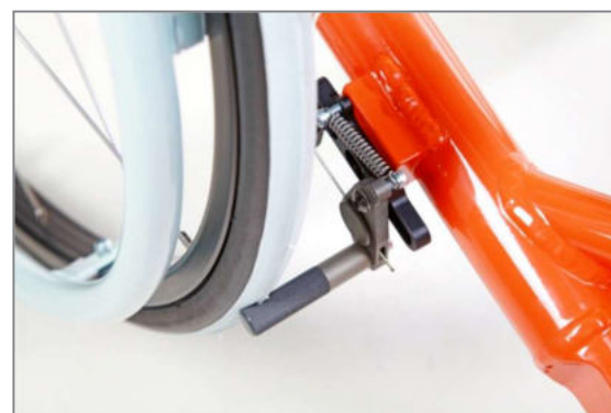
Figura 145: Freno a leve separate con comando a cavo flessibile, unità del freno
