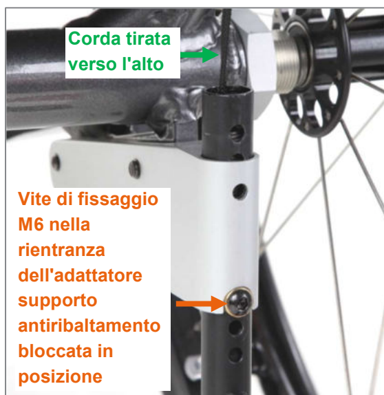
Figura 125: Staffa supporto antiribaltamento inserita nell'adattatore supporto antiribaltamento
