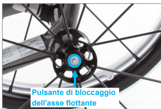
Figura 54: Pulsante di bloccaggio dell'asse flottante al centro dell'asse ruota
