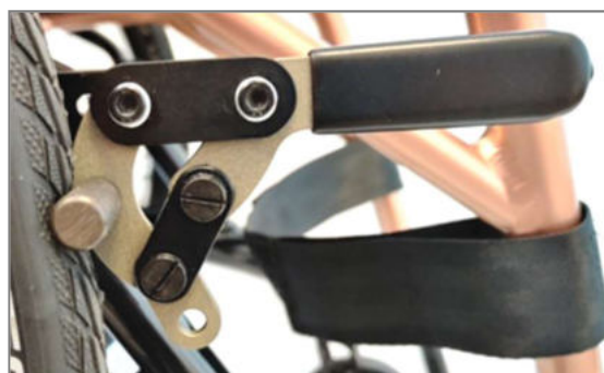
Figura 118: Sistema dei freni a leve separate con leva del freno standard
