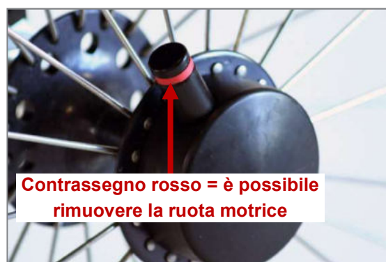
Figura 54: Tetra Clip con asse flottante aperto: è possibile rimuovere la ruota motrice
