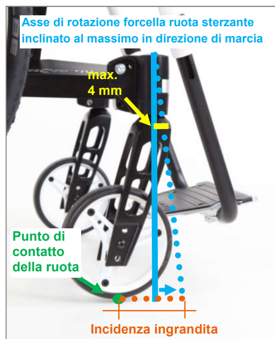
Figura 73: Ingrandimento dell'incidenza tramite inclinazione dell'asse di rotazione della forcella ruota sterzante
