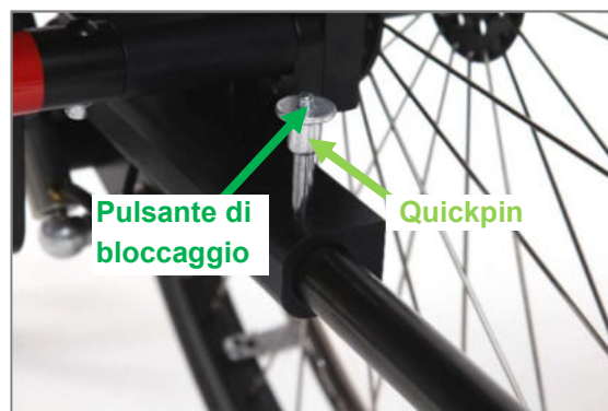
Figura 117: Supporto antiribaltamento con Quickpin estratto quasi completamente (LIFT solid)
