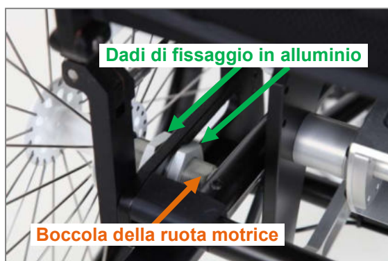
Figura 6: Boccia della ruota motrice e dado di fissaggio in alluminio (vista posteriore)
