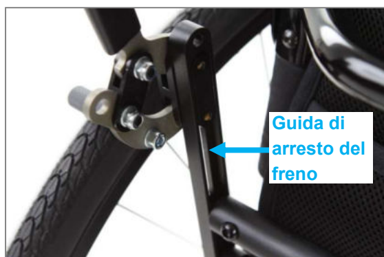
Figura 124: Freno a leve separate (montato dietro nella LIFT solid; vista posteriore)
