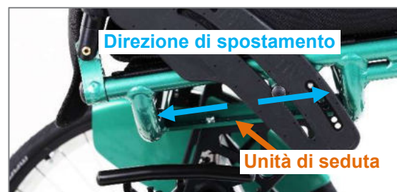
Figura 3: Unità di seduta sulla carrozzina
