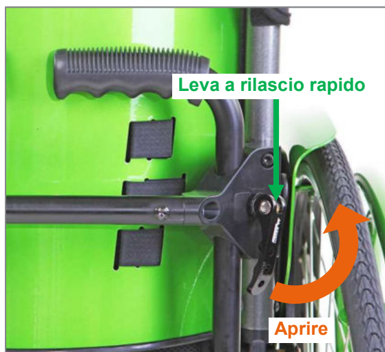
Figura 143: Leva a rilascio rapida chiusa
