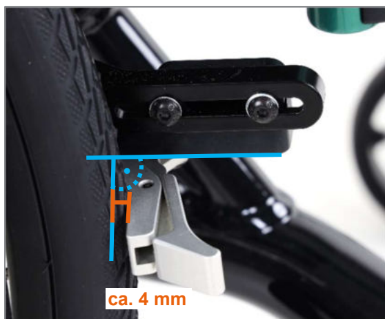
Figura 136: Elemento frenante dopo il posizionamento corretto del freno integrale
