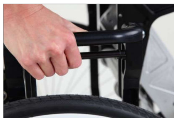
Figura 150: Meccanismo di sblocco meccanico azionato
