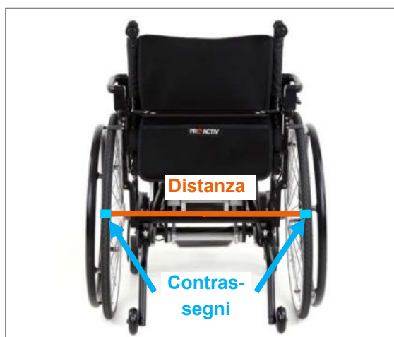
Figura 56: Distanza tra i contrassegni degli pneumatici (ad altezza asse), (vista posteriore; LIFT solid)
