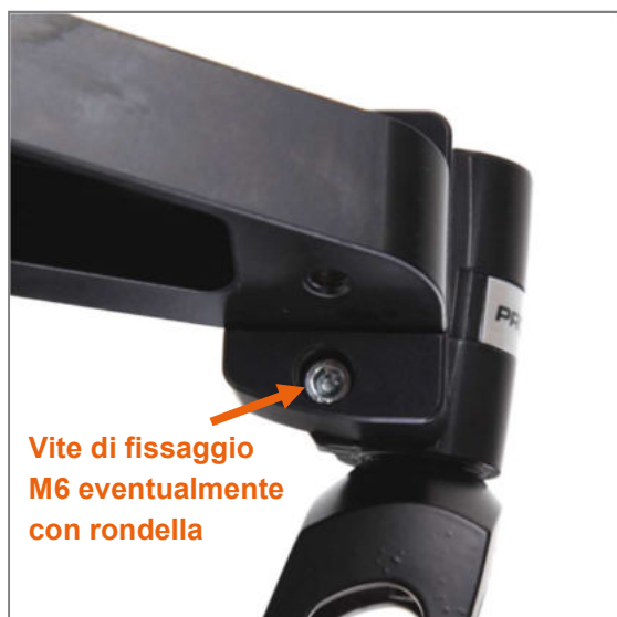
Figura 81: Vite di fissaggio M6 sul lato interno del telaio, rondella presente sui telai a forma di G, ma non sui telai a forma di V
