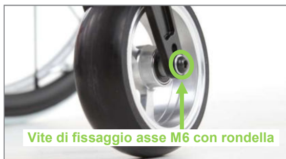
Figura 68: Vite di fissaggio M6 dell'asse ruota sterzante (vista dal lato esterno del prodotto)
