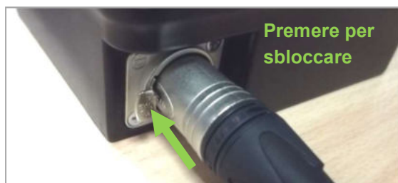
Figura 157: Sblocco della spina del caricabatteria
