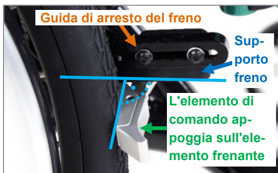
Figura 133: Freno integrale chiuso; elemento frenante in verticale rispetto al supporto freno
