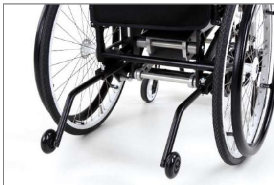
Figura 114: Posizione attiva del supporto antiribaltamento (vista posteriore)
