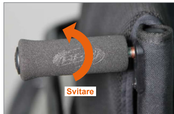
Figura 140: Svitare la maniglia di spinta in orizzontale dal tubo dello schienale
