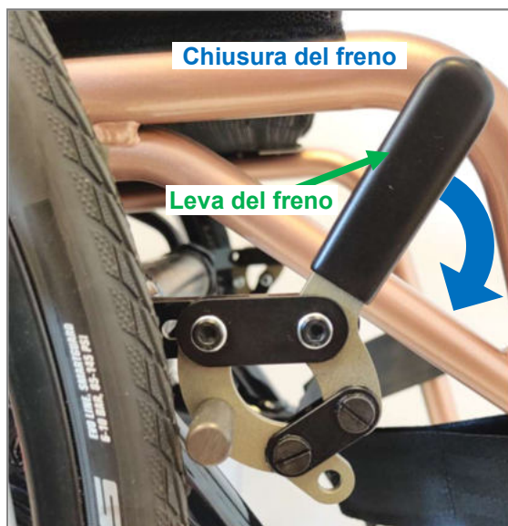
Figura 119: Freno aperto; la chiusura viene effettuata premendo in avanti verso il basso la leva del freno
