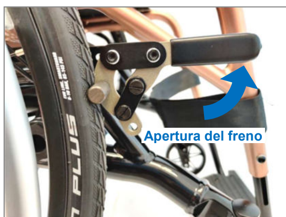
Figura 120: Freno chiuso; l'apertura viene effettuata tirando la leva del freno all'indietro verso l'alto.
