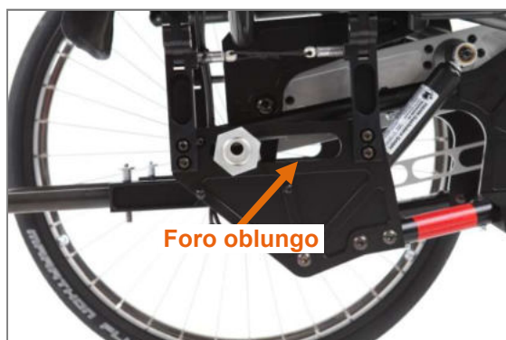
Figura 5: Piastra della ruota con boccia della ruota motrice
