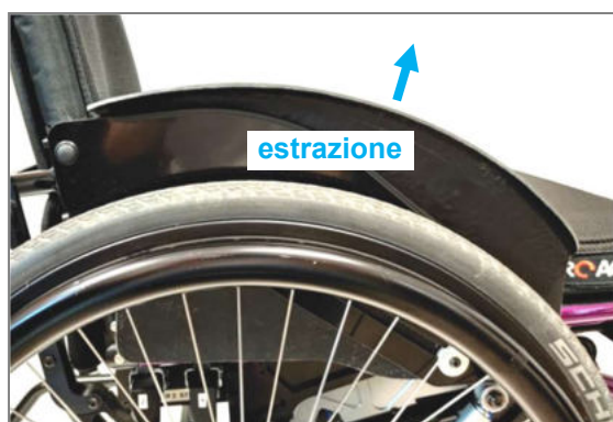
Figura 49: Rimozione spondina paraspruzzi
