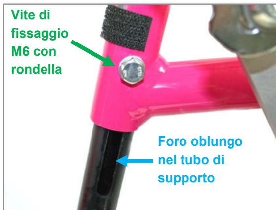
Figura 100: Vite di fissaggio M6 con rondella e foro oblungo nel tubo di supporto poggiatesti per la regolazione della lunghezza della gamba
