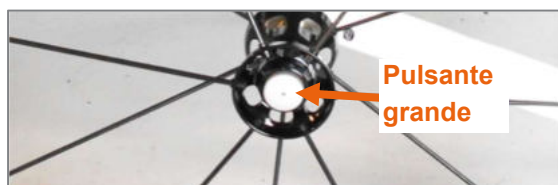
Figura 52: Asse flottante con supporto di comando e pulsante grande
