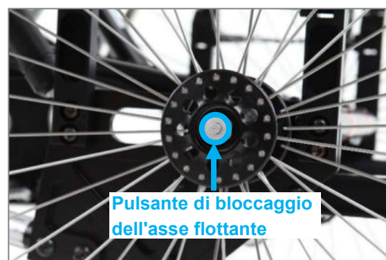
Figura 50: Pulsante di bloccaggio dell'asse flottante al centro dell'asse ruota
