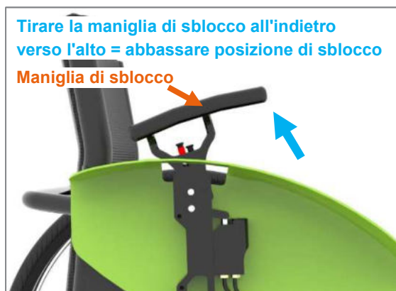
Figura 148: Abbassare la maniglia in posizione di sblocco
