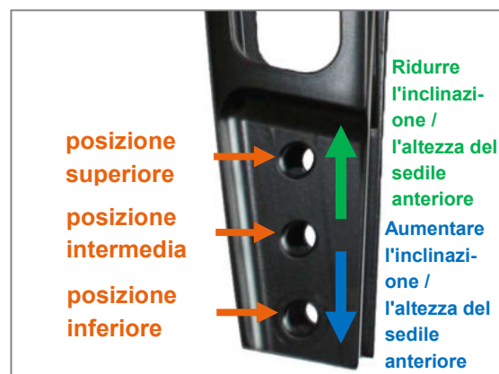
Figura 1: Tre posizioni nella forcella della ruota sterzante per il posizionamento della ruota sterzante ed effetto sull'altezza del sedile anteriore
