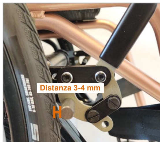
Figura 125: Distanza tra il bullone del freno e gli pneumatici compresa tra circa 3 e max. 4 mm con il freno aperto (montato davanti)
