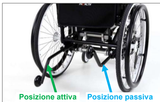
Figura 116: Posizione attiva e passiva del supporto antiribaltamento (vista posteriore)
