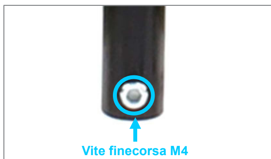
Figura 144: Vite finecorsa M4 inserita in basso su una maniglia di spinta arretrata
