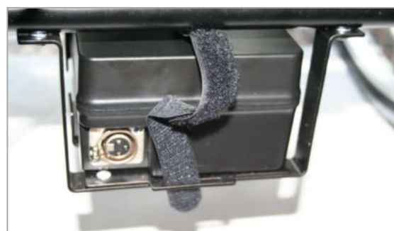
Figura 161: Allentare il nastro in velcro, fase 2
