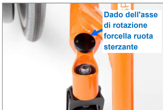
Figura 77: Dado dell'asse di rotazione forcella ruota sterzante completamente rimosso
