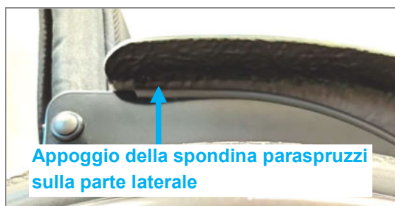
Figura 48: La spondina paraspruzzi appoggia sulla parte laterale (vista di lato)
