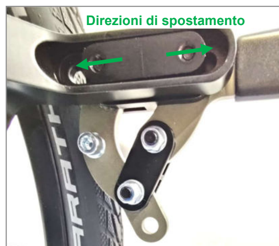
Figura 121: Direzioni di spostamento (LIFT activ; vista dal lato interno della carrozzina)
