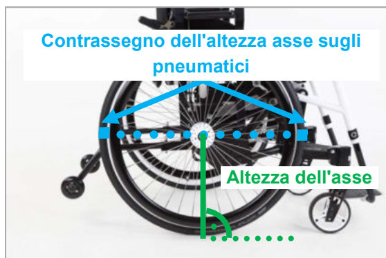
Figura 55: Contrassegno dell'altezza asse anteriormente e posteriormente su entrambi gli pneumatici (LIFT solid)
