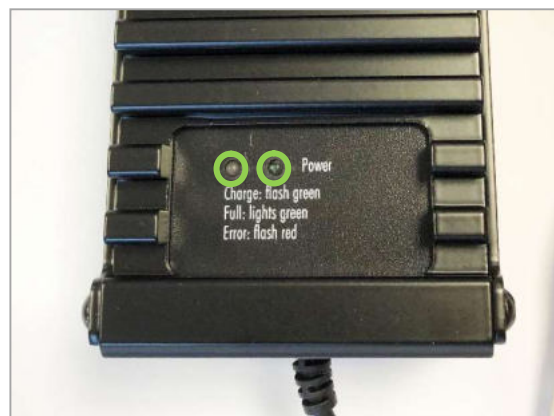
Figura 156: Indicatore luminoso del caricabatteria
