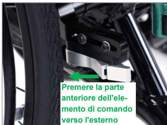
Figura 132: Freno integrale aperto; la chiusura viene effettuata premendo verso il basso l'elemento di comando
