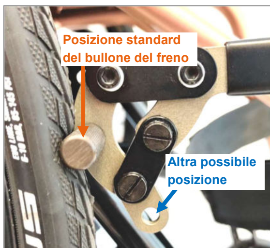
Figura 127: Posizioni del bullone del freno (montato davanti)
