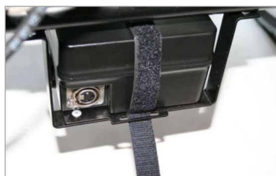
Figura 160: Allentare il nastro in velcro, fase 1
