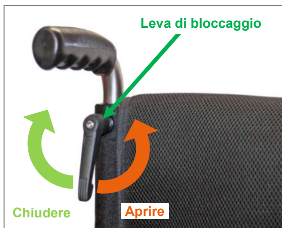
Figura 141: Maniglia di spinta di sicurezza con regolazione continua in altezza
