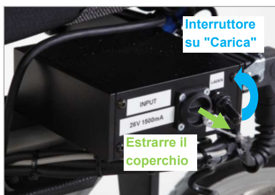
Figura 158: Predisposizione per ricaricare sul retro della carrozzina
