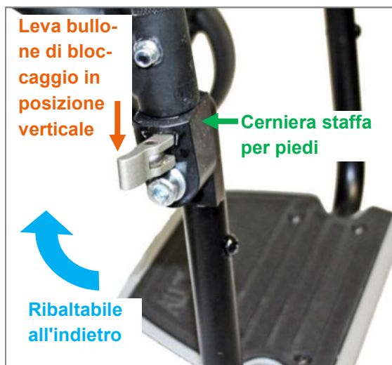
Figura 87: Leva bullone di bloccaggio in posizione verticali per la cerniera staffa per piedi, aperta
