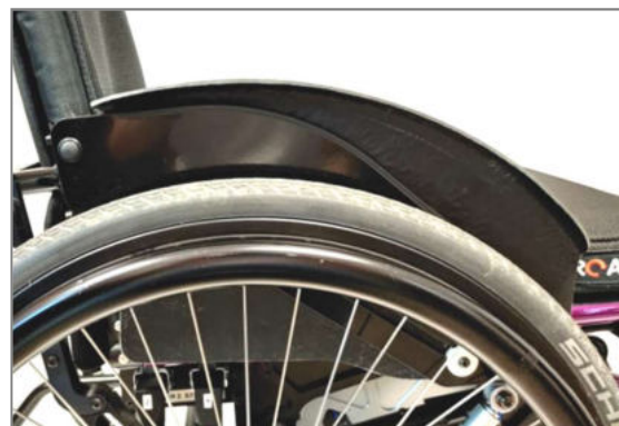
Figura 44: Spondina paraspruzzi applicata sul prodotto (vista con ruota motrice)
