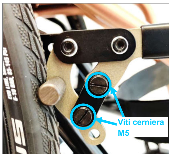
Figura 126: Viti cerniera M5 per la regolazione della forza di azionamento della leva del freno (montate davanti)
