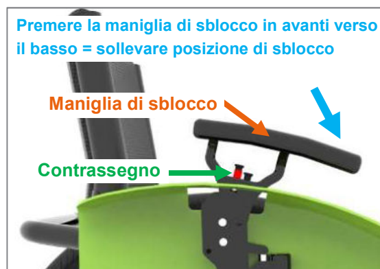
Figura 147: Sollevare la maniglia di sblocco in posizione di sblocco
