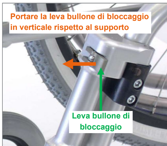
Figura 103: Posizionare in verticale la leva bullone di bloccaggio per la rimozione del poggiatesta Swing away
