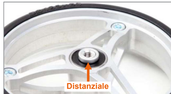
Figura 67: Distanziale sulla ruota sterzante
