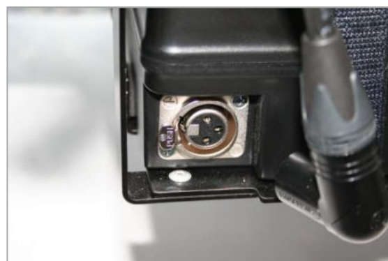
Figura 159: Collegamento a spina allentato
