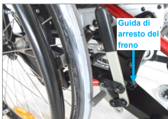
Figura 123: Freno a leve separate (montato basso); leva del freno lunga; LIFT solid
