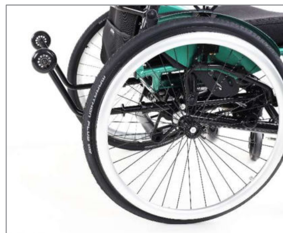
Figura 109: Posizione passiva del supporto antiribaltamento (vista laterale)
