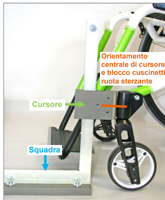
Figura 79: Verifica della regolazione degli assi di rotazione della forcella della ruota sterzante
