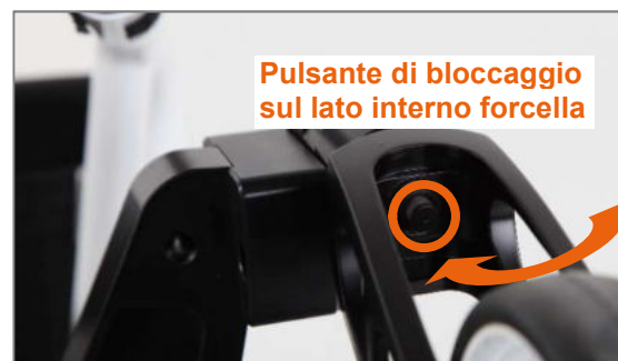
Figura 78: Forcella ruota sterzante con asse flottante e pulsante di bloccaggio
