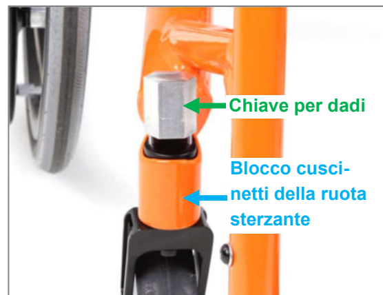
Figura 76: Allentamento del dado dell'asse di rotazione della forcella della ruota sterzante con la chiave per dadi
