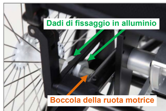
Figura 57: Boccola della ruota motrice e dado di fissaggio in alluminio (vista posteriore; LIFT solid)
