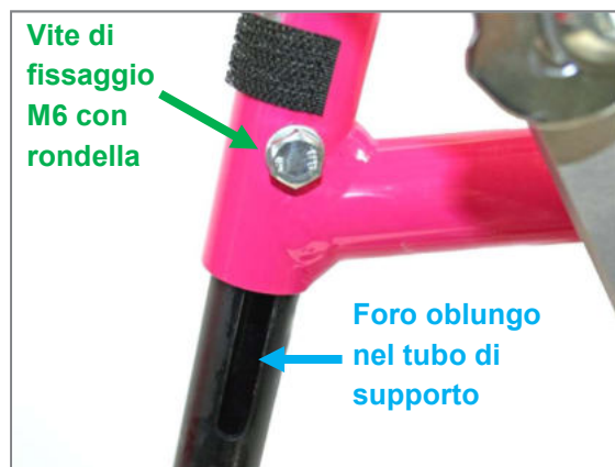
Figura 97: Vite di fissaggio M6 con rondella e foro oblungo nel tubo di supporto poggiatepidi per la regolazione della lunghezza della gamba
