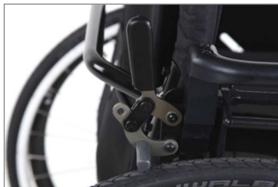
Figura 128: Freno a leve separate montato dietro (vista laterale)
