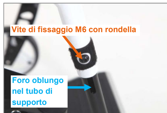
Figura 85: Vite di fissaggio M6 con rondella e foro oblungo nel tubo di supporto poggiapiedi per la regolazione della lunghezza della gamba
