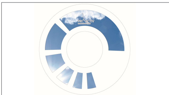
Figura 86: Copriraggi per ridurre al minimo il pericolo di incastro di mani e dita
