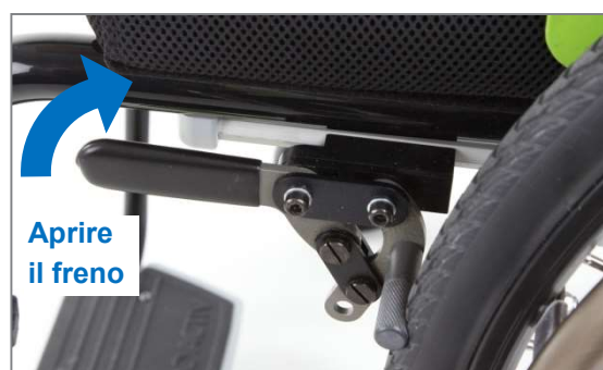
Figura 145: Freno chiuso; l'apertura viene effettuata tirando la leva del freno all'indietro verso l'alto.
