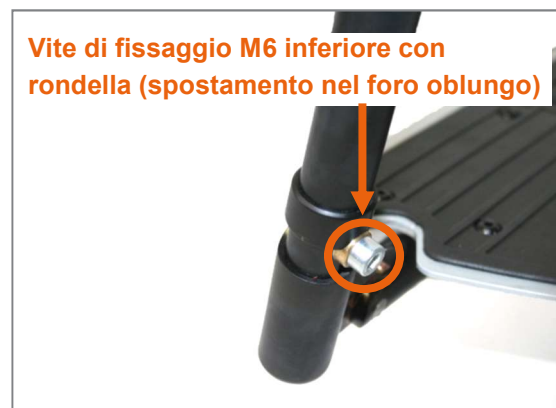
Figura 116: La vite di fissaggio M6 inferiore (apertura della chiave di 5 mm) può essere posizionata nel foro oblunco
