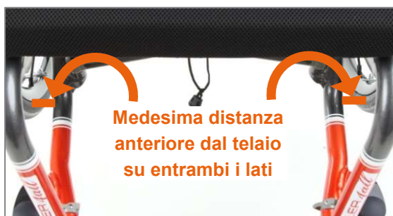
Figura 75: Distanza anteriore dal telaio
