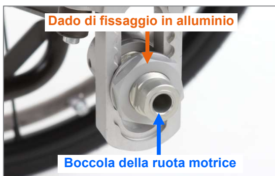
Figura 7: Dado di fissaggio in alluminio e boccola della ruota motrice (vista dal lato esterno del prodotto)
