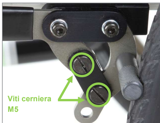
Figura 148: Viti cerniera M5 per la regolazione della forza di azionamento della leva del freno
