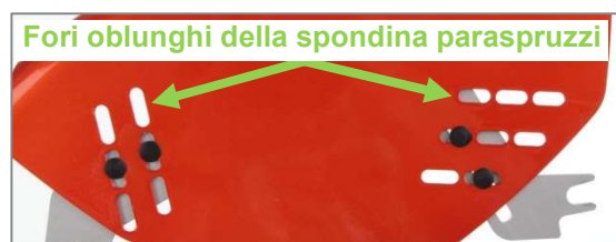
Figura 58: Fori oblunghi della spondina paraspruzzi
