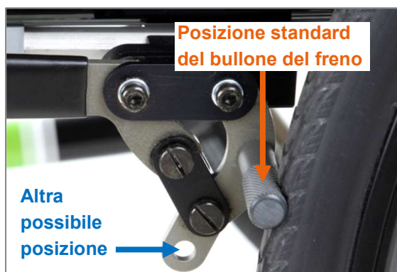
Figura 149: Posizioni del bullone del freno
