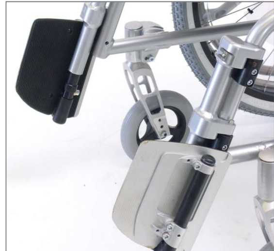
Figura 125: Entrambe le parti del poggiapiedi sollevate verso l'alto e ruotate all'esterno
