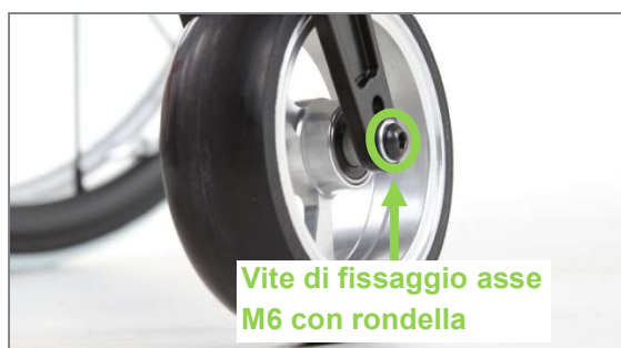
Figura 90: Vite di fissaggio M6 dell'asse ruota sterzante (vista dal lato esterno del prodotto)
