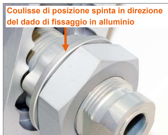
Figura 10: Dado di fissaggio in alluminio allentato e coulisse di posizione spinta in direzione del dado di fissaggio in alluminio (vista dal lato esterno del prodotto)
