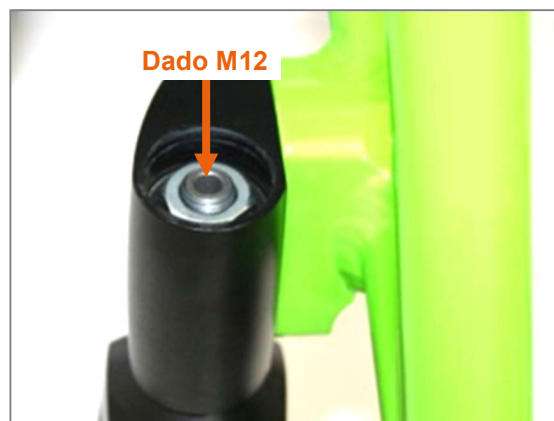
Figura 97: Tappo in alluminio rimosso e dado M12 visibile
