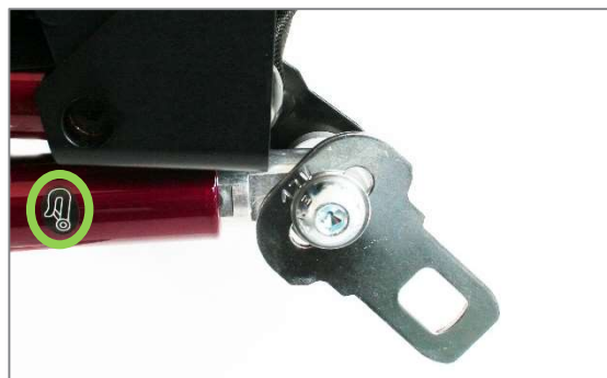
Figura 176: Collegamento del sistema di bloccaggio sul telaio posteriore con linguette fibbia per il retrattore posteriore e cinghia di sicurezza (vista laterale)
