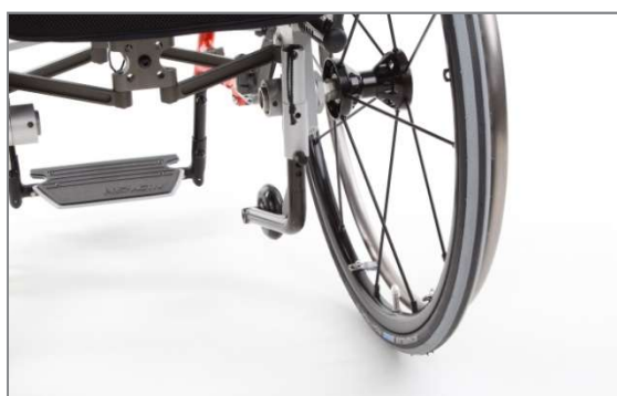
Figura 131: Posizione passiva del supporto antiribaltamento (vista posteriore)
