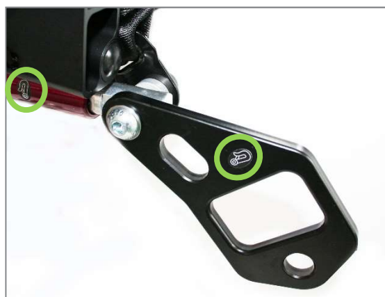
Figura 177: Collegamento del sistema di bloccaggio sul telaio posteriore con occhiello per cinghia per il retrattore posteriore e cinghia di sicurezza
