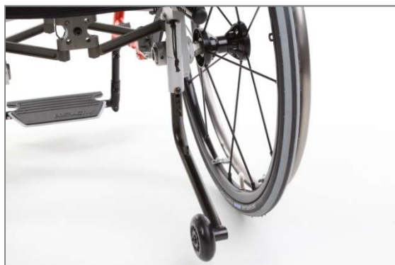
Figura 130: Posizione attiva del supporto antiribaltamento (vista posteriore)
