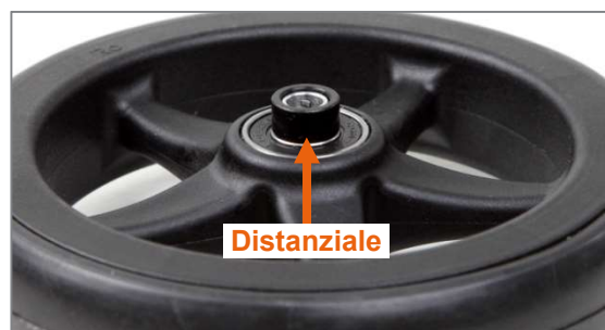
Figura 93: Distanziale sulla ruota sterzante
