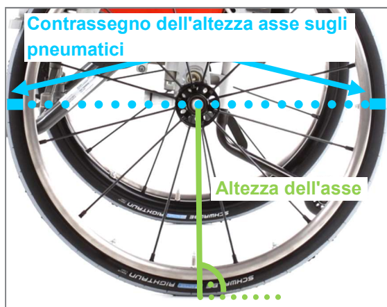
Figura 72: Contrassegno dell'altezza asse anteriormente e posteriormente su entrambi gli pneumatici
