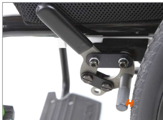
Figura 147: Distanza tra i bulloni del freno e gli pneumatici compresa tra circa 3 e max. 4 mm con il freno aperto
