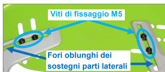
Figura 57: Viti di fissaggio M5 e fori oblunghi dei sostegni spondina paraspruzzi
