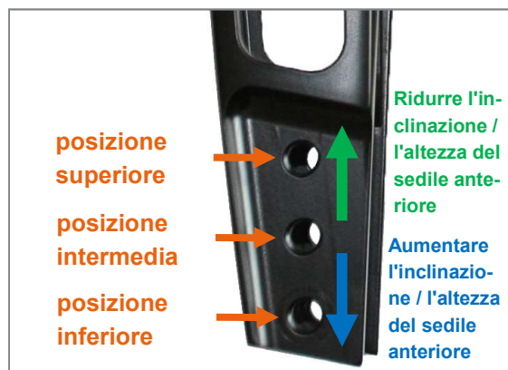
Figura 12: Tre posizioni nella forcella della ruota sterzante per il posizionamento della ruota sterzante ed effetto sull'altezza del sedile anteriore
