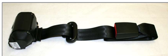
Figura 173: Cinghia trasversale per spalle automatica con rinvio e fibbia di chiusura
