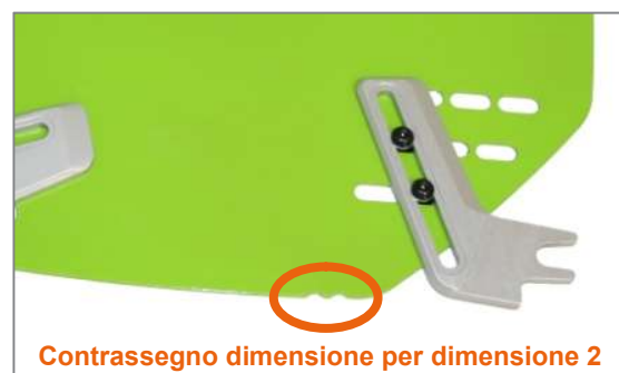
Figura 66: Contrassegno dimensione sulla spondina paraspruzzi
