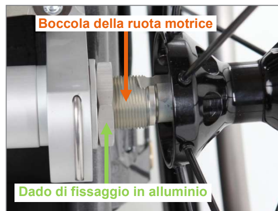
Figura 74: Boccola della ruota motrice e dado di fissaggio in alluminio (vista dal basso)
