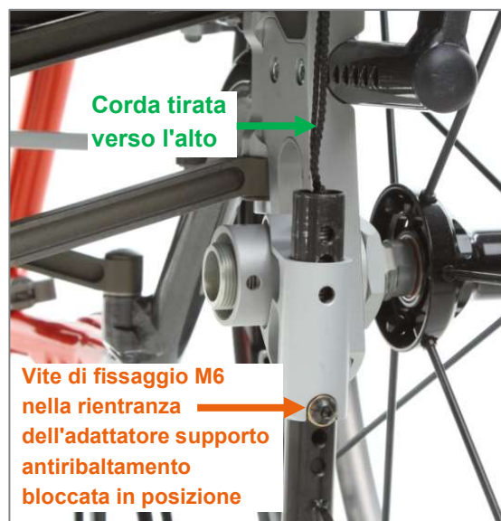
Figura 136: Staffa supporto antiribaltamento inserita nell'adattatore supporto antiribaltamento
