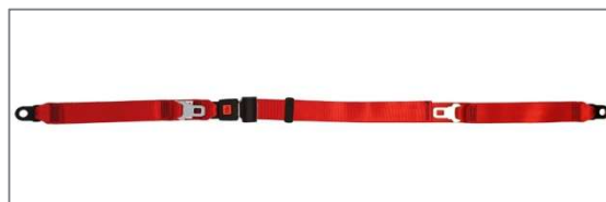
Figura 172: Cinghia di sicurezza con fibbia di chiusura, cerniere di fissaggio per il collegamento agli elementi di bloccaggio e due linguette fibbia per il fissaggio a scelta della cinghia trasversale per spalle
