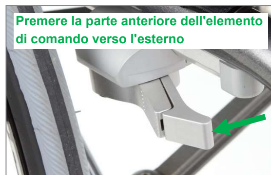
Figura 151: Freno integrale aperto; la chiusura viene effettuata premendo verso il basso l'elemento di comando
