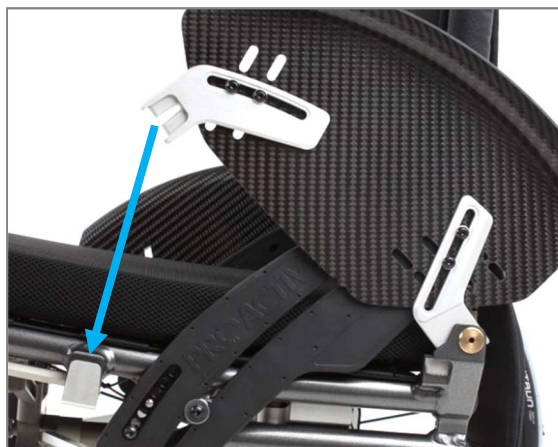
Figura 55: Sostegno parte laterale posteriore inserito sull'albero snodato schienale (vista senza ruota motrice)
