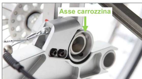
Figura 82: Asse carrozzina (vista dal lato interno prodotto)
