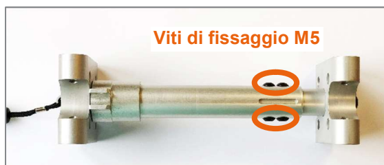
Figura 21: Viti di fissaggio M5 della parte centrale del meccanismo di piegatura (parte centrale del meccanismo di piegatura mostrata come pezzo unico per una migliore visualizzazione, vista laterale)
