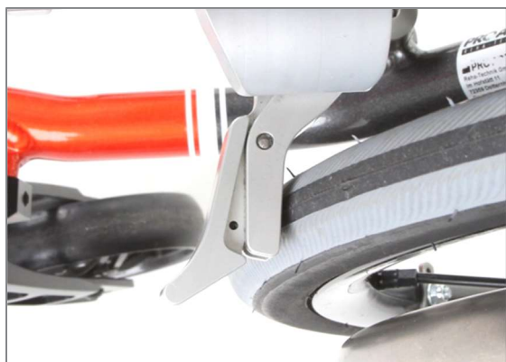
Figura 156: Elemento frenante a contatto con lo pneumatico
