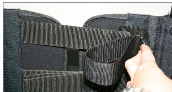
Figura 30: Occhiello di tensionamento completamente aperto
