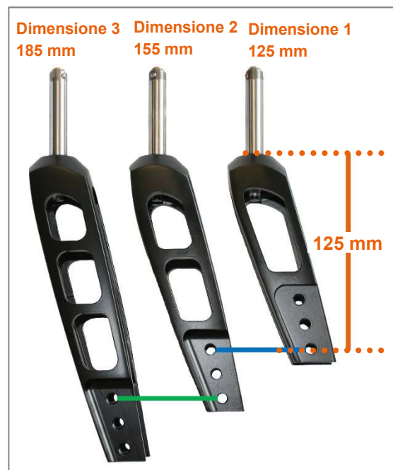
Figura 13: Dimensioni forcella della ruota sterzante con contrassegno delle stesse regolazioni dell'altezza del sedile per diverse dimensioni forcella della ruota sterzante
