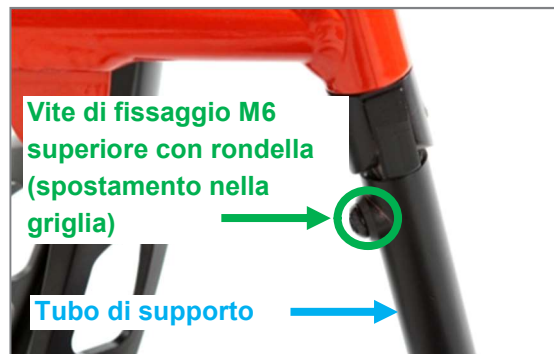
Figura 122: La vite di fissaggio M6 superiore (apertura della chiave di 4 mm) può essere posizionata nella griglia
