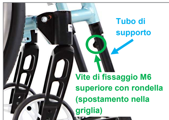
Figura 108: La vite di fissaggio M6 superiore può essere posizionata nella griglia
