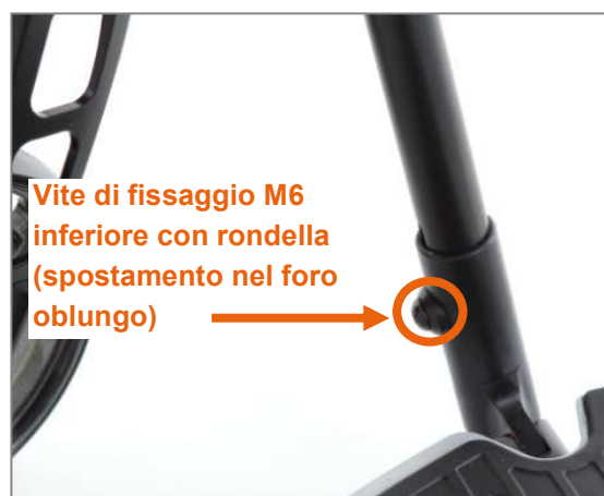
Figura 109: La vite di fissaggio M6 inferiore può essere posizionata nel foro oblungo
