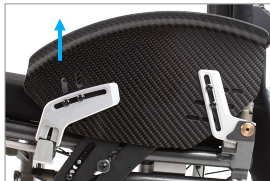
Figura 54: Spondina paraspruzzi tirata in avanti fuori dal "sostegno parte laterale avvitato" (vista senza ruota motrice)
