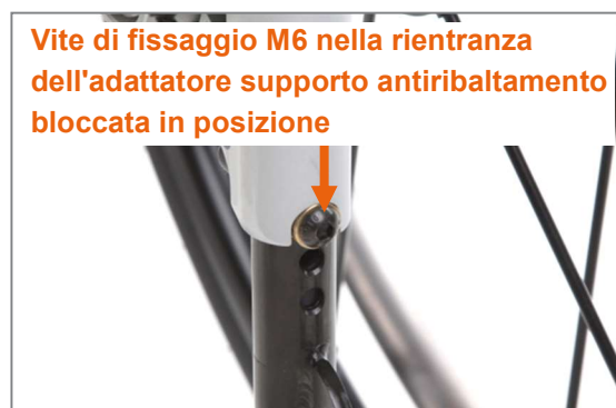
Figura 133: Supporto antiribaltamento bloccata correttamente in posizione
