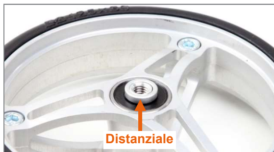
Figura 89: Distanziale sulla ruota sterzante
