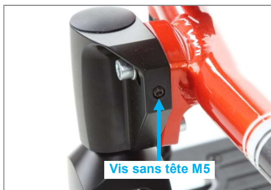
Figure 94 : Vis sans tête M5
