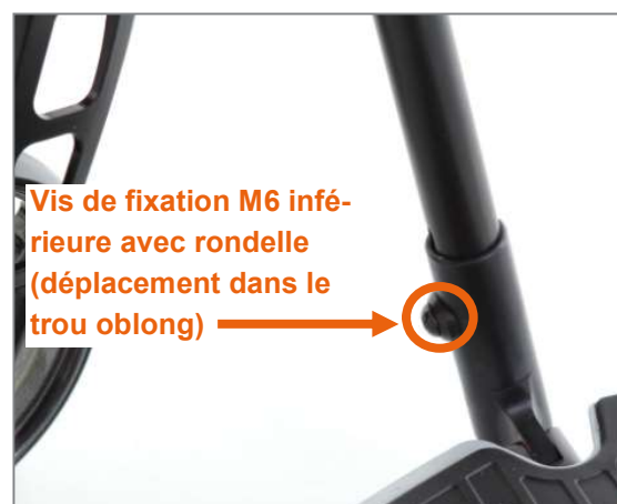
Figure 103 : La vis de fixation M6 inférieure peut être positionnée dans le trou oblong
