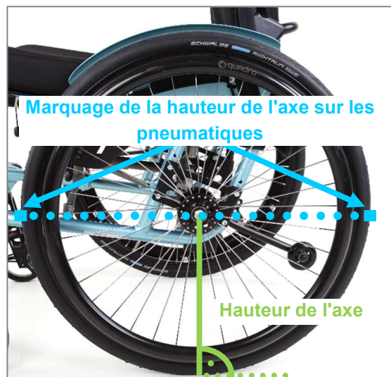
Figure 72 : Marquage de la hauteur de l'axe à l'avant et à l'arrière sur les deux pneumatiques
