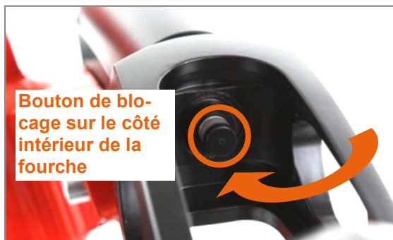
Figure 92 : Fourche de roue avant avec axe à démontage rapide et bouton de blocage
