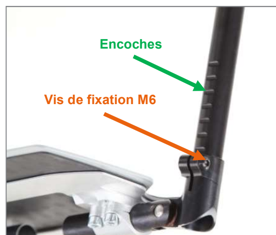
Figure 113 : Encoches et vis de fixation M6 pour le réglage des longueurs de la potence (vue arrière)
