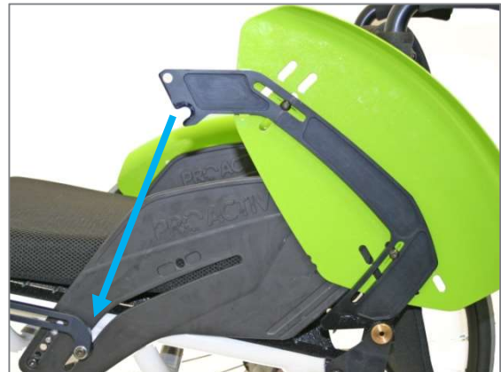
Figure 60 : Étrier de prise inséré sur l'arbre à cardan de dossier (vue sans roue d'entraînement)
