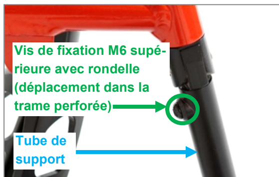
Figure 109 : La vis de fixation M6 supérieure (clé de 4 mm) peut être positionnée dans la trame perforée
