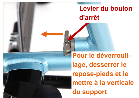
Figure 98 : Levier de l'axe de blocage en position standard, repose-pieds verrouillé ; pour retirer le repose-pieds, mettre le levier de l'axe de blocage à la verticale
