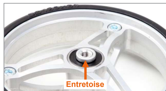
Figure 83 : Entretoise sur la roue avant
