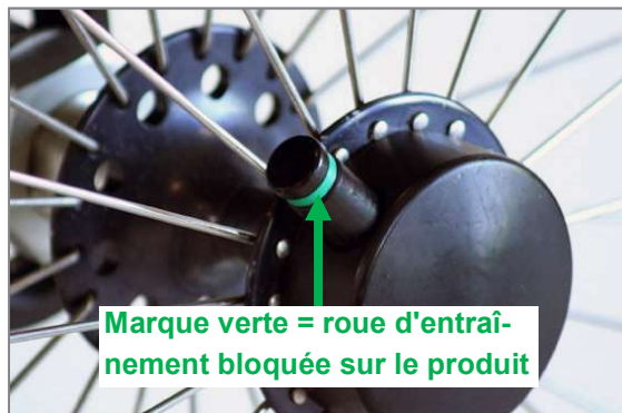
Figure 69 : Tetra-Clip avec axe de démontage rapide bloqué
