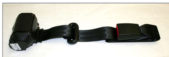
Figure 154 : Ceinture oblique d'épaule automatique avec renvoi et fermeture
