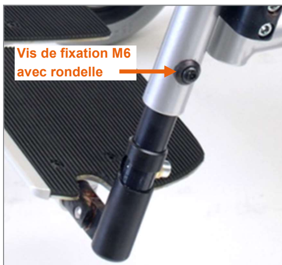
Figure 122 : Vis de fixation M6 avec rondelle pour le réglage de la longueur de la potence
