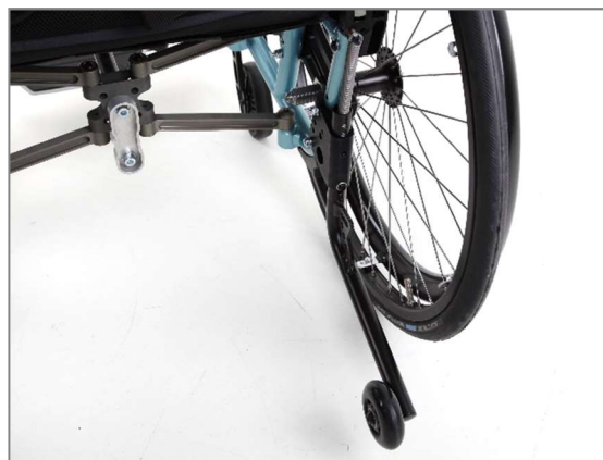
Figure 124 : Position de service des roulettes anti-bascule (vue arrière)
