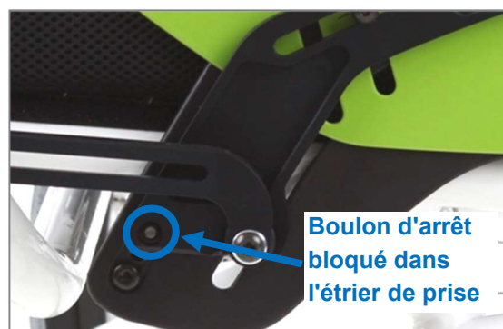
Figure 56 : Boulon d'arrêt bloqué dans l'étrier de prise du protège-vêtements (vue avec protège-vêtements)
