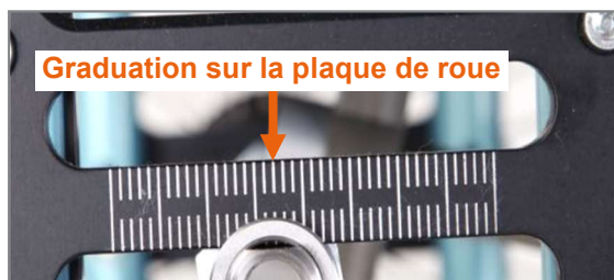
Figure 24 : Graduation sur la plaque de roue
