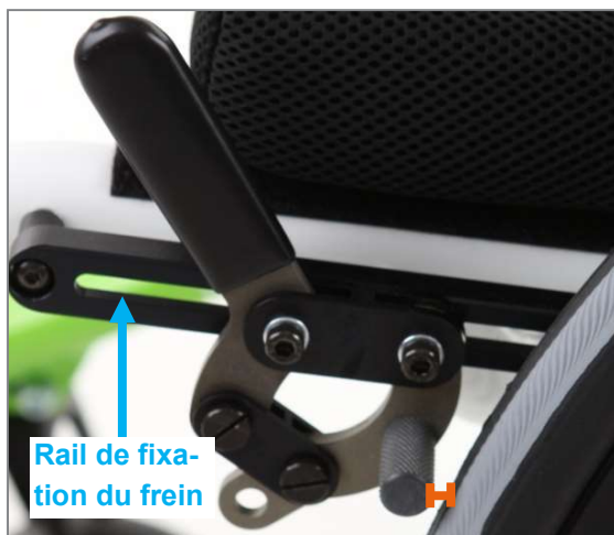
Figure 138 : Écart entre les patins de frein et les pneus d'env. 3 mm à 4 mm maximum lorsque le frein est ouvert
