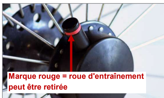
Figure 70 : Tetra-Clip avec axe de démontage rapide ouvert, la roue d'entraînement peut être retirée
