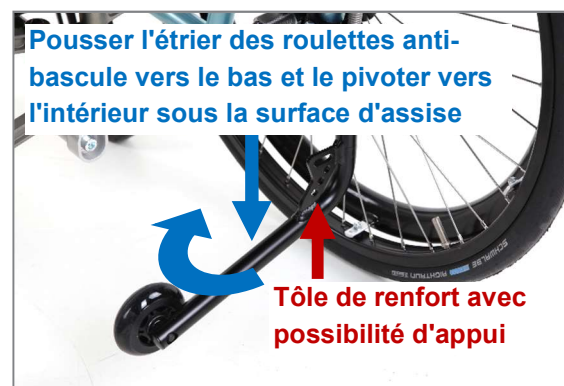
Figure 128 : Mettre les roulettes anti-bascule en position passive (vue arrière)
