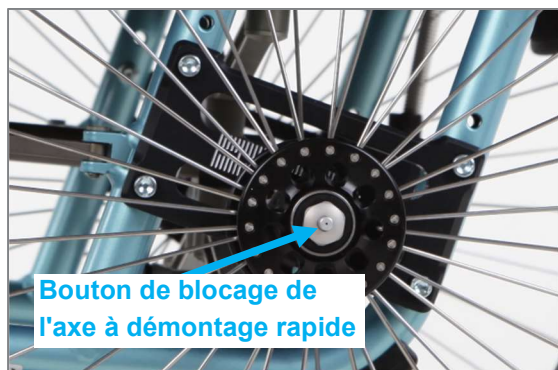
Figure 66 : Bouton de blocage de l'axe à démontage rapide au centre de l'axe de roue
