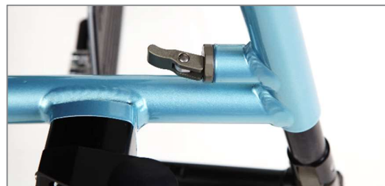
Figure 99 : Levier de l'axe de blocage desserré et mis à la verticale du support pour retirer le repose-pieds
