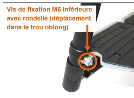
Figure 110 : La vis de fixation M6 inférieure (clé de 5 mm) peut être positionnée dans le trou oblong
