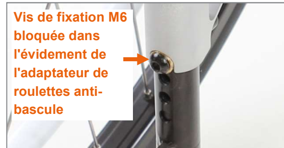
Figure 127 : Roulettes anti-bascule enclenchées correctement
