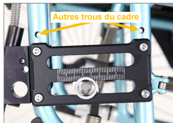
Figure 15 : Trous du cadre (vue du côté extérieur du produit, roue d'entraînement enlevée)
