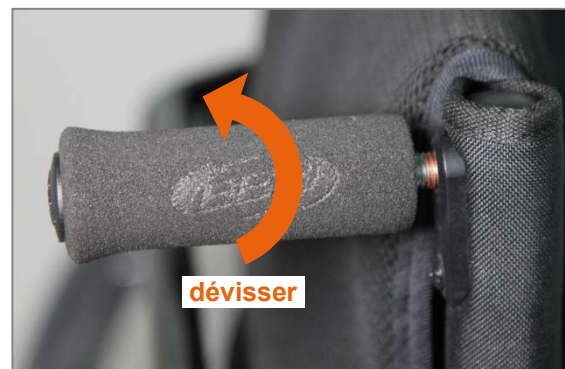
Figure 146 : Dévisser la poignée de poussée horizontalement du tube dorsal
