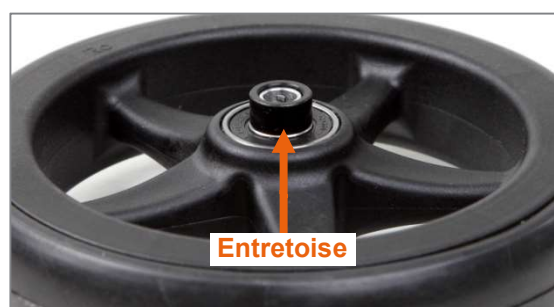
Figure 87 : Entretoise sur la roue avant
