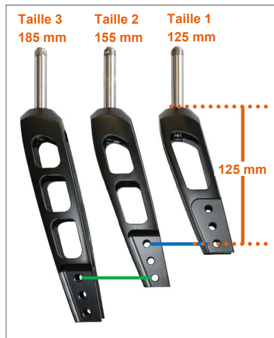
Figure 19 : Tailles de fourche de roue avant avec identification des réglages identiques de hauteur d'assise pour les différentes tailles de fourche de roue avant
