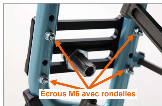
Figure 13 : Écrous de fixation M6 de la plaque de roue (vue du côté intérieur du produit, roue d'entraînement enlevée)
