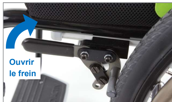
Figure 136 : Frein fermé, l'ouverture s'effectue en tirant le levier de frein vers l'arrière en haut
