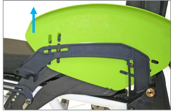
Figure 59 : Protège-vêtements tiré vers l'avant en dehors du guidage de tôle latérale (vue sans roue d'entraînement)
