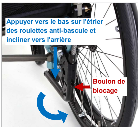
Figure 126 : Mettre les roulettes anti-bascule en position de service (vue arrière)
