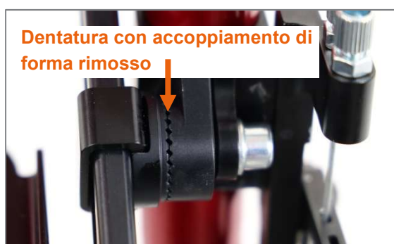
Figura 18: Dentatura sul dispositivo di serraggio del poggiatesta, accoppiamento di forma rimosso
