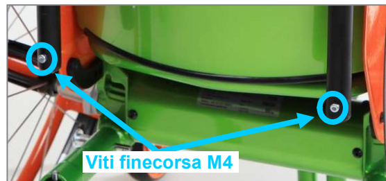
Figura 72: Viti finecorsa M4 inserite in basso sulle maniglie di spinta arretrate
