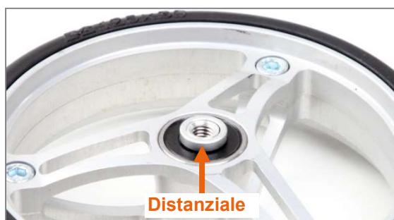
Figura 40: Distanziale sulla ruota sterzante
