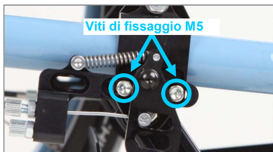
Figura 61: Viti di fissaggio M5
