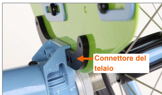
Figura 22: Connettore del telaio sulla spondina paraspruzzi
