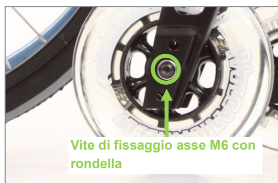
Figura 41: Vite di fissaggio M6 dell'asse ruota sterzante (vista dal lato esterno del prodotto)
