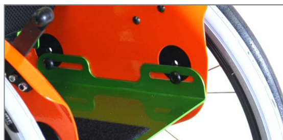
Figura 3: Piastra di seduta in posizione inferiore, fori oblunghi in alto
