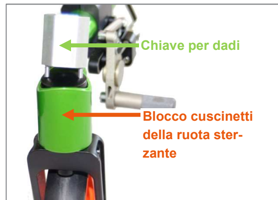
Figura 46: Allentamento del dado dell'asse di rotazione della forcella della ruota sterzante con la chiave per dadi
