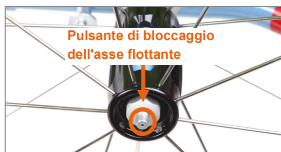
Figura 24: Pulsante di bloccaggio dell'asse flottante al centro dell'asse ruota
