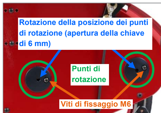
Figura 1: Regolazione delle altezze del sedile con ausilio dei punti di rotazione
