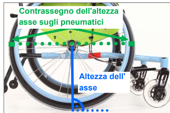
Figura 27: Contrassegno dell'altezza asse anteriormente e posteriormente su entrambi gli pneumatici
