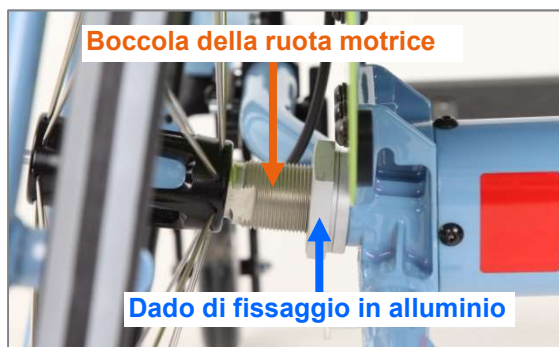
Figura 29: Boccola della ruota motrice e dado di fissaggio in alluminio (vista posteriore)
