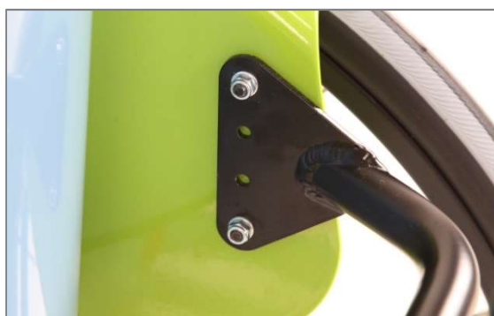
Figura 14: Collegamento della barra posteriore trasversale per la LITTY 4all
