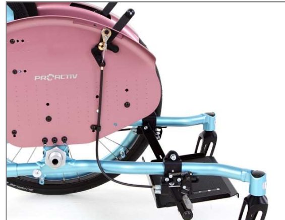
Figura 60: Sistema frenante a leve separate con comando dei freni integrato in alto nella spondina paraspruzzi
