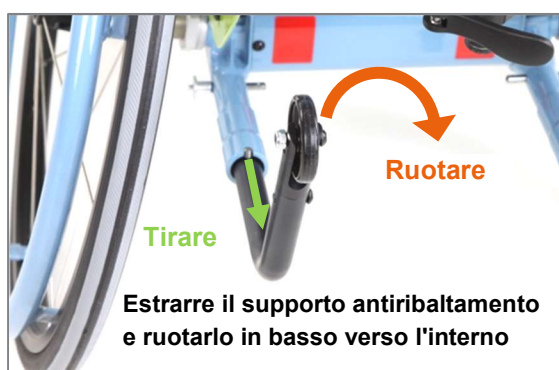
Figura 53: Portare il supporto antiribaltamento dalla posizione attiva a quella passiva (vista posteriore)
