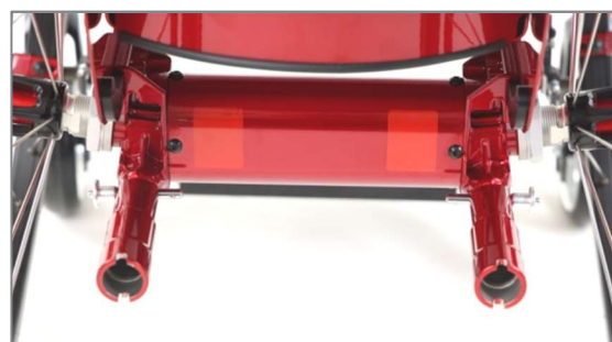
Figura 55: Supporti antiribaltamento rimossi e Quick Pin nei fori dei tubi inferiori del telaio
