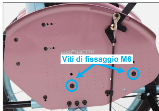
Figura 6: Viti di fissaggio M6 esterne alla spondina paraspruzzi per la regolazione delle altezze, inclinazione e profondità del sedile
