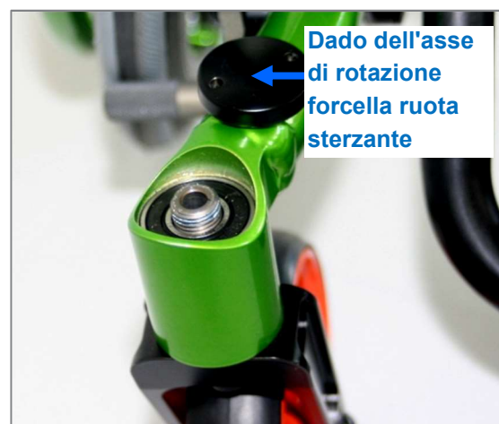
Figura 47: Dado dell'asse di rotazione forcella ruota sterzante completamente rimosso
