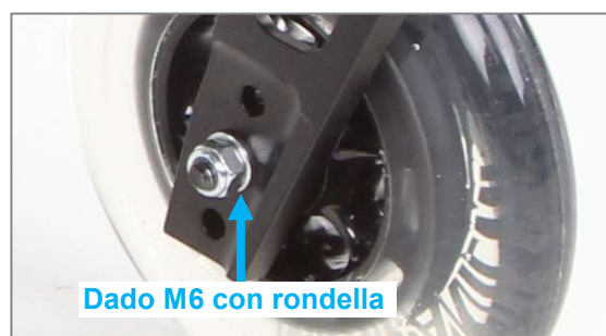
Figura 42: Dado M6 dell'asse ruota sterzante (vista dal lato interno del prodotto)
