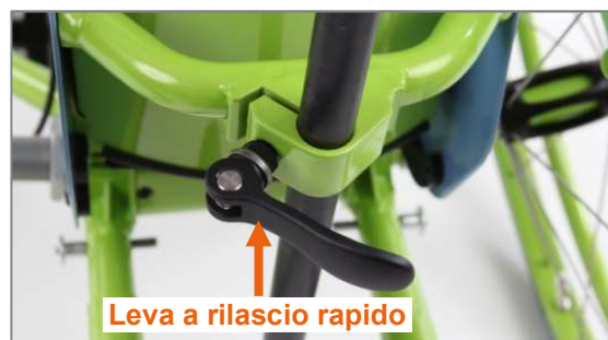
Figura 66: Leva a rilascio rapida chiusa
