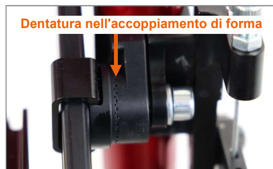
Figura 16: Dentatura sul dispositivo di serraggio del poggia-piedi, nell'accoppiamento di forma
