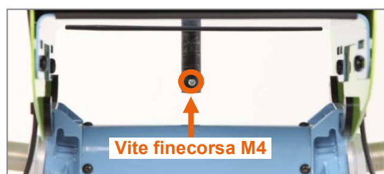
Figura 68: Vite finecorsa M4 sulla maniglia di spinta centrale applicata in posizione inferiore
