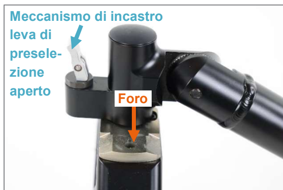
Figura 17: Ruota orientabile a 360°; meccanismo di incastro leva di preselezione aperto
