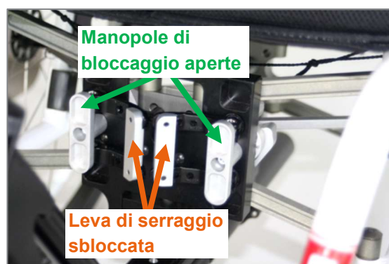
Figura 8: Manopole di bloccaggio in posizione aperta (verticale) e leva di serraggio sbloccata
