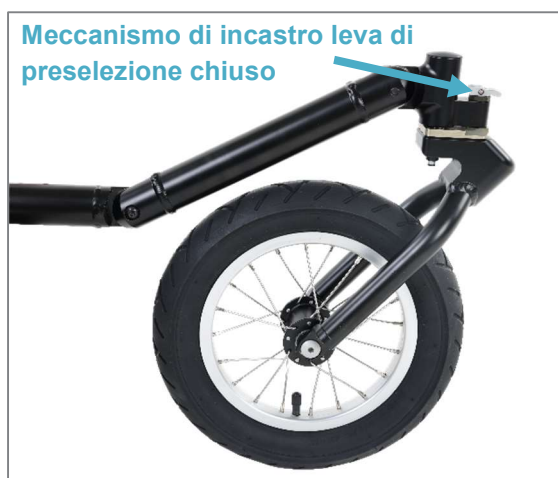
Figura 18: Ruota in posizione bloccata; meccanismo di incastro leva di preselezione chiuso
