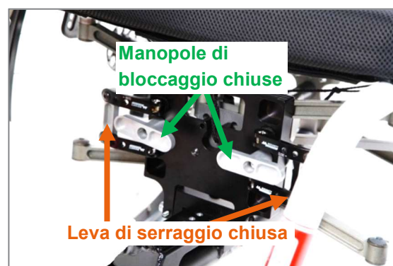
Figura 13: Manopole di bloccaggio e leva di serraggio in posizione chiusa, adattamento per telaio pieghevole montato pronto all'uso
