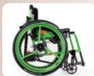
Entraînement à double main courante maniable pour les utilisateurs souffrant d'une hémiplegie ou à mobilité réduite d'un côté d'un corps.
