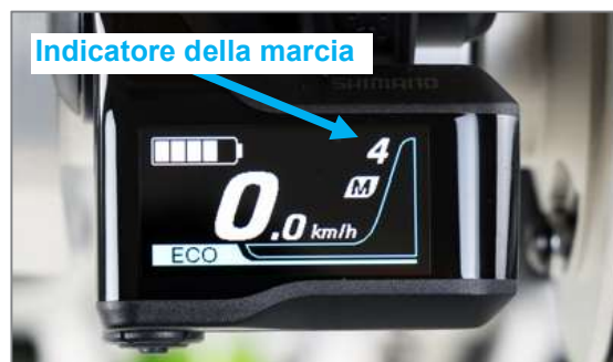
Figura 26: Indicatore della marcia attualmente inserita sul display
