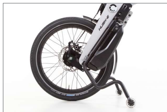
Figura 7: Cavalletto in posizione attiva
