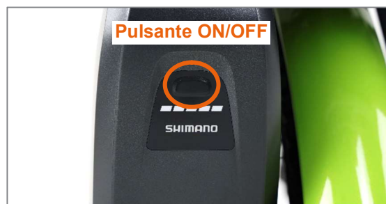
Figura 34: Pulsante di accensione e spegnimento sulla batteria
