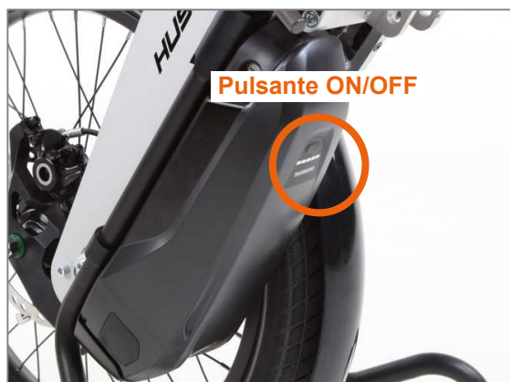
Figura 38: Accensione e spegnimento della batteria
