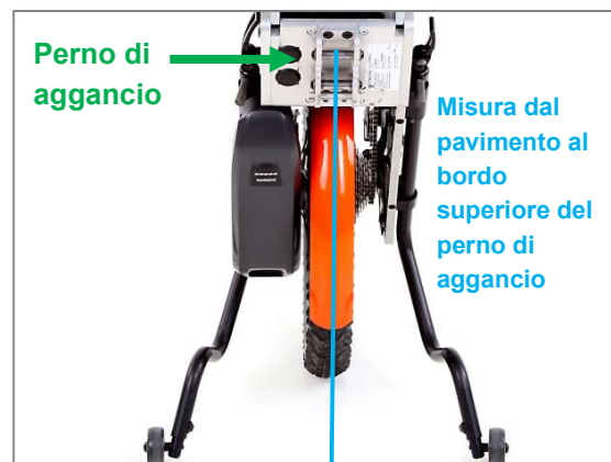
Figura 10: Misura dal pavimento al bordo superiore del perno di aggancio
