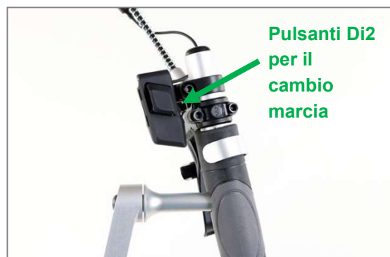
Figura 24: Comando mediante pulsanti
