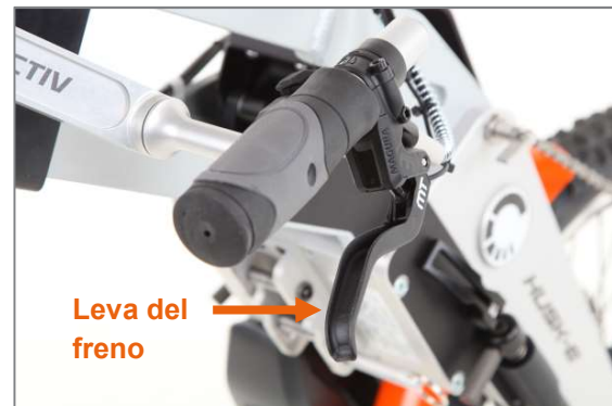
Figura 28: Leva del freno
