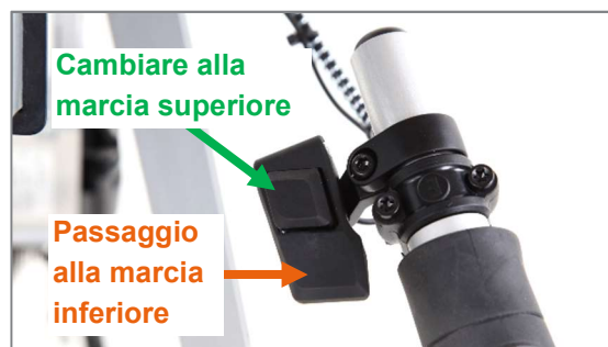
Figura 25: Pulsanti per passare ad una marcia superiore o inferiore
