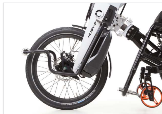
Figura 8: Cavalletto in posizione passiva
