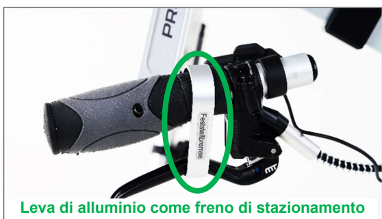
Figura 30: Leva di alluminio come freno di stazionamento
