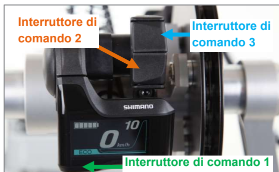
Figura 41: Interruttori di comando per l'attivazione dell'illuminazione a LED
