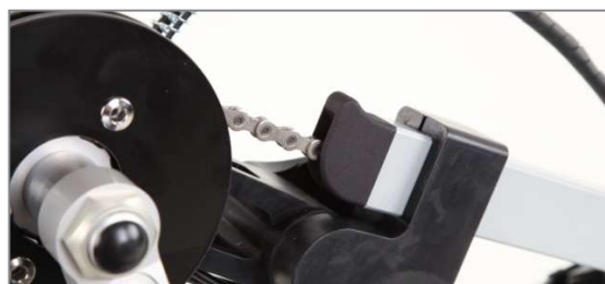
Figura 19: Guide di plastica della catena nel tubo rettangolare
