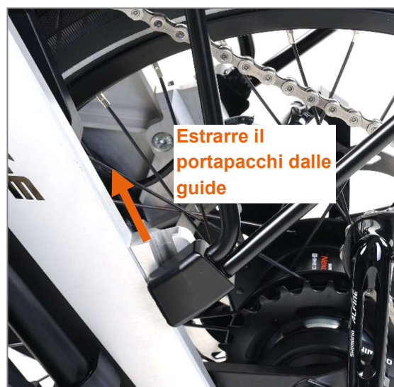
Figura 45: Estrarre il portapacchi dalle guide
