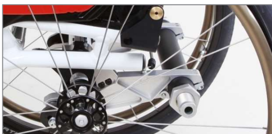
Figura 1: Prolungamento dell'interasse rimovibile
