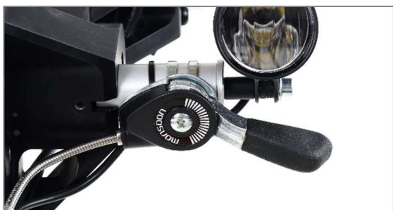
Figura 29: Freno di stazionamento mediante leva di arresto
