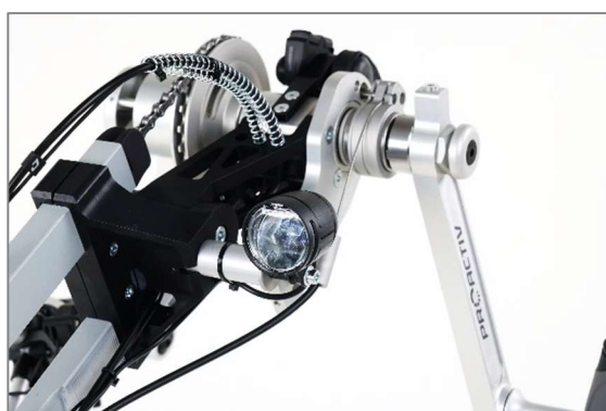
Figura 42: Illuminazione frontale del set di illuminazione a LED
