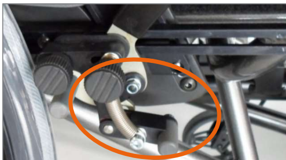
Figura 2: Sicura contro la retromarcia accidentale
