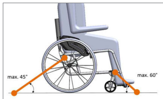
Figure 144 : Position des rétracteurs avant et arrière avec un angle de tension maximum et points d'attache (vue du côté)
