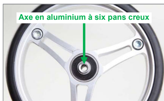
Figure 60 : Roue avant avec axe en aluminium à six pans creux
