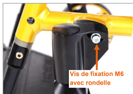
Figure 74 : Vis de fixation M6 sur le côté extérieur du châssis
