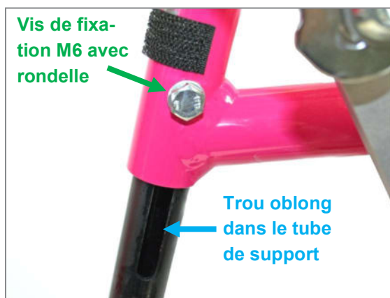
Figure 90 : Vis de fixation M6 avec rondelle et trou oblong dans le tube de support du repose-pieds pour le réglage de la longueur de potence
