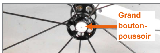
Figure 45 : Axe à démontage rapide avec assistance à la manipulation, grand bouton-poussoir
