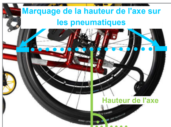
Figure 47 : Marquage de la hauteur de l'axe à l'avant et à l'arrière sur les deux pneumatiques
