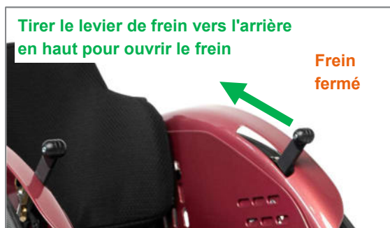
Figure 115 : Frein fermé, tirer le levier de frein vers l'arrière pour ouvrir le frein
