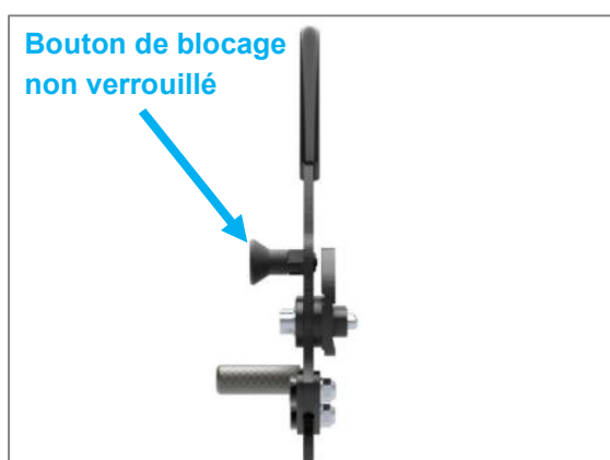
Figure 108 : Bouton de blocage sorti de son verrouillage et tourné de 90° (vue de l'avant)
