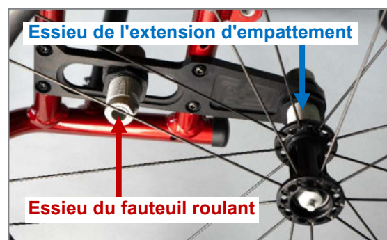
Figure 57 : Extension de l'empattement par plaque de roue rallongée
