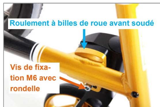
Figure 73 : Vis de fixation M6 sur le côté intérieur du châssis avec rondelle
