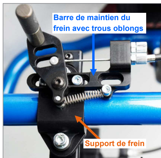
Figure 118 : Support de frein avec barre de maintien du frein
