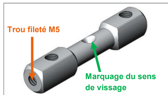
Figure 6 : Insert de plaque de roue de 6° avec trou fileté et creux d'un côté
