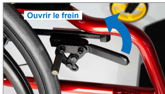
Figure 102 : Frein fermé, l'ouverture s'effectue en tirant le levier de frein vers l'arrière en haut
