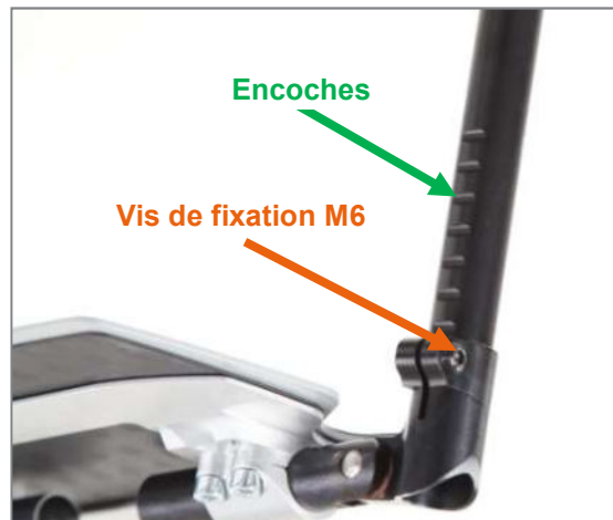
Figure 87 : Encoches et vis de fixation M6 pour le réglage des longueurs de la potence (vue arrière)
