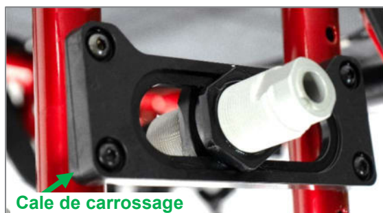
Figure 5 : Plaque de roue avec cale de carrossage (vue du côté extérieur du produit)
