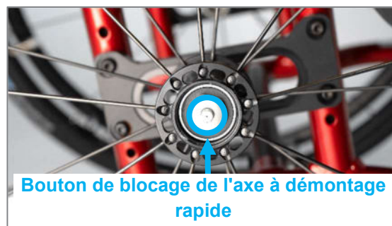
Figure 43 : Bouton de blocage de l'axe à démontage rapide au centre de l'axe de roue
