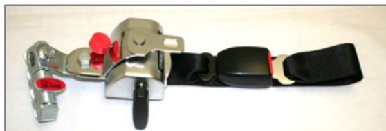
Figure 133 : Rétracteur arrière « semi-automatique » avec poignée de serrage, fermeture et languette de fermeture
