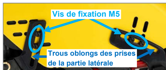
Figure 33 : Vis de fixation M5 et trous oblongs de la prise de la partie latérale
