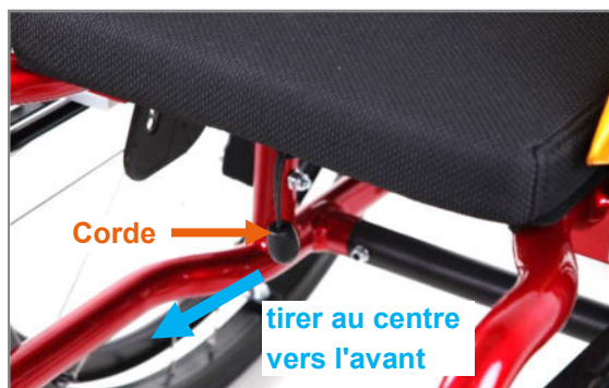
Figure 17 : Corde pour l'actionnement des boulons d'arrêt et ainsi le réglage de l'angle du dossier
