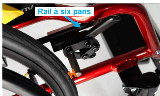
Figure 104 : Écart entre les patins de frein et les pneus d'env. 3 mm à 4 mm maximum lorsque le frein est ouvert
