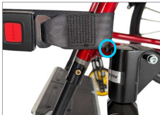
Figure 140 : Symbole pour la fixation avant et la boucle du fauteuil roulant à l'avant
