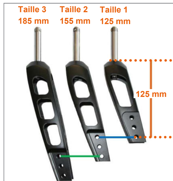
Figure 11 : Tailles de fourche de roue avant avec identification des réglages identiques de hauteur d'assise pour les différentes tailles de fourche de roue avant
