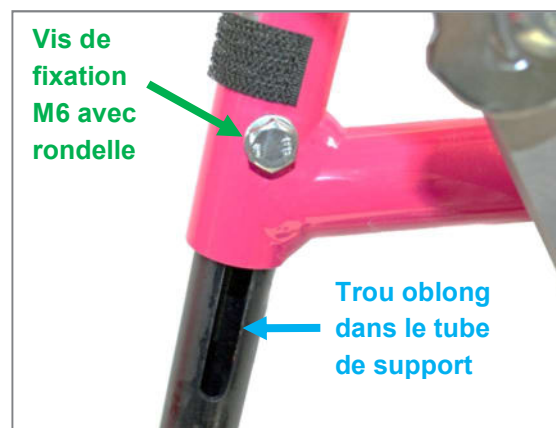
Figure 84 : Vis de fixation M6 avec rondelle et trou oblong dans le tube de support du repose-pieds pour le réglage de la longueur de potence
