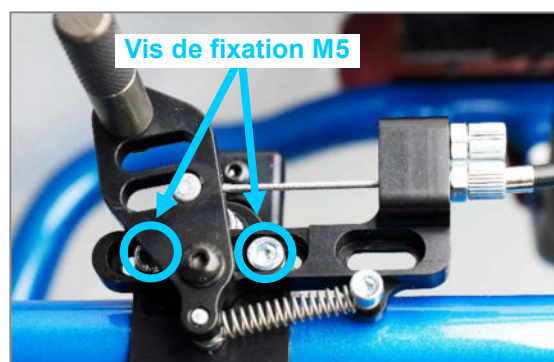
Figure 117 : Vis de fixation M5
