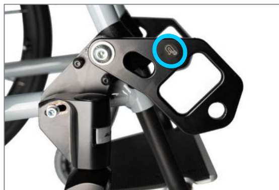
Figure 139 : Plaque d'écartement du roulement avec œillet de ceinture pour le rétracteur avant
