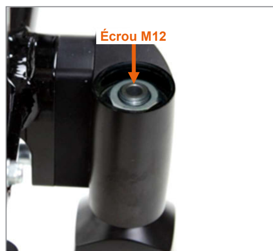
Figure 69 : Capot en aluminium retiré et écrou M12 visible
