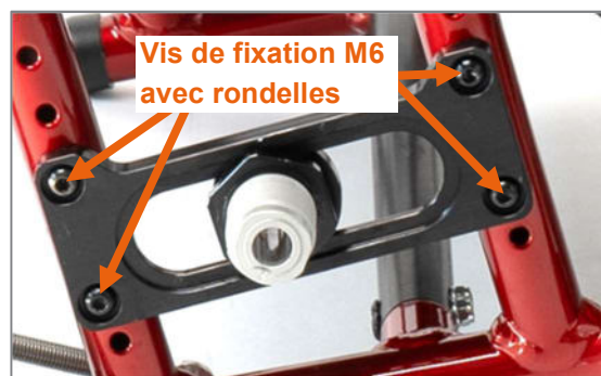
Figure 4 : Vis de fixation M6 de la plaque de roue (vue du côté extérieur du produit, roue d'entraînement enlevée)
