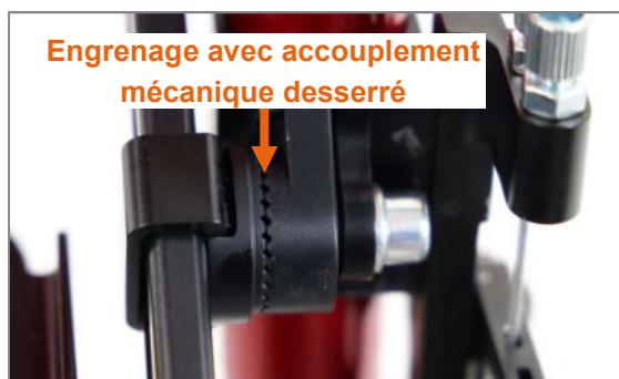
Figure 93 : Engrenage sur le tendeur du cale-pieds, à accouplement mécanique desserré
