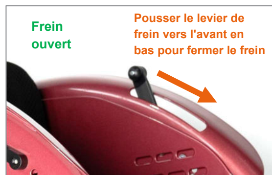
Figure 114 : Frein ouvert, pousser le levier de frein vers l'avant en bas pour fermer le frein
