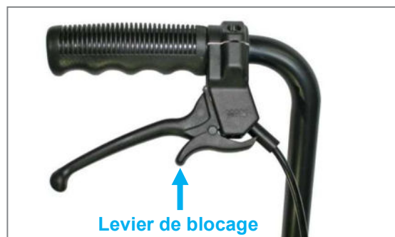
Figure 121 : Poignée de frein sur le dispositif de poussée avec levier de blocage
