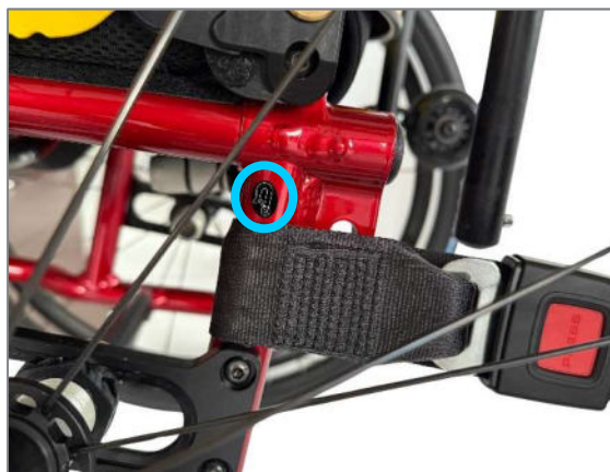
Figure 141 : Symbole pour la fixation arrière et la boucle du fauteuil roulant à l'arrière
