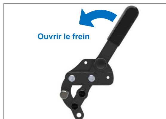
Figure 110 : Frein fermé, l'ouverture s'effectue en tirant le levier de frein vers l'arrière en haut
