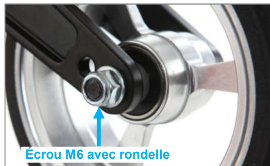
Figure 63 : Écrou M6 de l'axe de la roue avant (vue du côté intérieur du produit)
