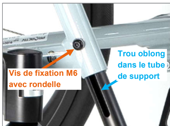
Figure 77 : Vis de fixation M6 avec rondelle et trou oblong dans le tube de support du repose-pieds pour le réglage de la longueur de potence
