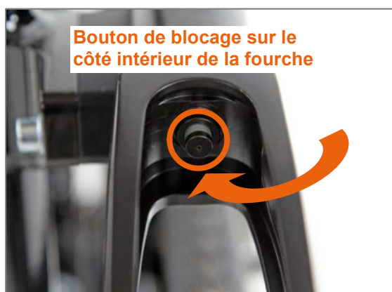
Figure 70 : Fourche de roue avant avec axe à démontage rapide et bouton de blocage
