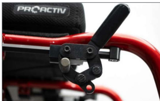
Figure 100 : Système de frein à pousser avec levier de frein déporté de 20°
