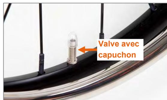
Figure 61 : Valve avec capuchon
