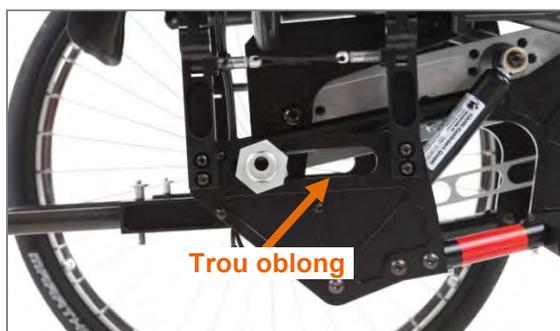
Figure 5 : Plaque de roue avec douille de roue d'entraînement
