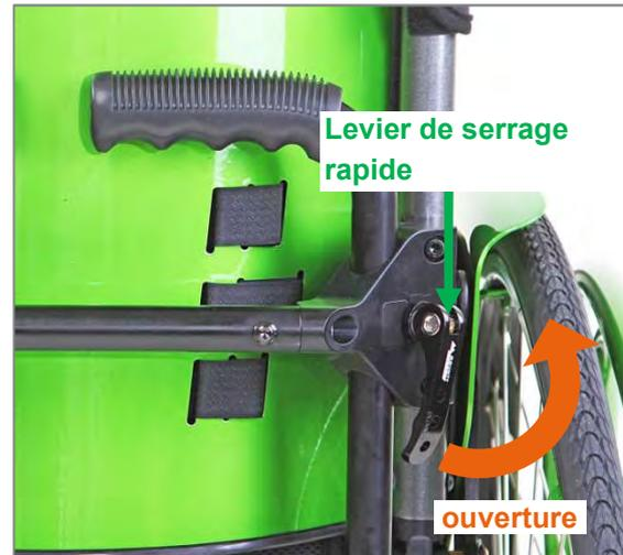
Figure 143 : Levier de serrage rapide fermé
