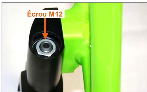
Figure 75 : Capot en aluminium retiré et écrou M12 visible
