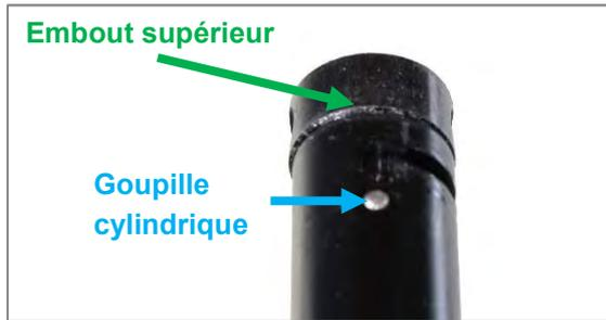
Figure 111 : Réglage du pivotement de la roulette anti-bascule
