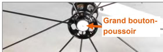
Figure 52 : Axe à démontage rapide avec assistance à la manipulation, grand bouton-poussoir
