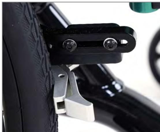
Figure 135 : Élément de frein reposant sur le pneu
