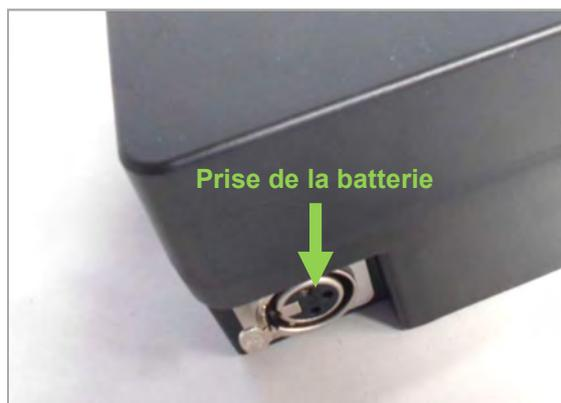
Figure 155 : Prise de la batterie
