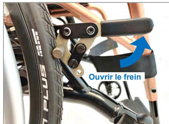
Figure 120 : Frein fermé, l'ouverture s'effectue en tirant le levier de frein vers l'arrière en haut
