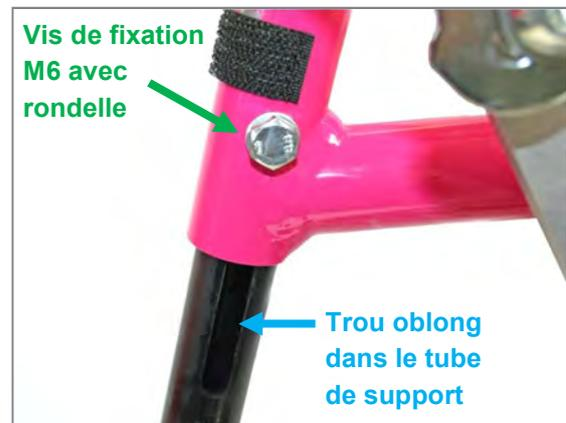
Figure 100 : Vis de fixation M6 avec rondelle et trou oblong dans le tube de support du repose-pieds pour le réglage de la longueur de potence
