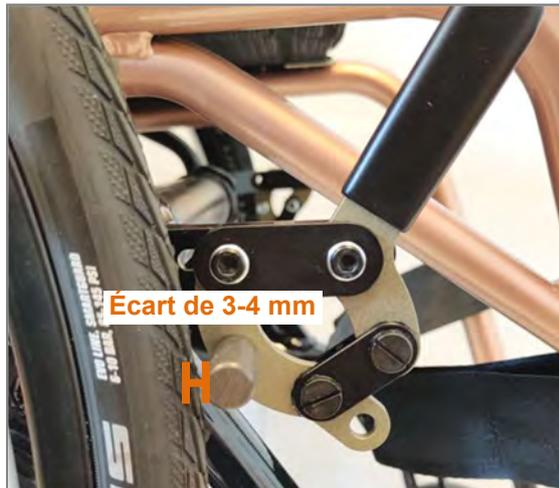
Figure 125 : Écart entre les patins de frein et les pneus d'env. 3 mm à 4 mm maximum lorsque le frein est ouvert (monté à l'avant)
