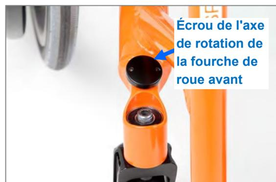
Figure 77 : Écrou entièrement retiré de l'axe de rotation de la fourche de roue avant
