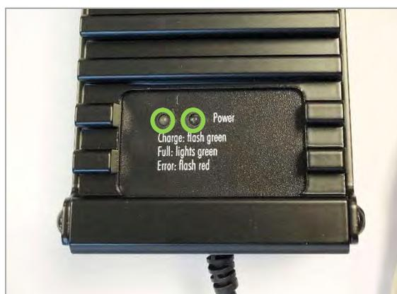
Figure 156 : Indicateur lumineux sur le chargeur
