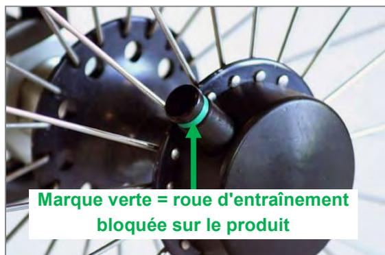
Figure 53 : Tetra-Clip avec axe de démontage rapide bloqué
