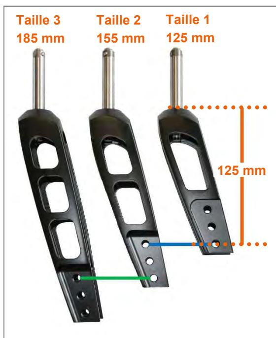
Figure 2 : Tailles de fourche de roue avant avec identification des réglages identiques de hauteur d'assise pour les différentes tailles de fourche de roue avant
