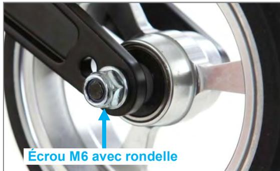
Figure 69 : Écrou M6 de l'axe de la roue avant (vue du côté intérieur du produit)
