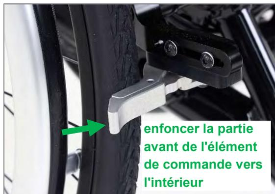
Figure 134 : Frein intégral fermé ; l'ouverture s'effectue en appuyant sur l'élément de commande au centre du fauteuil roulant
