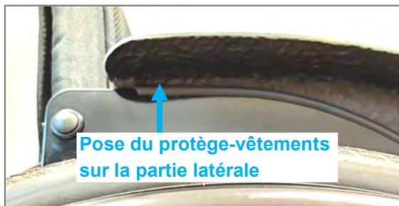
Figure 48 : Le protège-vêtements repose sur la partie latérale (vue latérale)
