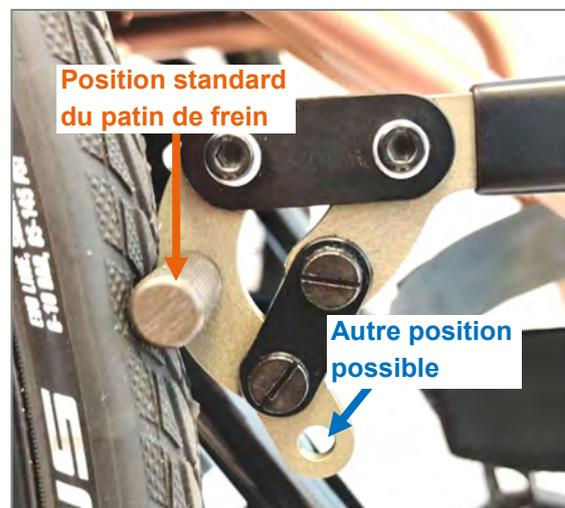
Figure 127 : Positions du patin de frein (monté à l'avant)
