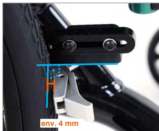
Figure 136 : Élément de frein après positionnement correct du frein intégral
