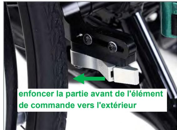
Figure 132 : Frein intégral ouvert, la fermeture s'effectue en enfonçant vers l'extérieur l'élément de commande
