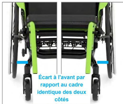
Figure 59 : Écart à l'avant par rapport au cadre (LIFT activ)
