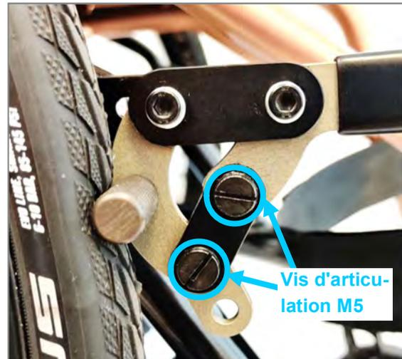
Figure 126 : Vis d'articulation M5 pour le réglage de la force d'actionnement du levier de frein (monté à l'avant)
