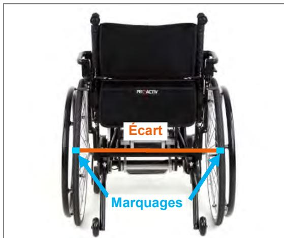
Figure 60 : Écart entre les marquages des pneumatiques (sur la hauteur de l'axe), (vue arrière, LIFT solid)
