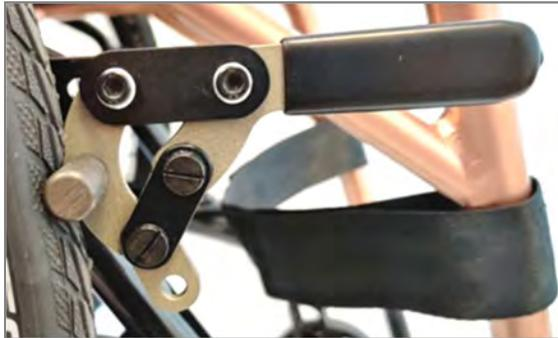
Figure 118 : Système de frein à pousser avec levier de frein standard
