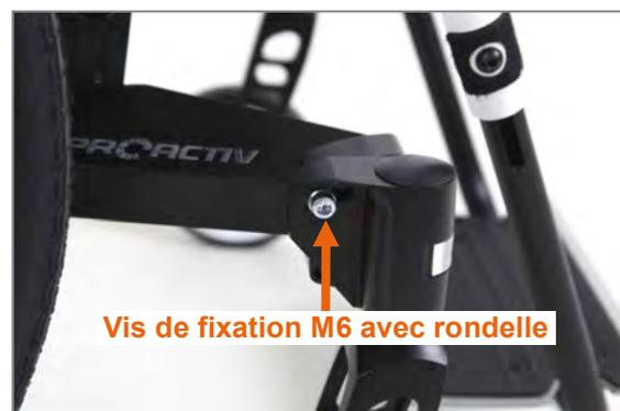
Figure 82 : Vis de fixation M6 sur le côté extérieur du châssis avec rondelle
