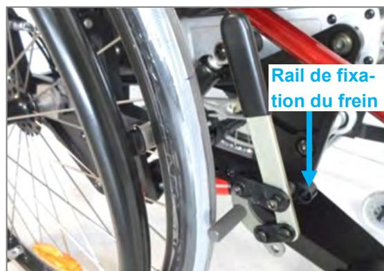
Figure 123 : Frein à pousser (monté bas), levier de frein long ; LIFT solid
