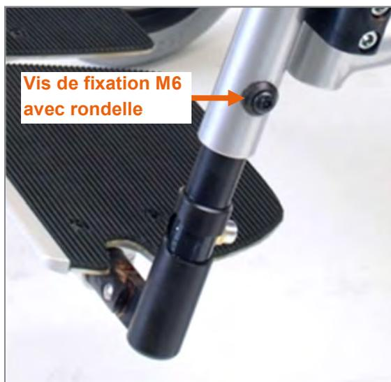
Figure 105 : Vis de fixation M6 avec rondelle pour le réglage de la longueur de la potence
