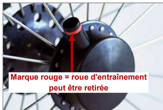
Figure 54 : Tetra-Clip avec axe de démontage rapide ouvert, la roue d'entraînement peut être retirée
