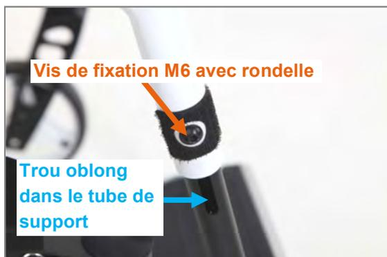
Figure 85 : Vis de fixation M6 avec rondelle et trou oblong dans le tube de support du repose-pieds pour le réglage de la longueur de potence
