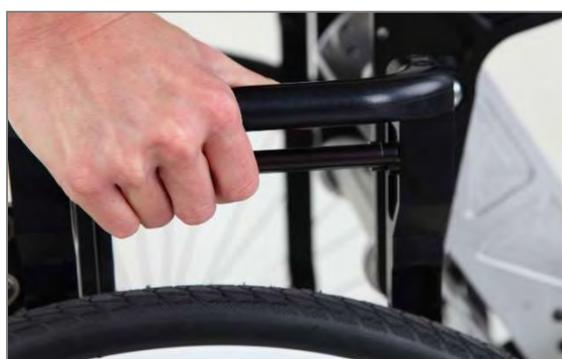
Figure 150 : Mécanisme de déclenchement mécanique actionné
