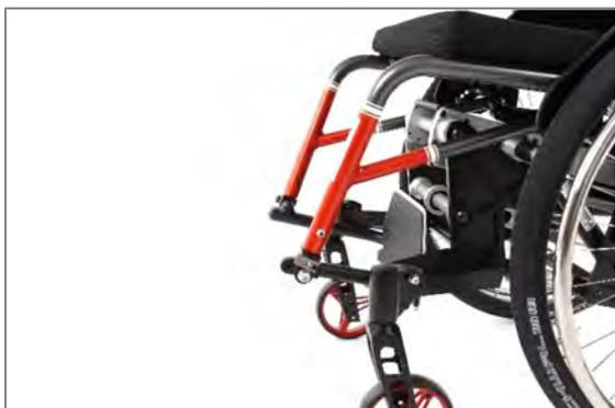
Figure 93 : Repose-pieds pliable en arrière vers le haut avec mécanisme d'enclenchement à ressort, position repliée en arrière vers le haut
