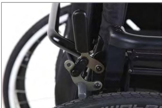
Figure 128 : Frein à pousser monté à l'arrière (vue latérale)
