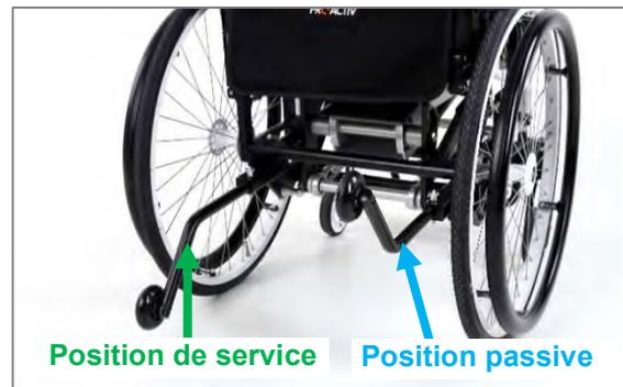
Figure 116 : Position de service et position passive de la roulette anti-bascule (vue arrière)
