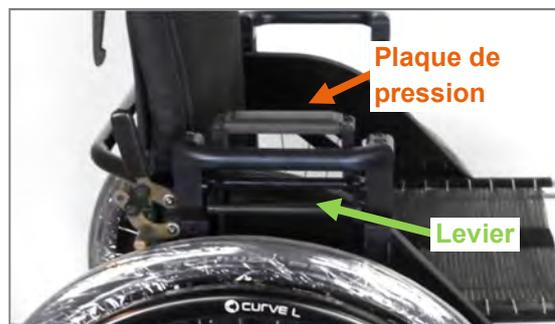
Figure 151 : Mécanisme de déclenchement, équipé en plus d'une plaque de pression
