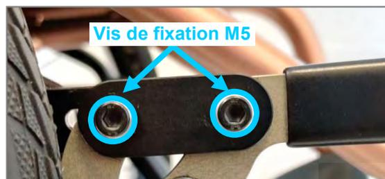
Figure 122 : Vis de fixation M5 sur le rail de fixation du frein (monté à l'avant) ; LIFT activ
