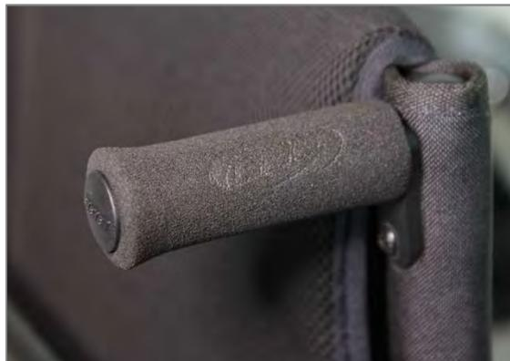
Figure 139 : Poignée de poussée vissée à l'horizontale dans le tube dorsal
