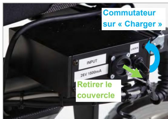
Figure 158 : Préparation pour la recharge sur le côté arrière du fauteuil roulant
