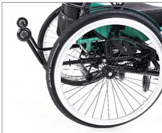
Figure 109 : Position passive de la roulette anti-bascule (vue latérale)
