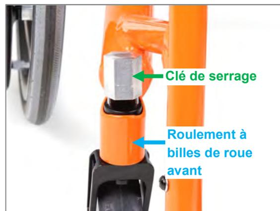
Figure 76 : Desserrage de l'écrou de l'axe de rotation de la fourche de roue avant avec clé de serrage
