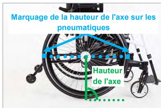
Figure 55 : Marquage de la hauteur de l'axe à l'avant et à l'arrière sur les deux pneumatiques (LIFT solid)
