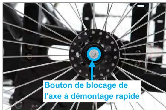
Figure 50 : Bouton de blocage de l'axe à démontage rapide au centre de l'axe de roue
