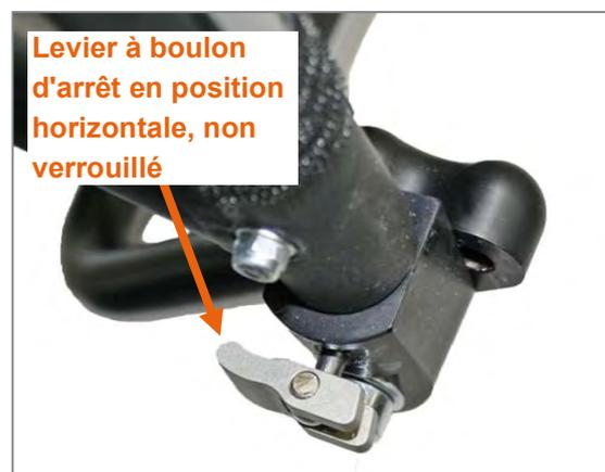
Figure 88 : Levier à boulon d'arrêt en position horizontale, non verrouillé et par conséquent ne reposant pas sur l'articulation du repose-pieds
