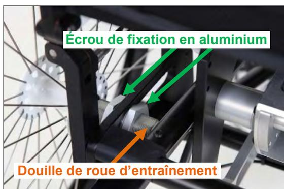
Figure 6 : Douille de roue d'entraînement et écrou de fixation en aluminium (vue arrière)
