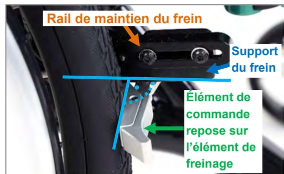
Figure 133 : Frein intégral fermé ; élément de frein perpendiculaire au support de frein
