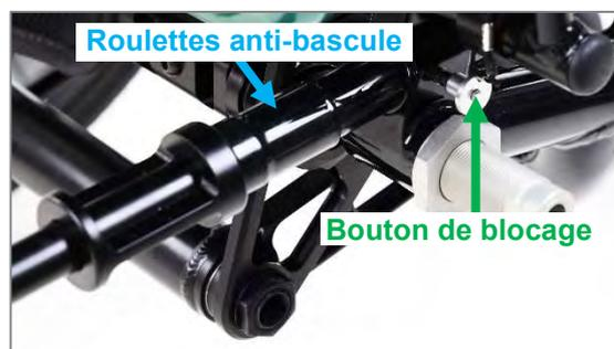
Figure 108 : Quickpin avec bouton de blocage
