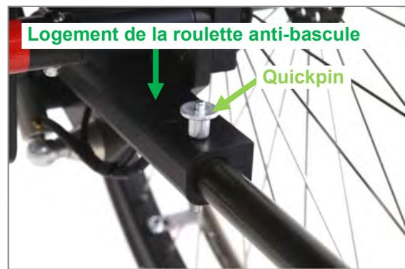
Figure 115 : Roulette anti-bascule avec Quickpin (vue arrière)
