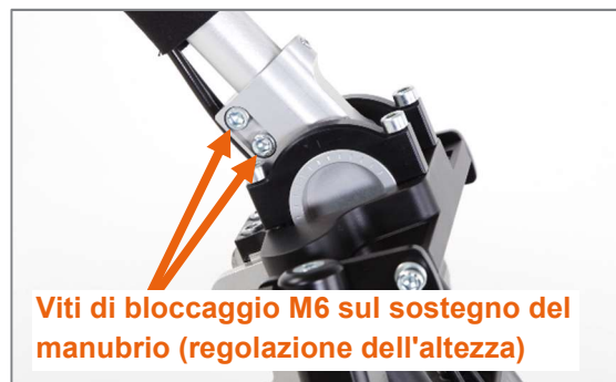
Figura 23: Viti di bloccaggio M6 per la regolazione dell'altezza della posizione del manubrio
