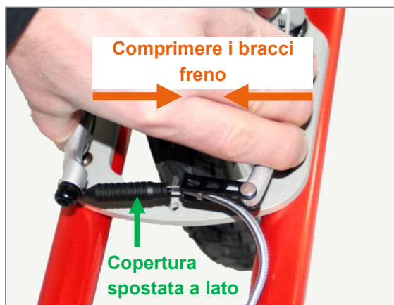
Figura 4: Copertura spostata a lato e bracci freno compressi
