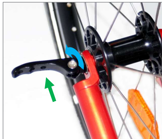
Figura 7: Apertura e rotazione della leva a rilascio rapido
