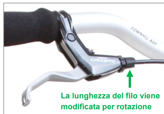
Figura 3: Leva del freno con possibilità di regolazione della lunghezza del filo
