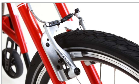
Figura 10: Freno sul cerchione agganciato e lunghezza del filo regolata correttamente
