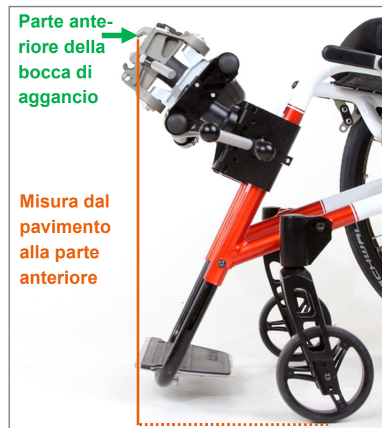
Figura 19: Misura dal pavimento alla parte anteriore della bocca di aggancio
