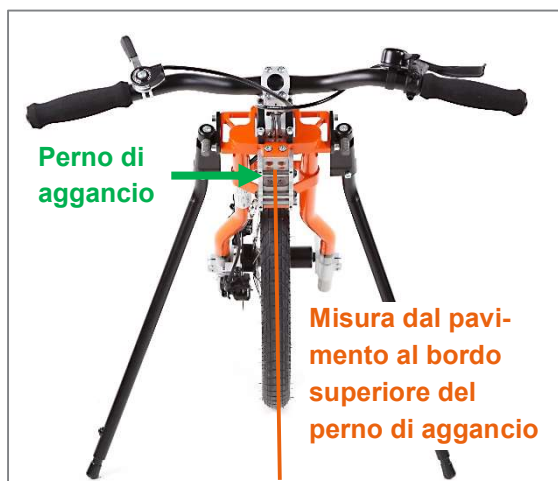
Figura 20: Misura dal pavimento al bordo superiore del perno di aggancio
