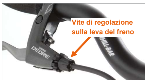
Figura 2: Vite di regolazione sulla leva del freno
