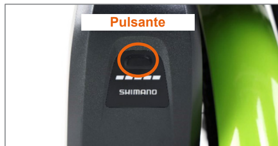
Figura 34: Pulsante di accensione e spegnimento sulla batteria
