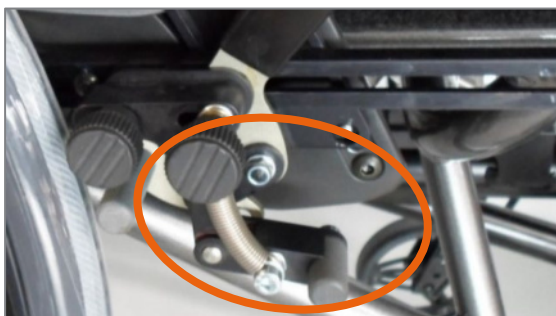
Figura 2: Sicura contro la retromarcia accidentale
