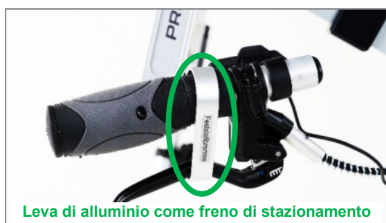
Figura 30: Leva di alluminio come freno di stazionamento
