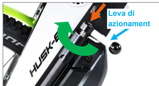
Figura 6: Premere verso il basso e ruotare la leva di azionamento
