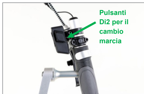
Figura 24: Comando mediante pulsanti
