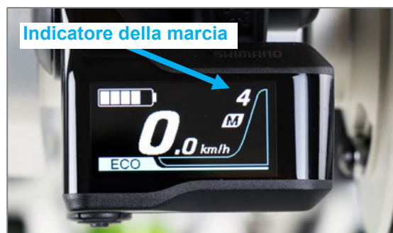
Figura 26: Indicatore della marcia attualmente inserita sul display
