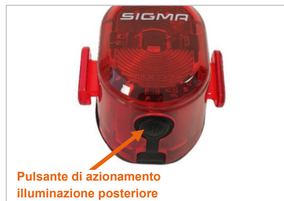
Figura 40: Pulsante di azionamento dell'illuminazione posteriore
