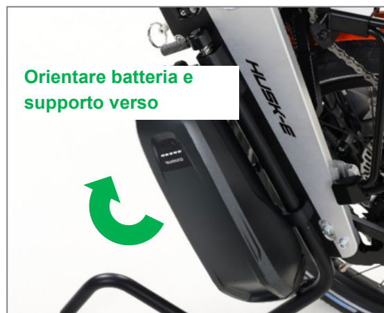
Figura 37: Per il fissaggio orientare batteria e supporto verso l'interno
