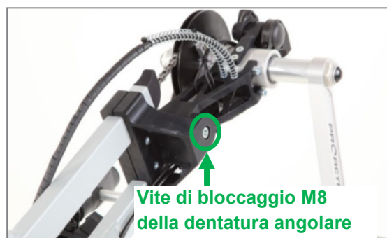
Figura 17: Vite di bloccaggio M8 della dentatura angolare per regolare l'inclinazione della posizione del cuscinetto di movimento
