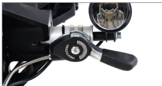
Figura 29: Freno di stazionamento mediante leva di arresto
