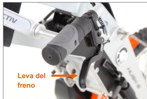
Figura 28: Leva del freno
