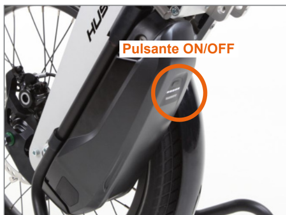
Figura 38: Accensione e spegnimento della batteria
