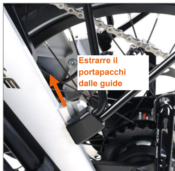
Figura 45: Estrarre il portapacchi dalle guide
