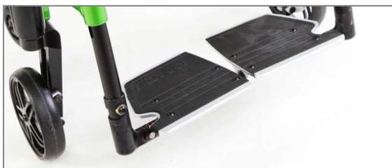
Figura 99: Poggiapiedi separato centralmente, in posizione standard
