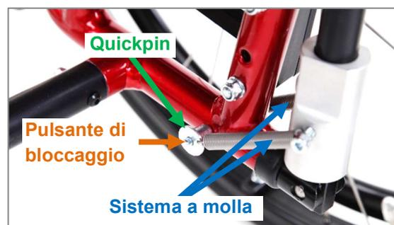
Figura 109: Quickpin e sistema a molla del supporto antiribaltamento
