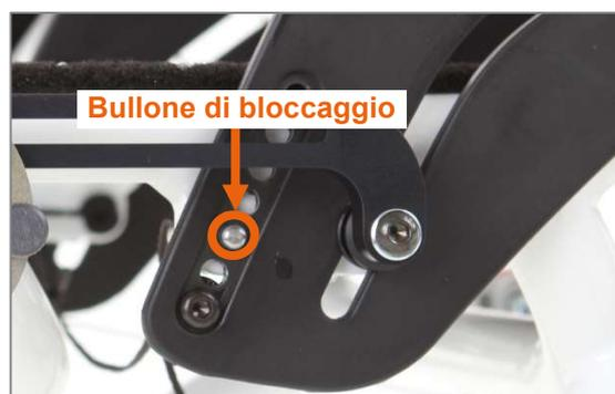
Figura 21: Il bullone di bloccaggio fa presa nel foro di bloccaggio della parte laterale (vista dal lato interno del prodotto, senza spondina paraspruzzi)
