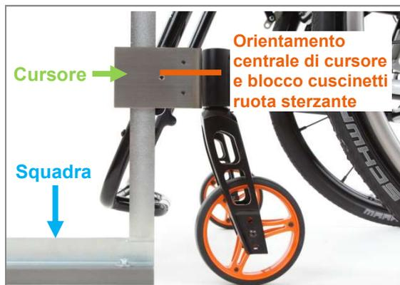
Figura 81: Verifica della regolazione degli assi di rotazione della forcella della ruota sterzante
