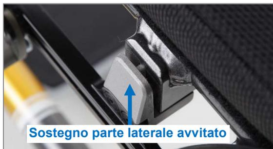
Figura 40: "Sostegno parte laterale avvitato" (vista senza spondina paraspruzzi)
