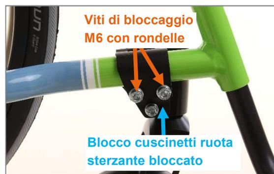
Figura 85: Viti di bloccaggio M6 per blocco cuscinetti ruota sterzante bloccato
