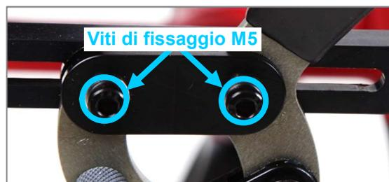
Figura 114: Viti di fissaggio M5 sulla guida di arresto del freno
