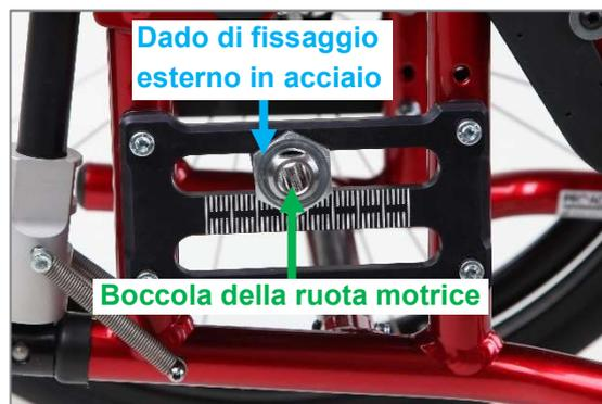
Figura 16: Dado di fissaggio esterno in acciaio e boccola della ruota motrice (vista dal lato esterno del prodotto, ruota motrice rimossa)
