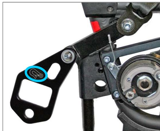
Figura 144: Collegamento del sistema di bloccaggio sul telaio posteriore con occhiello per cinghia per il retractor posteriore e cinghia di sicurezza
