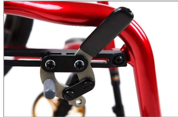
Figura 111: Sistema freno a leve separate con leva del freno esposta di 20°
