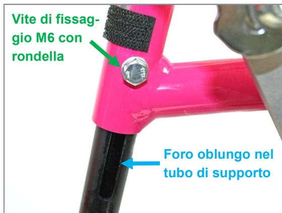
Figura 95: Vite di fissaggio M6 con rondella e foro oblungo nel tubo di supporto poggiatesta per la regolazione della lunghezza della gamba
