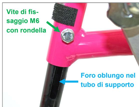
Figura 101: Vite di fissaggio M6 con rondella e foro oblungo nel tubo di supporto poggiatesta per la regolazione della lunghezza della gamba
