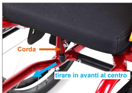
Figura 22: Corda per l'azionamento dei bulloni di bloccaggio e quindi la regolazione dell'angolazione dello schienale
