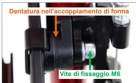
Figura 103: Dentatura sul dispositivo di serraggio del poggiapiedi, nell'accoppiamento di forma
