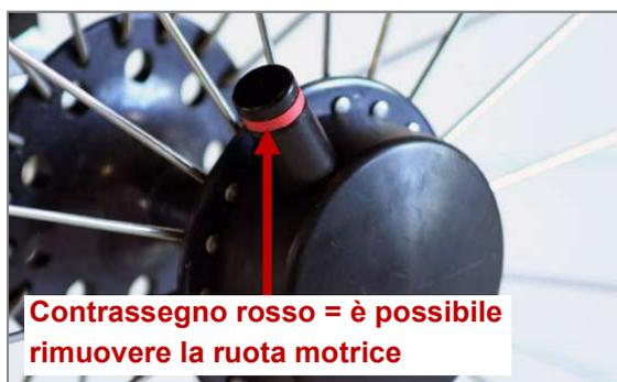
Figura 58: Tetra Clip con asse flottante aperto: è possibile rimuovere la ruota motrice
