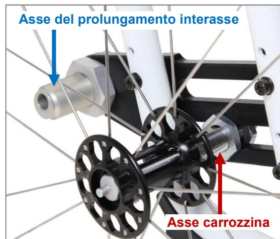
Figura 67: Prolungamento interasse mediante piastra della ruota estesa
