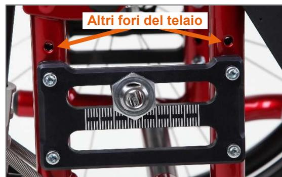
Figura 10: Fori del telaio (vista dal lato esterno del prodotto, ruota motrice rimossa)
