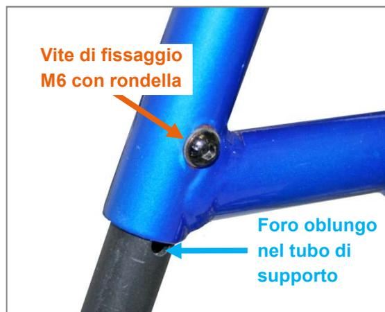
Figura 88: Vite di fissaggio M6 con rondella e foro oblungo nel tubo di supporto poggiapiedi per la regolazione della lunghezza della gamba
