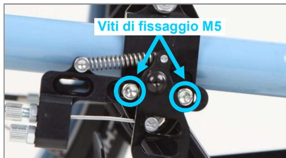
Figura 123: Viti di fissaggio M5
