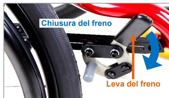
Figura 112: Freno aperto; la chiusura viene effettuata premendo in avanti verso il basso la leva del freno
