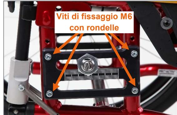
Figura 7: Viti di fissaggio M6 della piastra della ruota (vista dal lato esterno del prodotto, ruota motrice rimossa)
