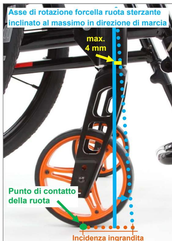
Figura 77: Ingrandimento dell'incidenza tramite inclinazione dell'asse di rotazione della forcella ruota sterzante
