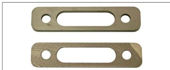
Figura 59: Due distanziali della traccia con diverso spessore del materiale
