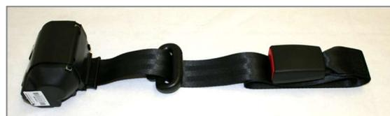
Figura 141: Cinghia trasversale per spalle automatica con rinvio e fibbia di chiusura
