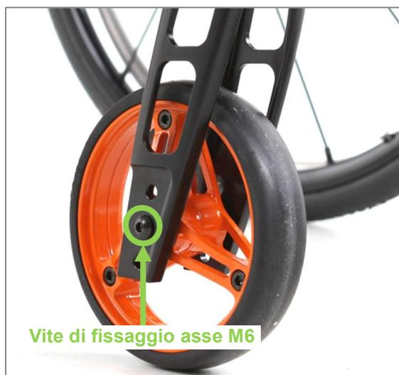
Figura 69: Vite di fissaggio M6 dell'asse ruota sterzante (vista dal lato esterno del prodotto)
