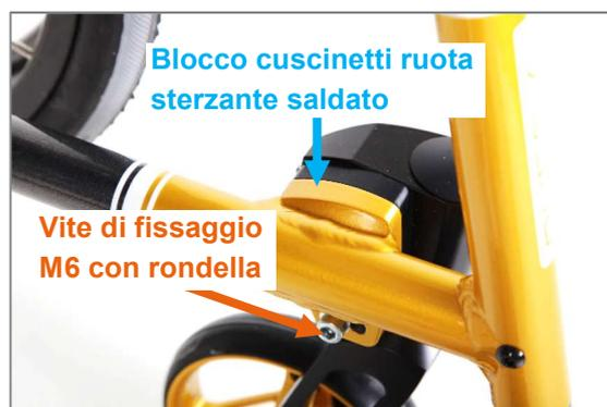
Figura 83: Vite di fissaggio M6 sul lato interno del telaio con rondella
