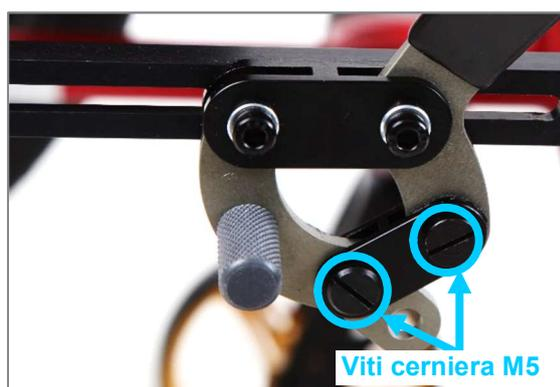
Figura 116: Viti cerniera M5 per la regolazione della forza di azionamento della leva del freno
