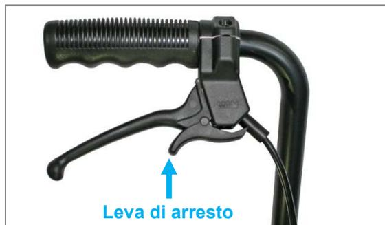
Figura 127: Presa del freno sul dispositivo di spinta con leva di arresto
