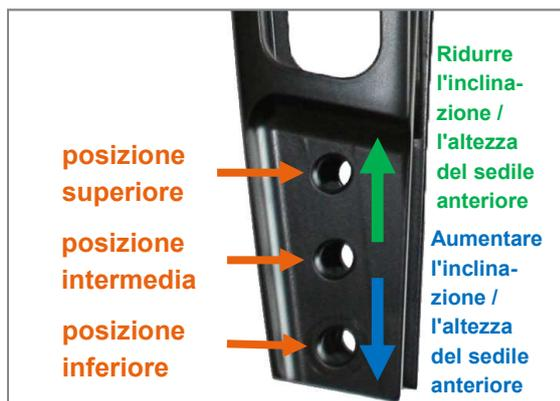
Figura 13: Tre posizioni nella forcella della ruota sterzante per il posizionamento della ruota sterzante ed effetto sull'altezza del sedile anteriore
