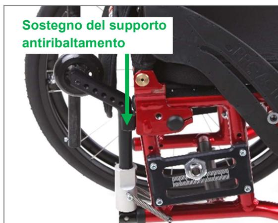
Figura 108: Posizione passiva del supporto antiribaltamento
