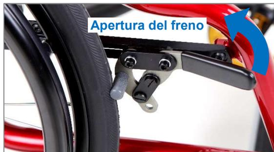
Figura 113: Freno chiuso; l'apertura viene effettuata tirando la leva del freno all'indietro verso l'alto.
