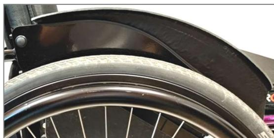
Figura 31: Spondina paraspruzzi applicata sul prodotto (vista con ruota motrice)
