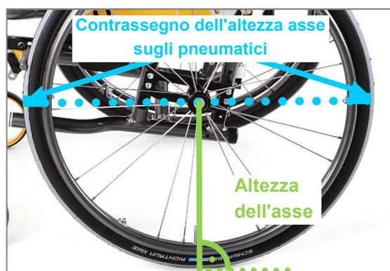
Figura 60: Contrassegno dell'altezza asse anteriormente e posteriormente su entrambi gli pneumatici
