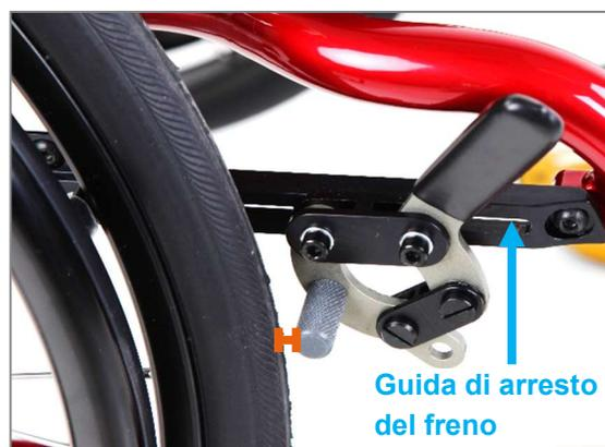
Figura 115: Distanza tra i bulloni del freno e gli pneumatici compresa tra circa 3 e max. 4 mm con il freno aperto
