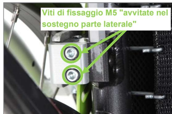
Figura 51: "Sostegno parte laterale avvitato" con fori oblungi e viti di fissaggio M5 al corpo di base del sostegno parte laterale (vista dal basso)
