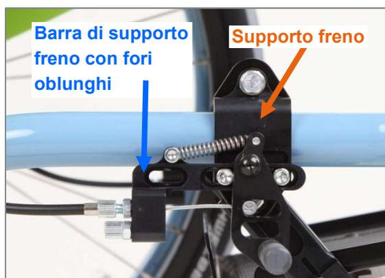
Figura 124: Supporto freno e barra di supporto freno
