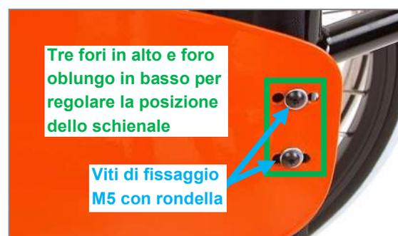
Figura 20: Regolazione della posizione dello schienale tramite i fori nella parte laterale
