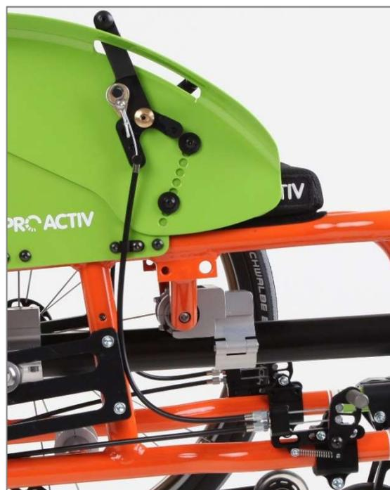
Figura 122: Sistema frenante a leve separate con comando dei freni integrato in alto nella spondina paraspruzzi
