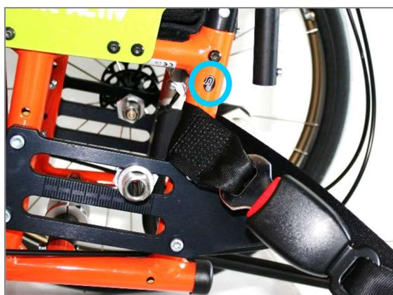
Figura 147: Simbolo del fissaggio posteriore e con occhielli della carrozzina sul dietro
