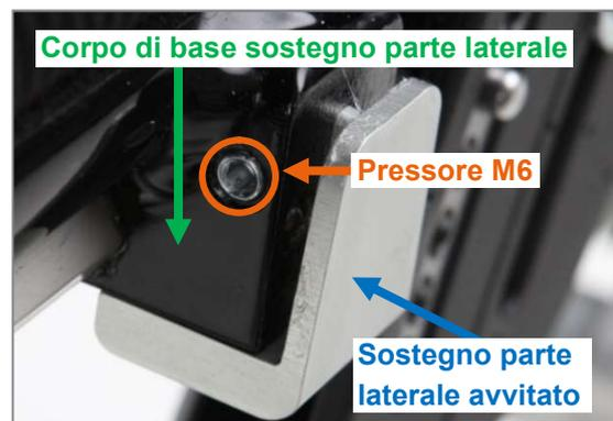
Figura 46: Pressore M6 avvitato nel "corpo di base del sostegno parte laterale"
