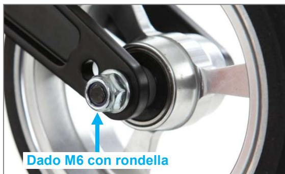
Figura 73: Dado M6 dell'asse ruota sterzante (vista dal lato interno del prodotto)
