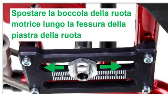
Figura 18: Spostare la boccola della ruota motrice lungo la fessura della piastra della ruota (vista dal lato esterno del prodotto)
