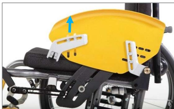
Figura 41: Spondina paraspruzzi tirata in avanti fuori dal "sostegno parte laterale avvitato" (vista senza ruota motrice)
