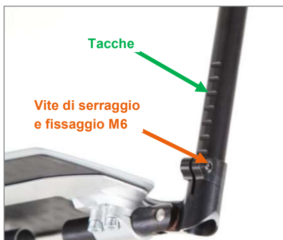
Figura 128: Tacche e vite di serraggio e fissaggio M6 per la regolazione della lunghezza della gamba (vista posteriore)
