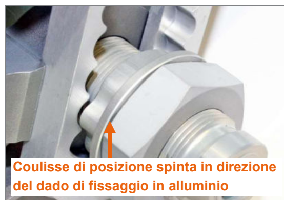
Figura 5: Dado di fissaggio in alluminio allentato e coulisse di posizione spinta in direzione del dado di fissaggio in alluminio (vista dal lato esterno del prodotto)
