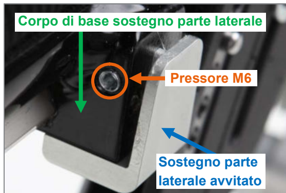
Figura 66: Pressore M6 avvitato nel "corpo di base del sostegno parte laterale"
