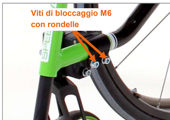
Figura 110: Viti di bloccaggio M6 per blocco cuscinetti ruota sterzante bloccato
