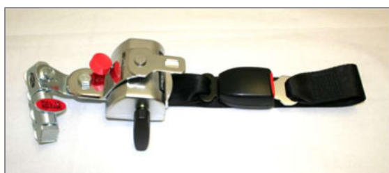
Figura 199: Retrattore posteriore "Semiautomatico" con volantino, fibbia di chiusura e linguetta fibbia
