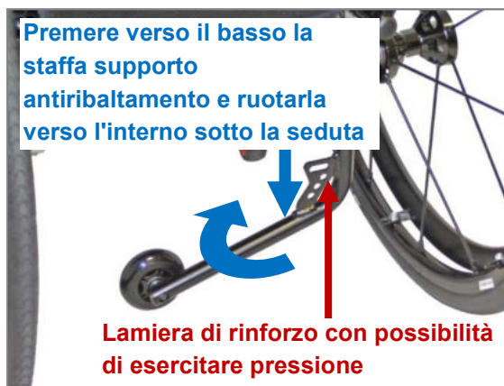
Figura 142: Portare il supporto antiribaltamento in posizione passiva (vista posteriore)
