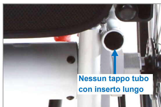
Figura 13: Nessun tappo tubo sull'estremità del telaio significa "inserto lungo" (vista posteriore)
