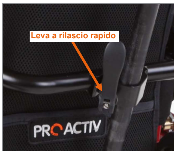
Figura 193: Leva a rilascio rapida chiusa
