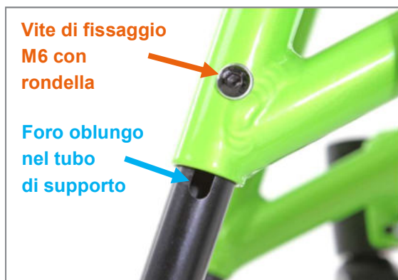
Figura 113: Vite di fissaggio M6 con rondella e foro oblungo nel tubo di supporto poggipiedi per la regolazione della lunghezza della gamba
