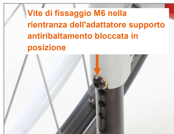
Figura 141: Supporto antiribaltamento bloccata correttamente in posizione
