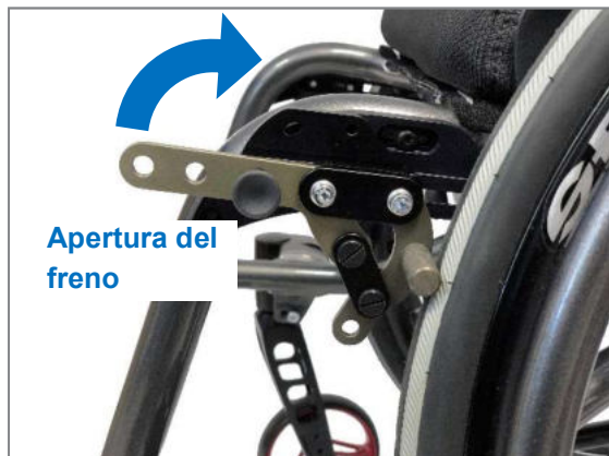
Figura 178: Freno chiuso; l'apertura viene effettuata tirando la leva del freno all'indietro verso l'alto.
