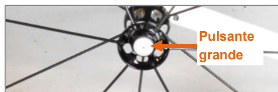
Figura 76: Asse flottante con supporto di comando e pulsante grande
