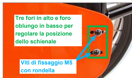
Figura 17: Regolazione della posizione dello schienale tramite i fori nella parte laterale
