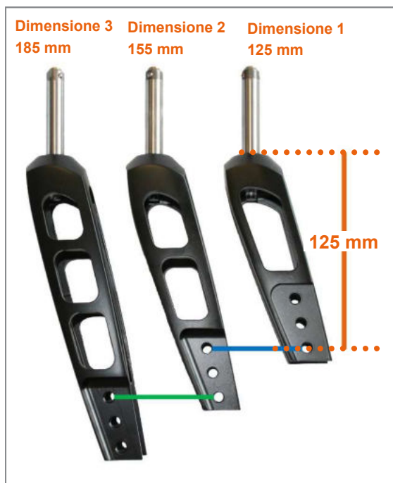
Figura 8: Dimensioni forcella della ruota sterzante con contrassegno delle stesse regolazioni dell'altezza del sedile per diverse dimensioni forcella della ruota sterzante
