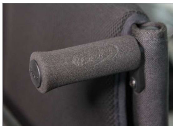
Figura 184: Maniglie di spinta avvitate orizzontalmente nel tubo dello schienale
