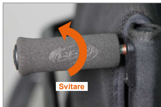
Figura 185: Svitare la maniglia di spinta in orizzontale dal tubo dello schienale
