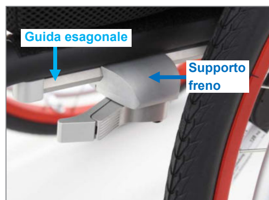
Figura 166: Guida esagonale e supporto freno
