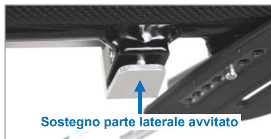
Figura 55: "Sostegno parte laterale avvitato" (vista senza spondina paraspruzzi)
