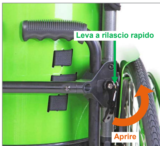
Figura 188: Leva a rilascio rapida chiusa
