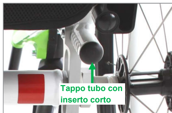
Figura 12: Il tappo tubo sull'estremità del telaio significa "inserto corto" (vista posteriore)
