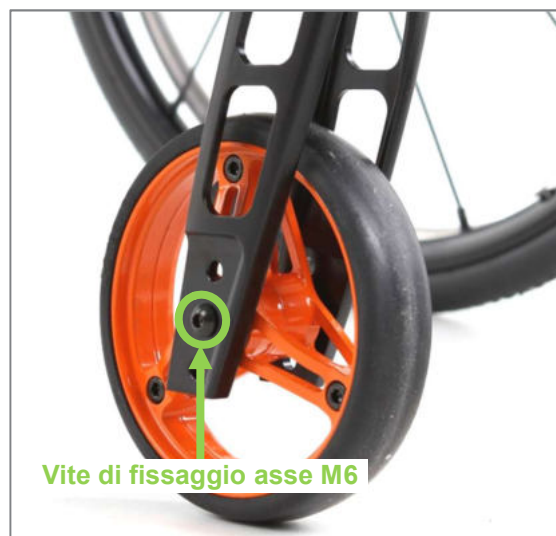
Figura 94: Vite di fissaggio M6 dell'asse ruota sterzante (vista dal lato esterno del prodotto)
