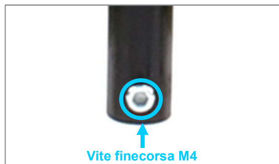
Figura 195: Vite finecorsa M4 sulla maniglia di spinta centrale applicata in posizione inferiore
