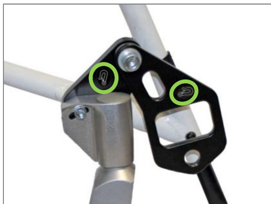
Figura 208: Piastra intermedia blocco cuscinetti ruota sterzante con occhiello per cinghia per il retrattore anteriore
