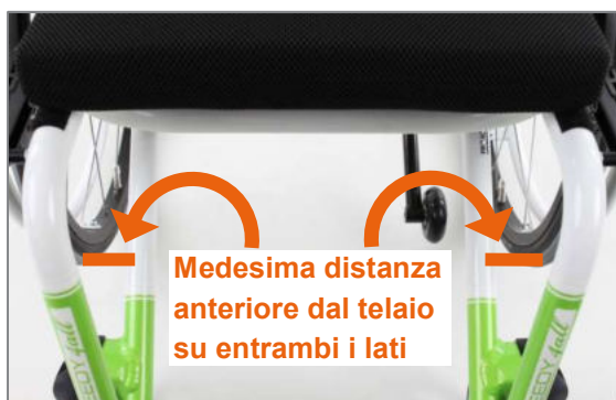
Figura 82: Distanza anteriore dal telaio
