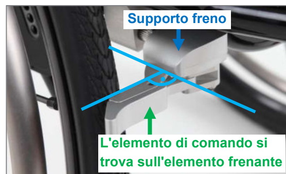
Figura 164: Freno integrale chiuso; elemento frenante in verticale rispetto al supporto freno
