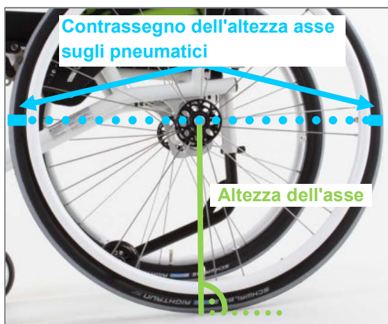
Figura 79: Contrassegno dell'altezza asse anteriormente e posteriormente su entrambi gli pneumatici
