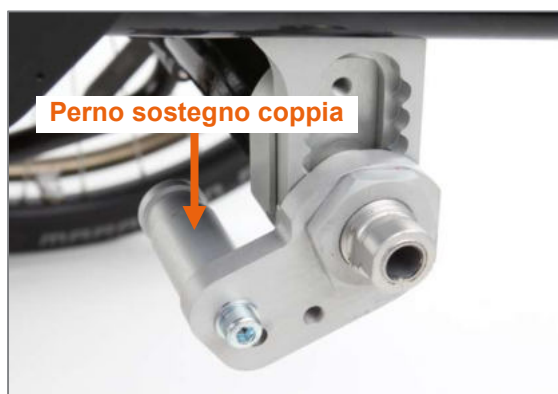
Figura 90: Perno sostegno coppia montato sul prodotto (vista dal lato esterno del prodotto senza ruota motrice)
