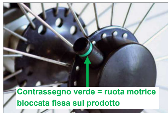
Figura 77: Tetra Clip con asse flottante bloccato
