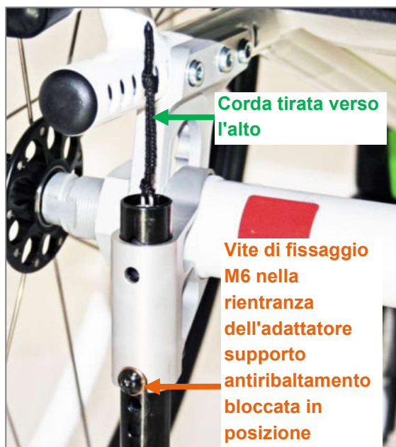
Figura 144: Staffa supporto antiribaltamento inserita nell'adattatore supporto antiribaltamento
