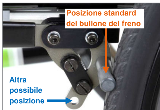
Figura 161: Posizioni del bullone del freno
