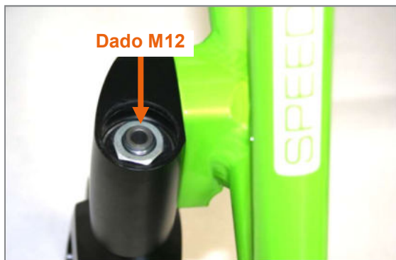
Figura 104: Tappo in alluminio rimosso e dado M12 visibile
