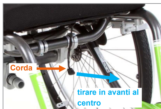
Figura 57: Corda per l'azionamento dei bulloni di bloccaggio
