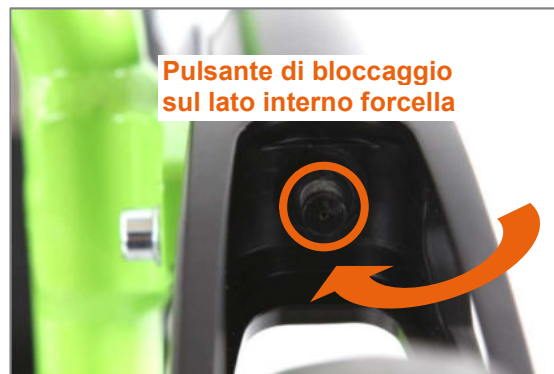
Figura 105: Forcella ruota sterzante con asse flottante e pulsante di bloccaggio
