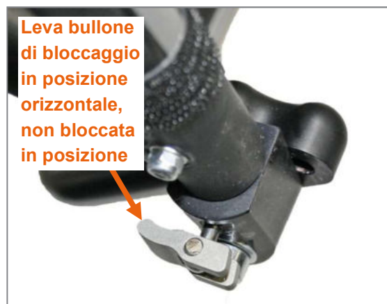
Figura 122: Leve bullone di bloccaggio, in posizione orizzontale, non bloccata in posizione e quindi non poggiate sulla cerniera staffa per piedi
