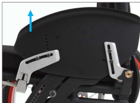
Figura 60: Spondina paraspruzzi tirata in avanti fuori dal "sostegno parte laterale avvitato" (vista senza ruota motrice)
