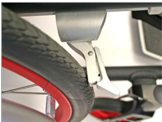
Figura 168: Elemento frenante che poggia sullo pneumatico
