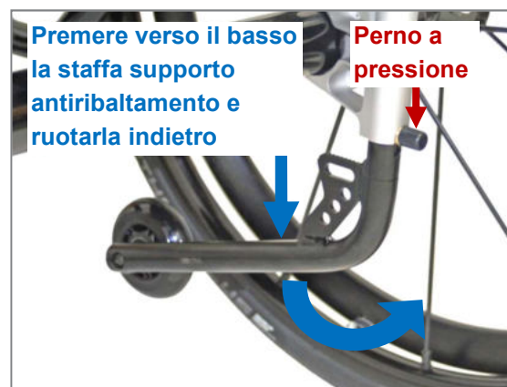
Figura 140: Portare il supporto antiribaltamento in posizione attiva (vista posteriore)
