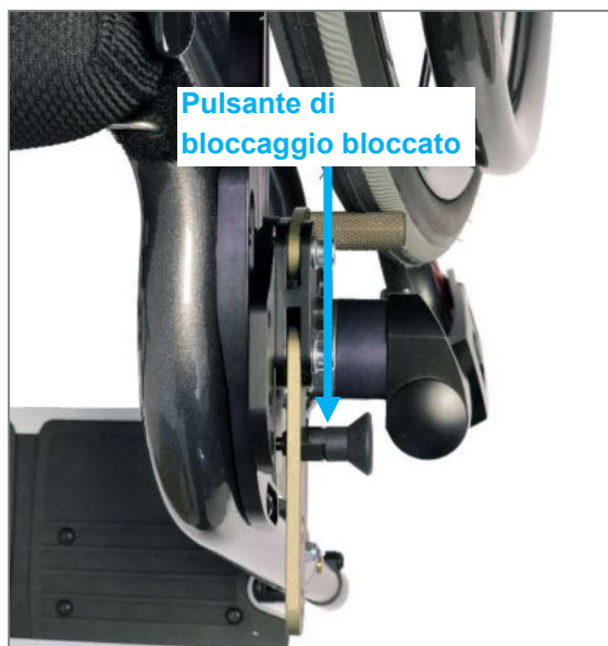
Figura 179: Pulsante di bloccaggio innestato nel blocco di arresto
