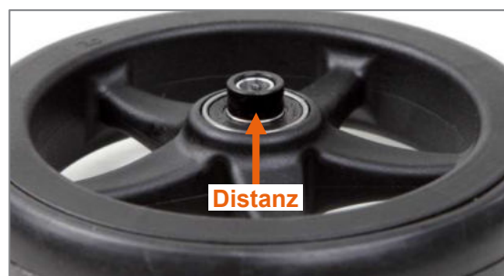
Figura 100: Distanziale sulla ruota sterzante
