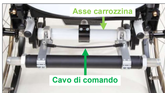
Figura 89: Panoramica delle denominazioni in caso di prolungamento dell'interasse e della carrozzina
