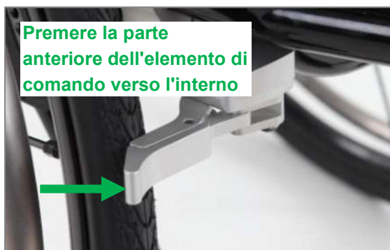
Figura 165: Freno integrale chiuso; l'apertura avviene premendo l'elemento di comando verso il centro della carrozzina
