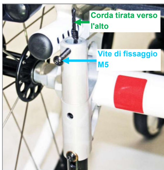
Figura 145: Perno di fissaggio molle appoggiato sull'adattatore supporto antiribaltamento, corda tirata verso l'alto e vite di fissaggio M5 applicata
