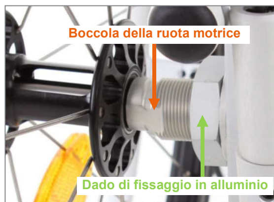
Figura 81: Boccola della ruota motrice e dado di fissaggio in alluminio (vista posteriore)
