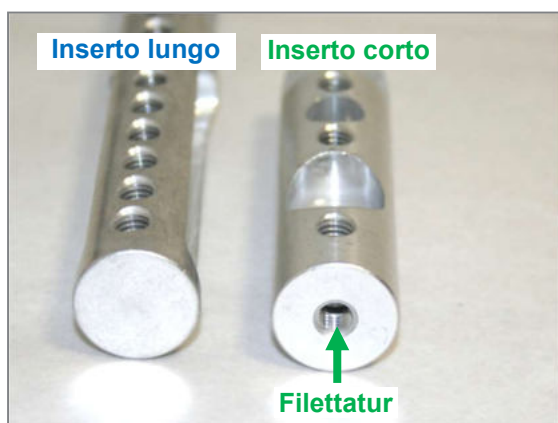
Figura 11: Inserto lungo senza filettatura e inserto corto con filettatura nella superficie frontale
