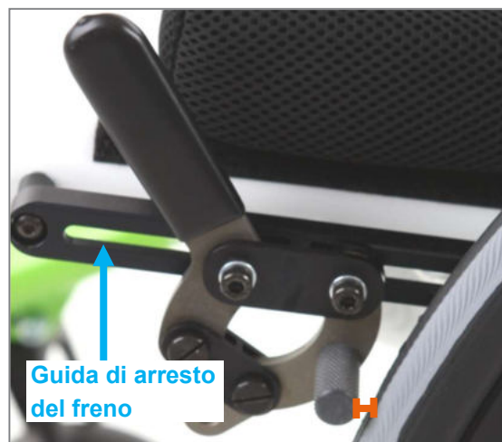
Figura 155: Distanza tra i bulloni del freno e gli pneumatici compresa tra circa 3 e max. 4 mm con il freno aperto
