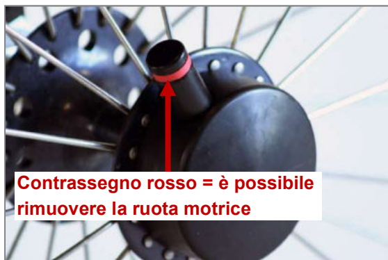
Figura 78: Tetra Clip con asse flottante aperto: è possibile rimuovere la ruota motrice
