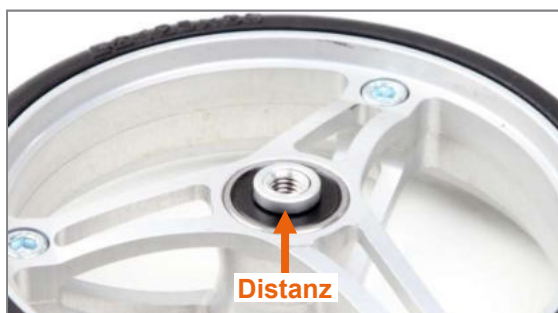
Figura 96: Distanziale sulla ruota sterzante
