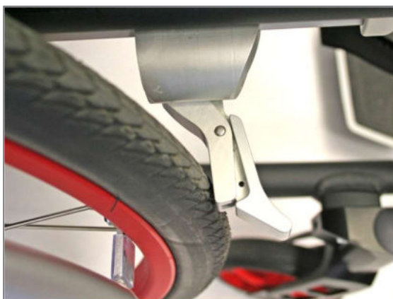
Figura 172: Elemento frenante che poggia sullo pneumatico
