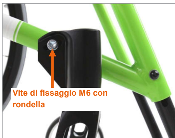
Figura 109: Vite di fissaggio M6 sul lato esterno del prodotto
