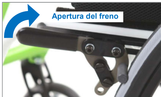
Figura 153: Freno chiuso; l'apertura viene effettuata tirando la leva del freno all'indietro verso l'alto.
