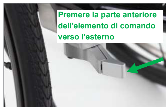
Figura 163: Freno integrale aperto; la chiusura viene effettuata premendo verso il basso l'elemento di comando
