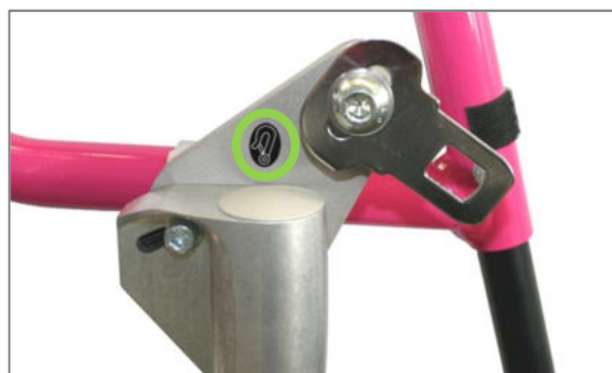
Figura 207: Piastra intermedia blocco cuscinetti ruota sterzante con linguetta fibbia per il retrattore anteriore
