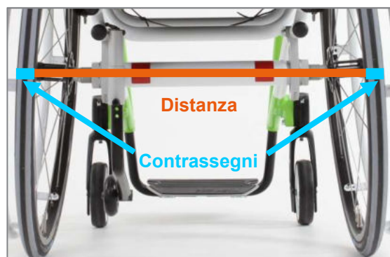
Figura 80: Distanza tra i contrassegni degli pneumatici (ad altezza asse), posteriormente
