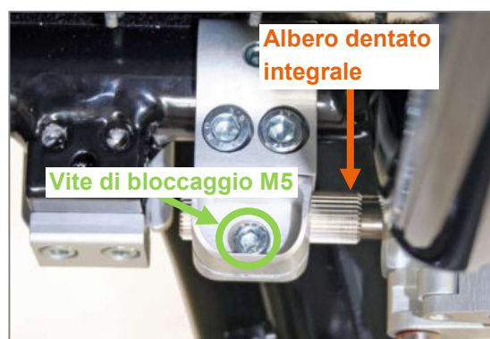
Figura 170: Vite di bloccaggio M5 per lo spostamento del freno integrale con albero dentato integrale nella pinza morsa (vista dal lato interno del prodotto)
