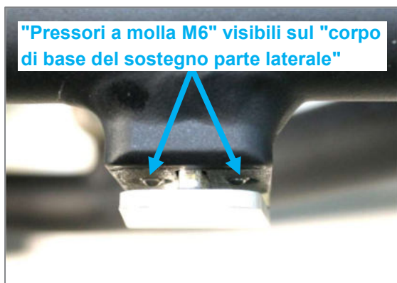
Figura 70: Lato anteriore dei pressori a molla visibile (vista dall'alto)
