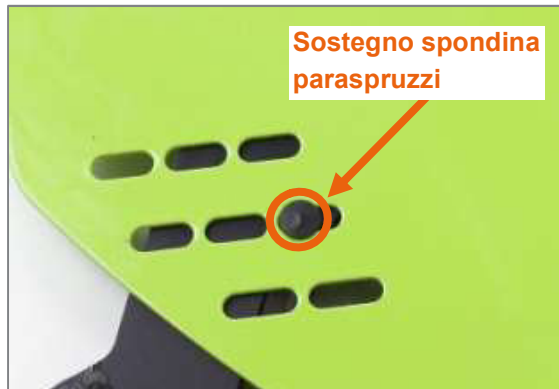
Figura 62: Sostegno spondina paraspruzzi
