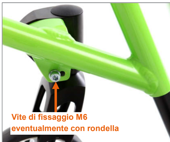
Figura 108: Vite di fissaggio M6 sul lato interno del telaio, rondella presente sui telai a forma di G, ma non sui telai a forma di V
