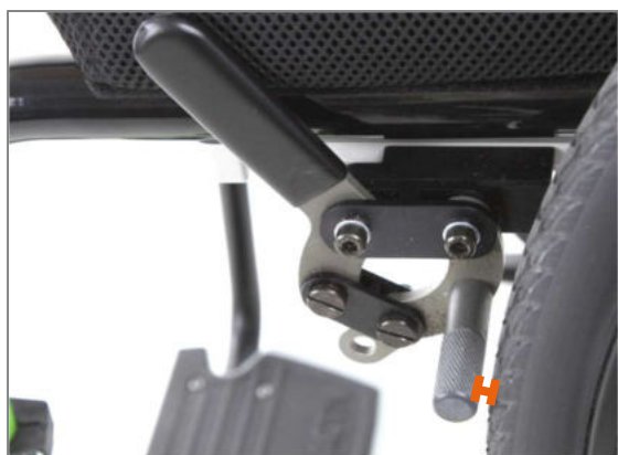
Figura 159: Distanza tra i bulloni del freno e gli pneumatici compresa tra circa 3 e max. 4 mm con il freno aperto
