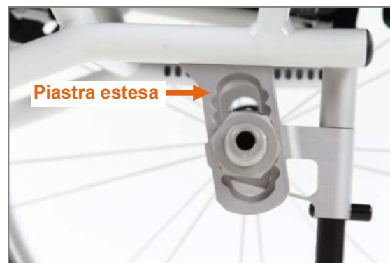
Figura 1: Piastra estesa per una regolazione dell'altezza del sedile posteriore (vista dal lato esterno del prodotto, tolta la ruota motrice)
