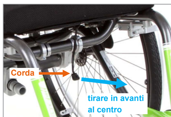
Figura 20: Corda per l'azionamento dei bulloni di bloccaggio e quindi la regolazione dell'angolazione dello schienale
