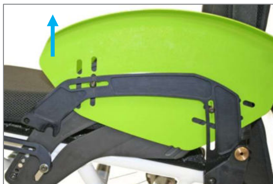
Figura 58: Spondina paraspruzzi tirata anteriormente fuori dalla guida piastra laterale (vista senza ruota motrice)
