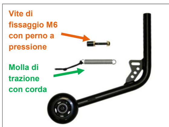
Figura 148: Vite di fissaggio M6 e molla di trazione rimosse dalla staffa supporto antiribaltamento
