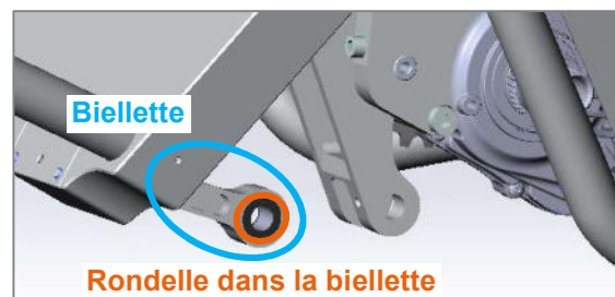
Figure 87 : Biellette avec rondelles retirée du renvoi du bras oscillant
