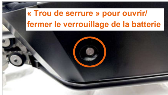
Figure 28 : Trou de serrure de la batterie accessible de l'extérieur par l'ouverture sur la tôle latérale
