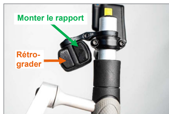
Figure 13 : Bouton pour monter le rapport et rétrograder sur le dérailleur SRAM
