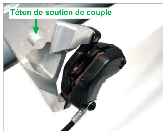
Figure 67 : Pattes à gauche sur moyeu Rohloff
