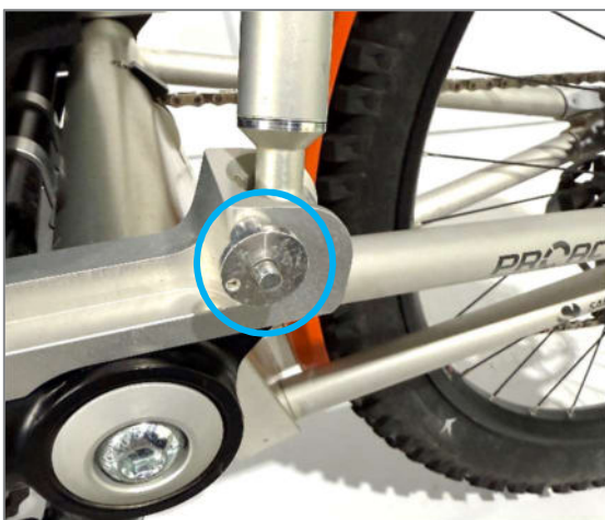
Figure 51 : Quick-Pin du dossier sur le chariot articulé (à gauche)
