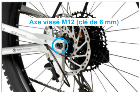
Figure 69 : Axe vissé de la roue d'entraînement
