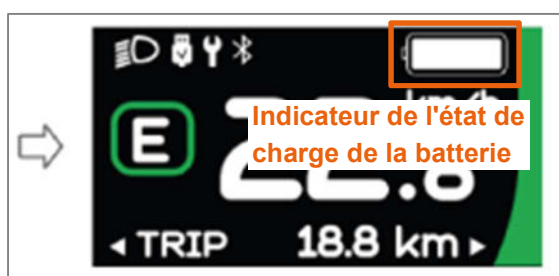
Figure 34 : Indicateur de l'état de charge de la batterie à l'écran
