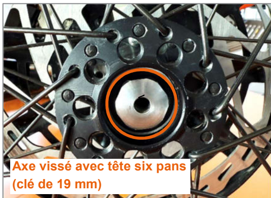
Figure 60 : Moyeu avec axe vissé
