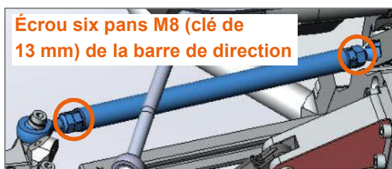
Figure 74 : Écrous six pans M8 sur les barres de direction du bas à droite et à gauche
