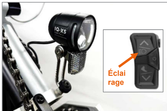
Figure 45 : Éclairage à l'avant via le système de propulsion
