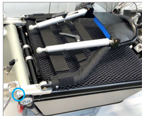
Figure 53 : Dossier replié et Quick-Pins remis en place
