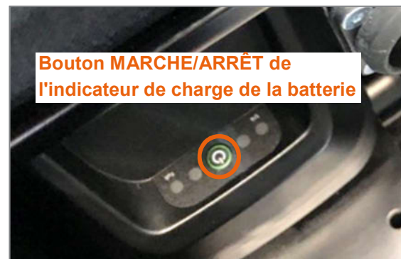
Figure 31 : Bouton MARCHE/ARRÊT de l'indicateur de charge de la batterie
