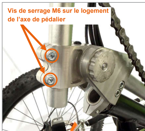
Figure 8 : Vis de serrage M6 pour le réglage en hauteur de la position du pédalier
