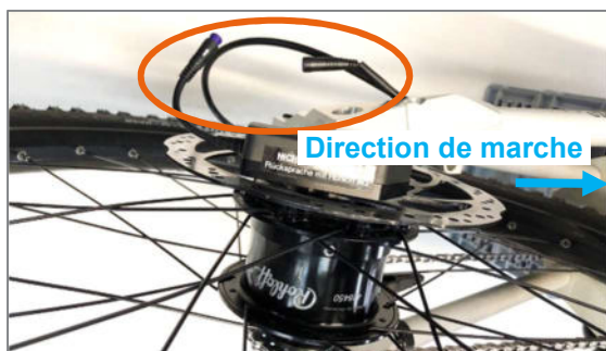
Figure 64 : Connexion à fiche détachée (vue de haut)
