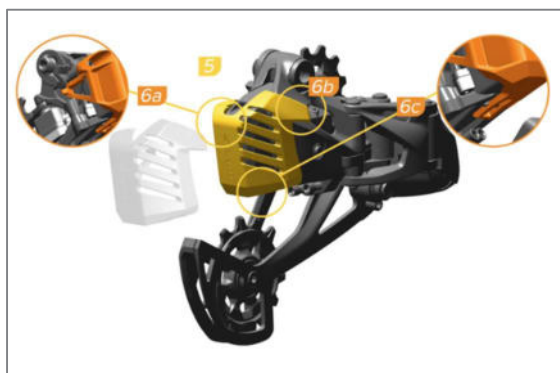
Figure 15 : Retirer la batterie pour la recharger
