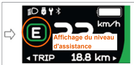
Figure 24 : Affichage avec niveau d'assistance « E » pour Eco (niveau le plus bas)
