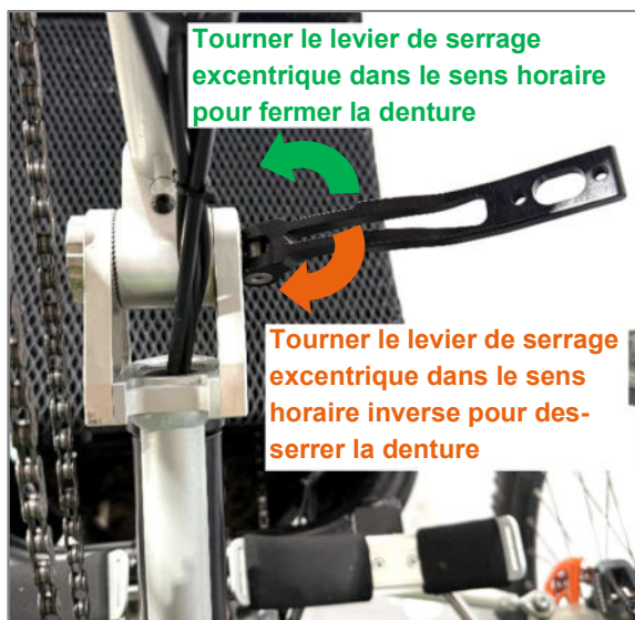
Figure 4 : Desserrer et fermer la denture à l'aide du levier de serrage excentrique
