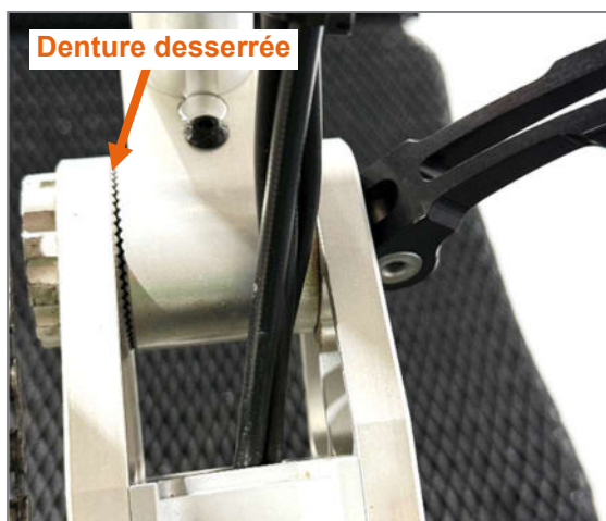
Figure 5 : Levier de serrage excentrique ouvert, denture desserrée
