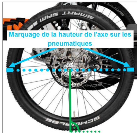
Figure 71 : Marquage de la hauteur de l'axe à l'avant et à l'arrière sur les deux pneumatiques des roues motrices
