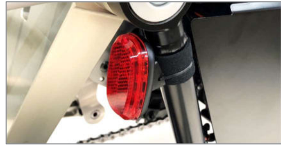
Figure 46 : Éclairage à l'arrière via le système de propulsion
