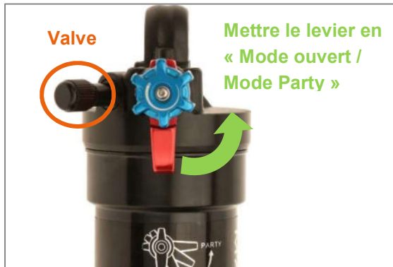
Figure 40 : Position de levier « Mode open/mode party » sur l'amortisseur Manitou Mara Inline
