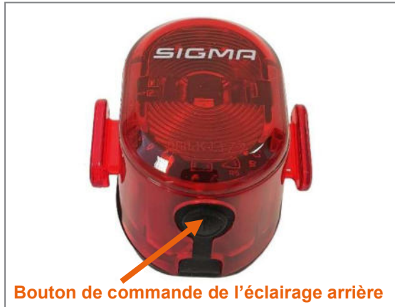
Figure 44 : Bouton de commande de l'éclairage arrière
