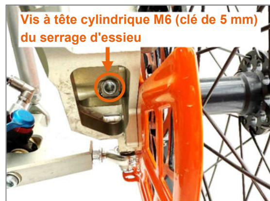
Figure 58 : Serrage d'essieu sur le porte-roue (vue roue motrice droite)
