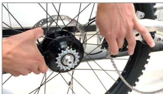
Figure 66 : Chaîne retirée du pignon
