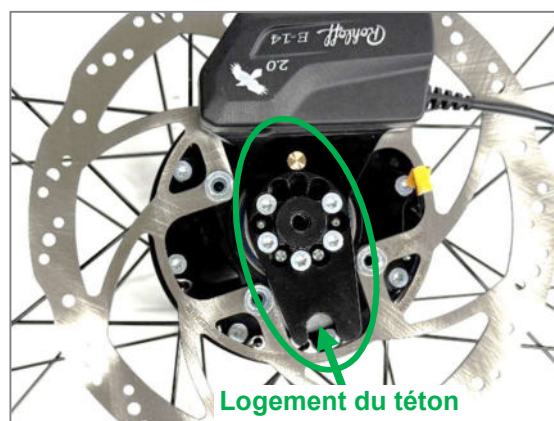
Figure 68 : Logement de couple avec moyeu Rohloff sur la roue d'entraînement (vue intérieure de la roue)
