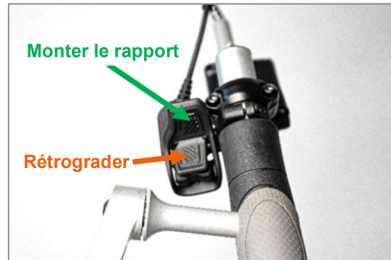
Figure 19 : Boutons pour monter le rapport et rétrograder sur la boîte à vitesses Rohloff
