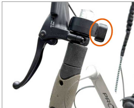
Figure 25 : Levier pour l'assistance au démarrage
