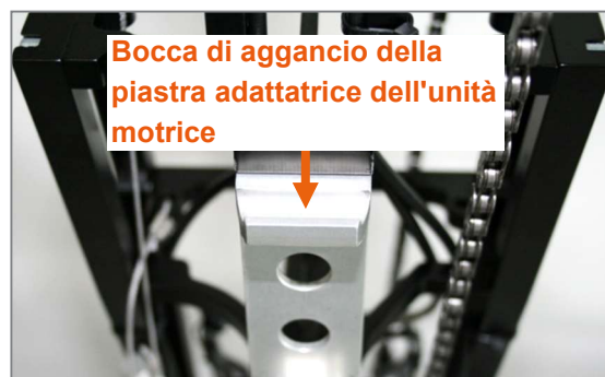
Figura 59: Bocca di aggancio della piastra adattatrice dell'unità motrice
