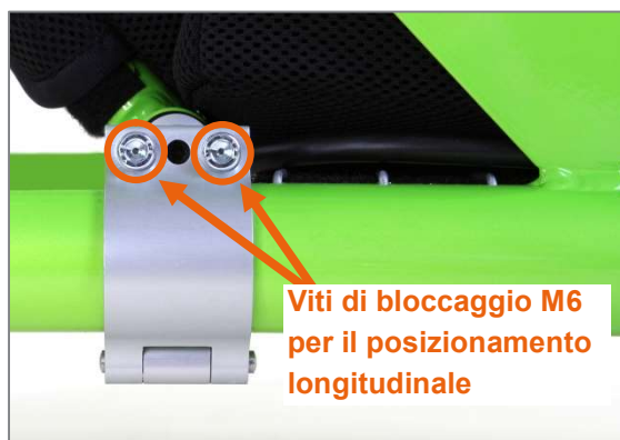
Figura 38: Regolazione longitudinale dello schienale tramite viti di bloccaggio M6 e morsetti di serraggio sul telaio del prodotto
