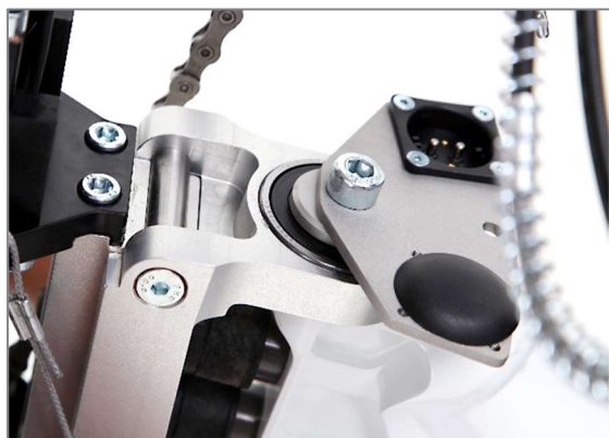
Figura 61: La bocca di aggancio dell'unità motrice scivola sotto l'albero di aggancio sullo chassis
