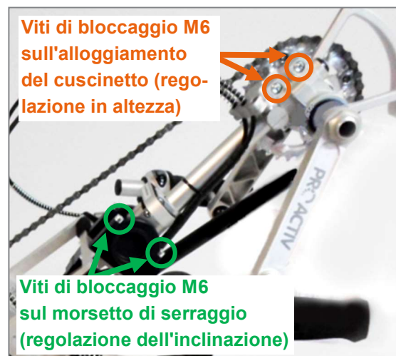
Figura 7: Viti di bloccaggio M6 per la regolazione dell'inclinazione e dell'altezza della posizione del cuscinetto di movimento
