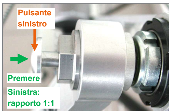
Figura 19: Pulsante sinistro del cambio anteriore integrato
