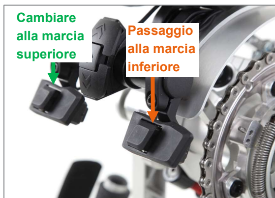
Figura 14: Comando a mento tramite pulsanti
