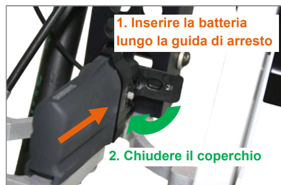
Figura 18: Dopo la ricarica collegare nuovamente la batteria
