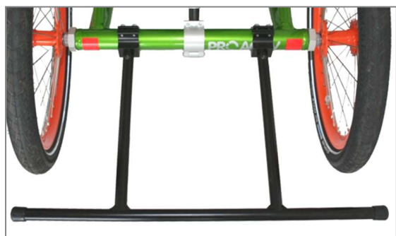
Figura 45: Protezione contro i tamponamenti
