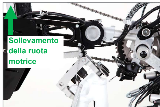
Figura 60: Sollevamento della ruota motrice
