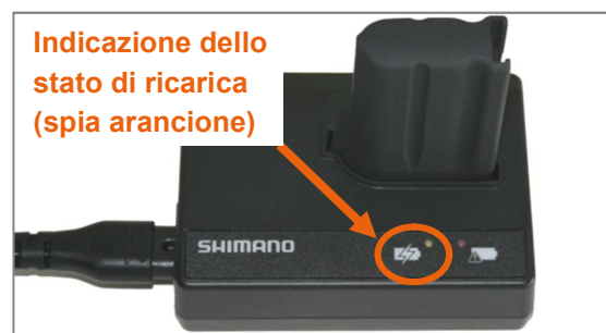
Figura 17: Batteria nel caricabatteria
