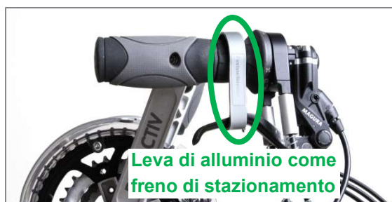
Figura 24: Staffa di alluminio come freno di stazionamento
