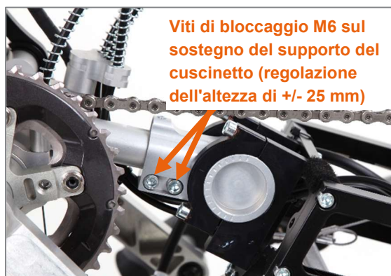
Figura 8: Viti di bloccaggio M6 per la regolazione dell'altezza della posizione del cuscinetto di movimento
