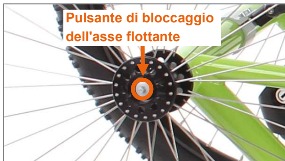
Figura 48: Pulsante di bloccaggio dell'asse flottante al centro dell'asse ruota
