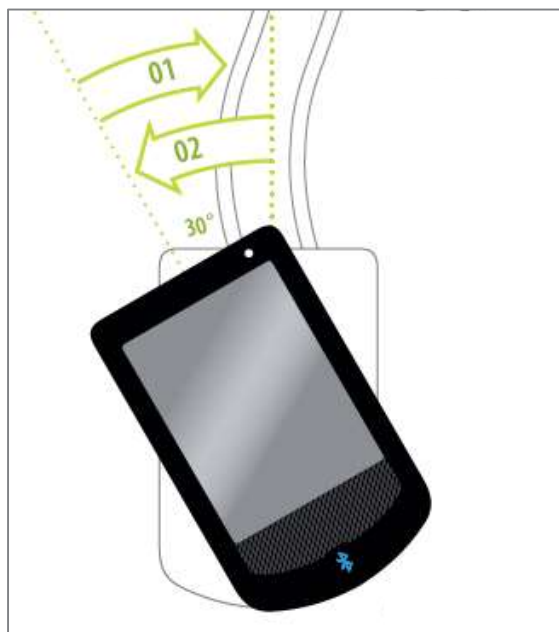
Figura 29: Applicazione e rimozione del display
