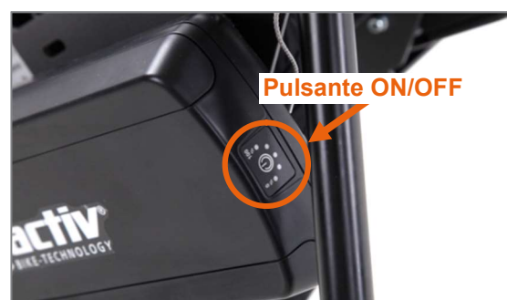
Figura 28: Pulsante di accensione e spegnimento sulla batteria
