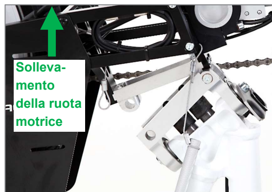
Figura 70: Sollevamento della ruota motrice
