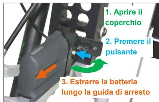
Figura 16: Rimuovere la batteria per la ricarica
