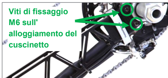
Figura 6: Viti di fissaggio M6 sull'alloggiamento del cuscinetto
