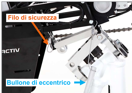
Figura 62: Bocca di aggancio dell'unità motrice sull'albero di aggancio sullo chassis, bullone di eccentrico non ancora inserito
