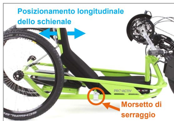
Figura 37: Morsetto di serraggio per il posizionamento longitudinale dello schienale
