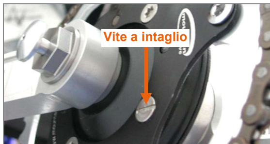
Figura 20: Vite a intaglio da ingrassare
