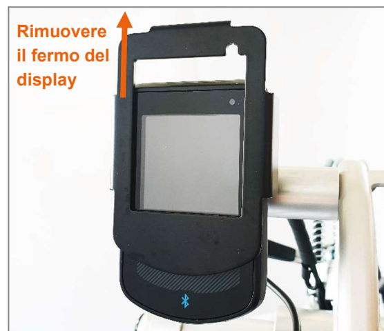
Figura 31: Rimozione del fermo del display
