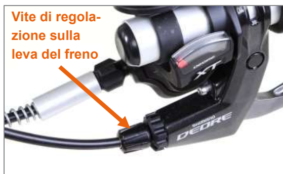
Figura 23: Vite di regolazione sulla leva del freno
