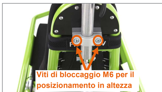
Figura 41: Regolazione in altezza del supporto nuca tramite due viti di bloccaggio M6 sul tubo di supporto del supporto nuca
