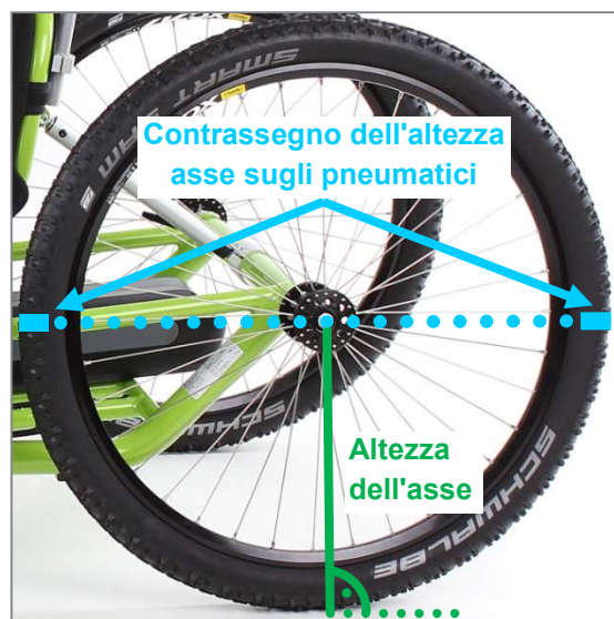
Figura 50: Contrassegno dell'altezza asse anteriormente e posteriormente su entrambi gli pneumatici delle ruote
