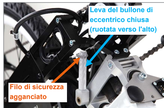
Figura 65: Unità motrice completamente adattata
