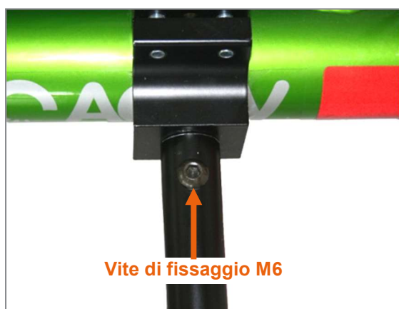
Figura 46: Vite di fissaggio M6 sui morsetti di serraggio sul tubo asse
