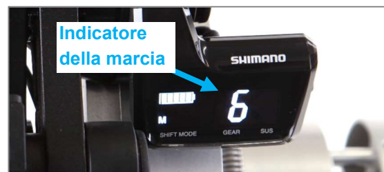
Figura 13: Indicatore della marcia attualmente inserita sul display
