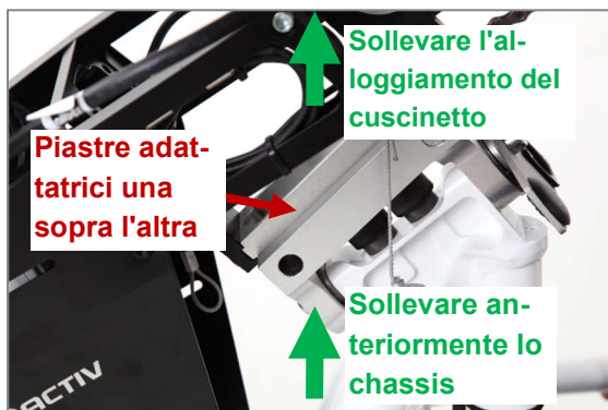
Figura 63: Piastre adattatrici di unità motrice e chassis una sopra l'altra
