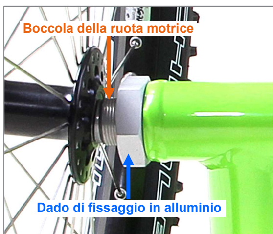
Figura 52: Boccia della ruota motrice e dado di fissaggio in alluminio (vista posteriore)
