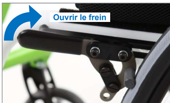
Figure 133 : Frein fermé, l'ouverture s'effectue en tirant le levier de frein vers l'arrière en haut
