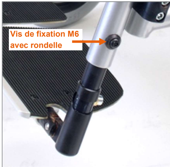
Figure 119 : Vis de fixation M6 avec rondelle pour le réglage de la longueur de la potence
