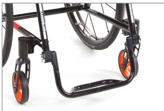
Figure 103 : Repose-pieds pliable en arrière vers le haut, en position standard
