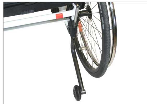
Figure 121 : Position de service des roulettes anti-bascule (vue arrière)
