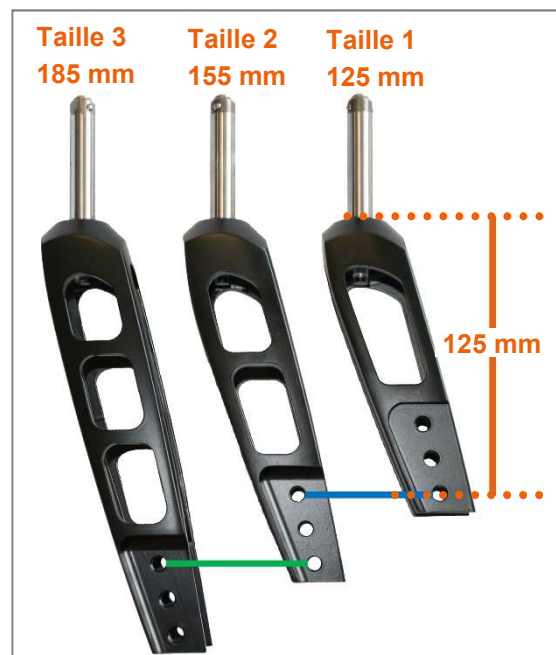
Figure 14 : Tailles de fourche de roue avant avec identification des réglages identiques de hauteur d'assise pour les différentes tailles de fourche de roue avant
