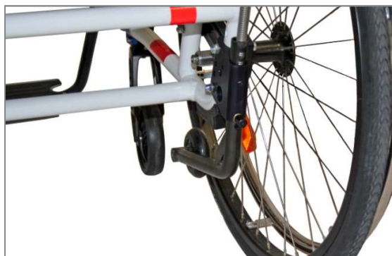
Figure 122 : Position passive des roulettes anti-bascule (vue arrière)
