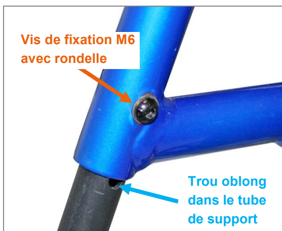
Figure 96 : Vis de fixation M6 avec rondelle et trou oblong dans le tube de support du repose-pieds pour le réglage de la longueur de potence
