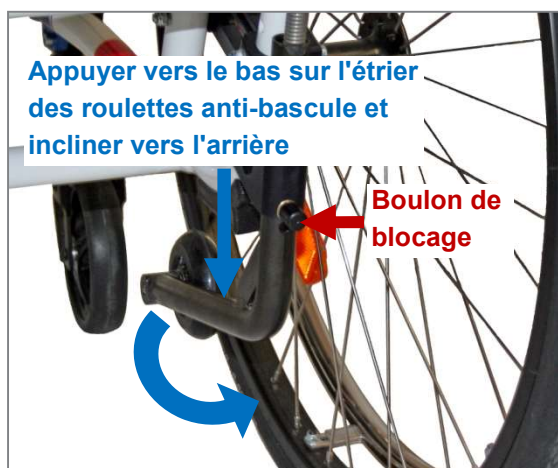
Figure 123 : Mettre les roulettes anti-bascule en position de service (vue arrière)
