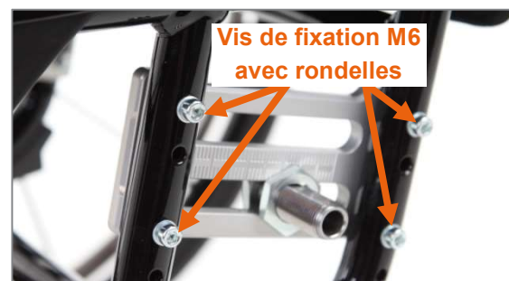
Figure 7 : Vis de fixation M6 de la plaque de roue
