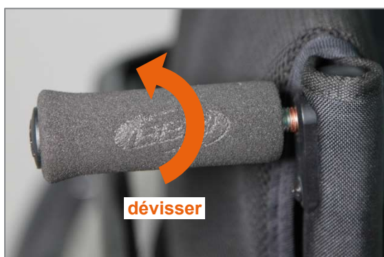
Figure 143 : Dévisser la poignée de poussée horizontalement du tube dorsal
