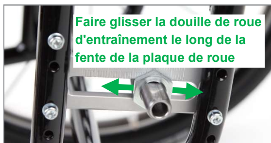
Figure 18 : Faire glisser la douille de roue d'entraînement le long de la fente de la plaque de roue (vue du côté extérieur du produit)
