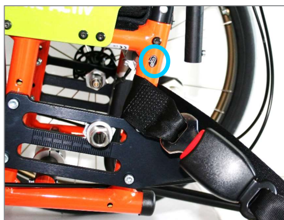
Figure 159 : Symbole pour la fixation arrière et la boucle du fauteuil roulant à l'arrière
