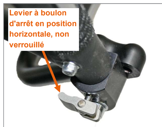
Figure 105 : Levier à boulon d'arrêt en position horizontale, non verrouillé et par conséquent ne reposant pas sur l'articulation du repose-pieds
