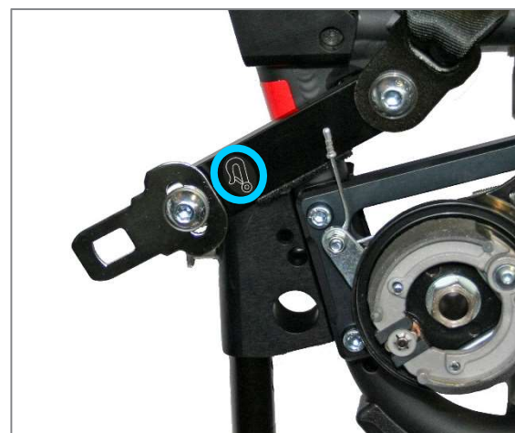
Figure 154 : Attache d'ancrage sur le châssis arrière avec la languette pour le rétracteur arrière et la ceinture ventrale
