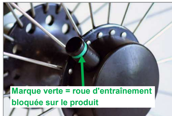
Figure 65 : Tetra-Clip avec axe de démontage rapide bloqué
