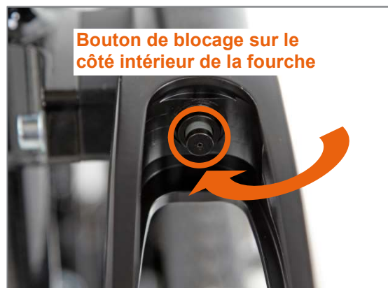
Figure 89 : Fourche de roue avant avec axe à démontage rapide et bouton de blocage
