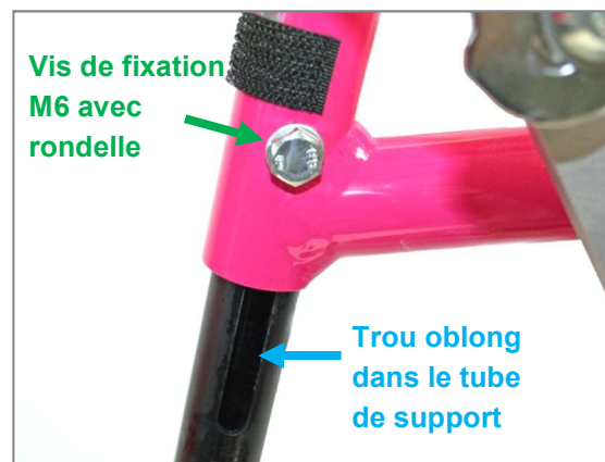
Figure 114 : Vis de fixation M6 avec rondelle et trou oblong dans le tube de support du repose-pieds pour le réglage de la longueur de potence
