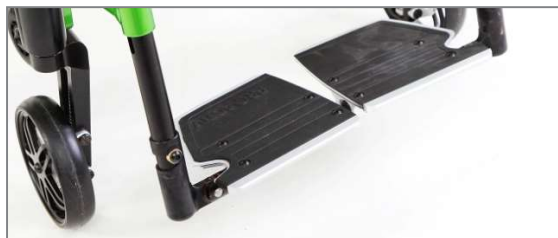
Figure 112 : Repose-pieds séparé au centre, en position standard
