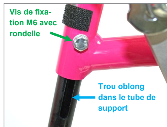
Figure 102 : Vis de fixation M6 avec rondelle et trou oblong dans le tube de support du repose-pieds pour le réglage de la longueur de potence
