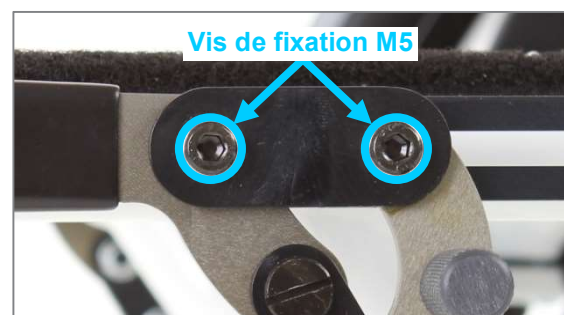
Figure 134 : Vis de fixation M5 sur rail de fixation de frein
