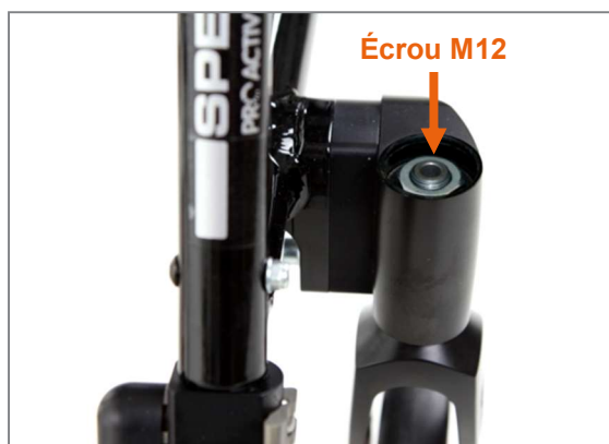
Figure 88 : Capot en aluminium retiré et écrou M12 visible
