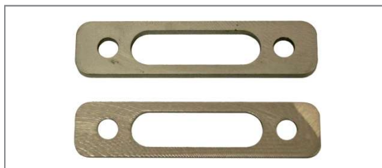
Figure 67 : Deux entretoises d'alignement des roues avec une épaisseur de matière différente
