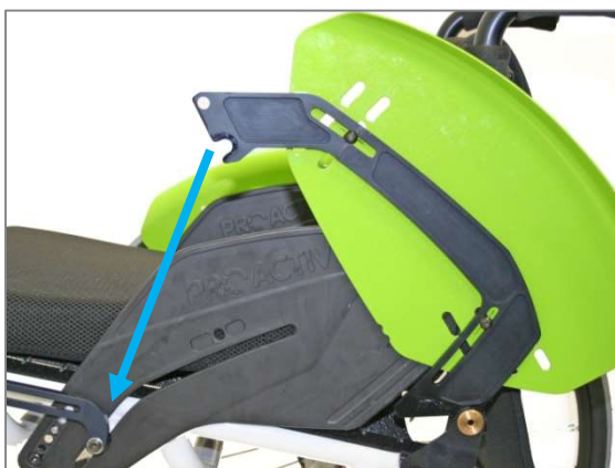
Figure 56 : Étrier de prise inséré sur l'arbre à cardan de dossier (vue sans roue d'entraînement)
