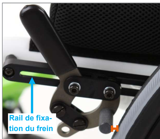
Figure 135 : Écart entre les patins de frein et les pneus d'env. 3 mm à 4 mm maximum lorsque le frein est ouvert
