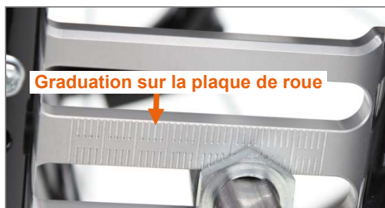
Figure 19 : Graduation sur la plaque de roue
