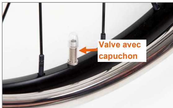
Figure 71 : Valve avec capuchon
