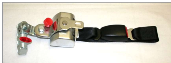
Figure 148 : Rétracteur avant « semi-automatique » avec fermeture et languette de fermeture
