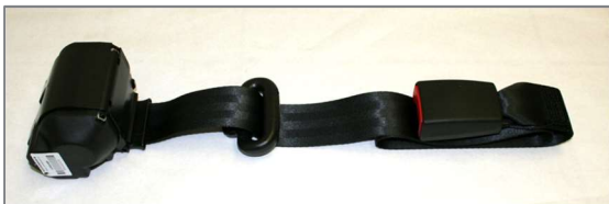
Figure 151 : Ceinture oblique d'épaule automatique avec renvoi et fermeture
