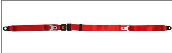
Figure 150 : Ceinture ventrale avec fermeture, les ferrures de fixation pour l'attache sur les ancrages et les deux languettes de fermeture pour la fixation au choix de la ceinture oblique d'épaule
