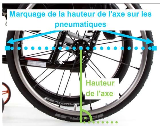
Figure 68 : Marquage de la hauteur de l'axe à l'avant et à l'arrière sur les deux pneumatiques
