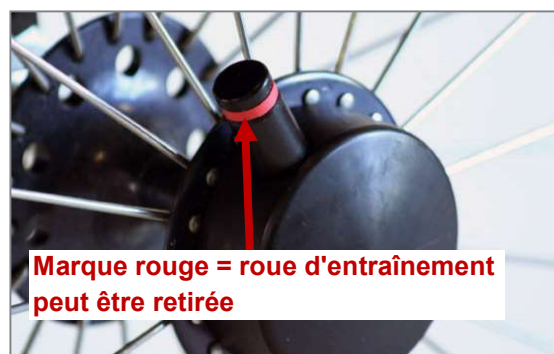
Figure 66 : Tetra-Clip avec axe de démontage rapide ouvert, la roue d'entraînement peut être retirée
