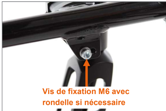
Figure 92 : Vis de fixation M6 sur le côté intérieur du châssis, rondelle présente sur châssis à forme G, absente sur châssis à forme V
