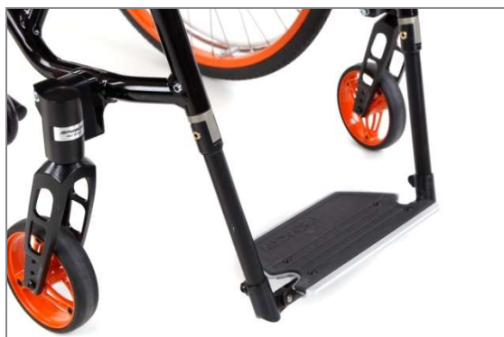
Figure 109 : Repose-pieds pliable en arrière vers le haut, avec mécanisme d'enclenchement à ressort, en position standard
