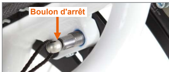
Figure 20 : Boulon d'arrêt relié avec la corde (vue du côté intérieur du produit)
