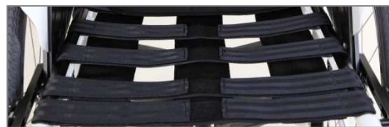
Figure 47 : Système ouvert avec bandes Velcro pour le réglage de la flèche
