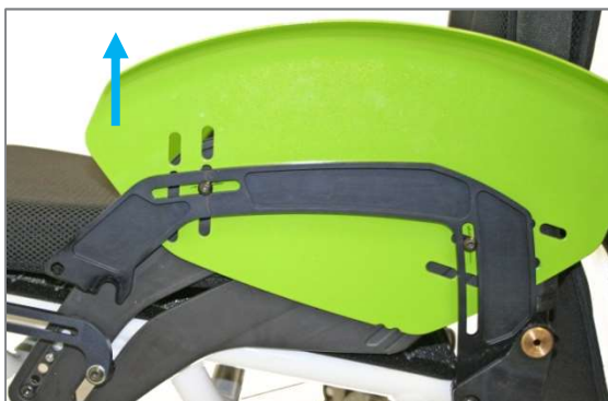
Figure 55 : Protège-vêtements tiré vers l'avant en dehors du guidage de tôle latérale (vue sans roue d'entraînement)
