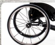
È possibile scegliere tra un'estensione del passo saldata in modo permanente o rimovibile per una maggiore trazione con una handbike o un dispositivo di traino.
