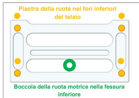
Figura 11: Esempio di posizione iniziale per la regolazione
