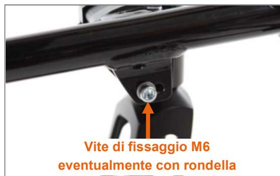
Figura 92: Vite di fissaggio M6 sul lato interno del telaio, rondella presente sui telai a forma di G, ma non sui telai a forma di V
