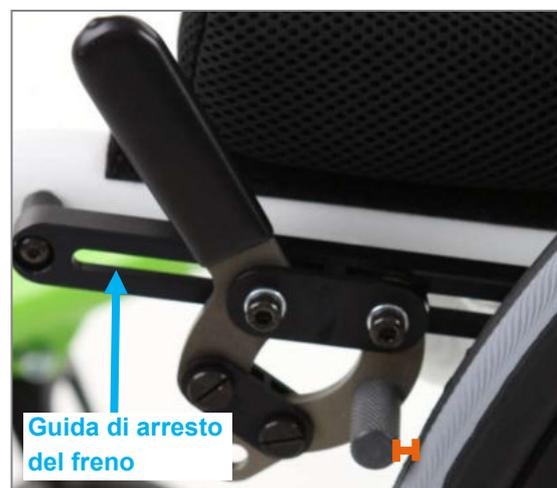
Figura 135: Distanza tra i bulloni del freno e gli pneumatici compresa tra circa 3 e max. 4 mm con il freno aperto
