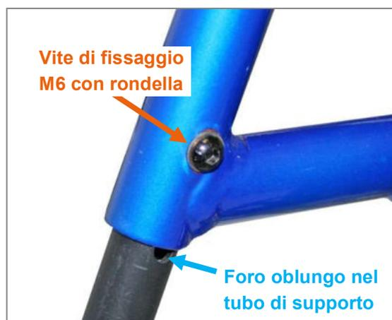
Figura 96: Vite di fissaggio M6 con rondella e foro oblunco nel tubo di supporto poggiapiedi per la regolazione della lunghezza della gamba
