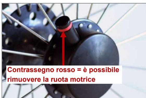
Figura 66: Tetra Clip con asse flottante aperto: è possibile rimuovere la ruota motrice
