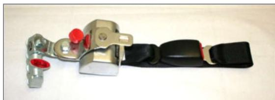
Figura 148: Retrattore anteriore "Semiautomatico" con fibbia di chiusura e linguetta fibbia
