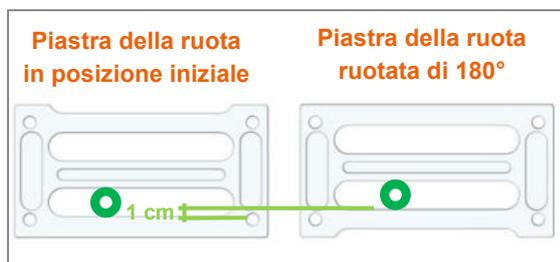
Figura 6: Modifica dell'altezza del sedile posteriore ruotando la piastra della ruota di 180°
