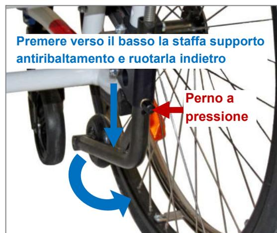
Figura 123: Portare il supporto antiribaltamento in posizione attiva (vista posteriore)
