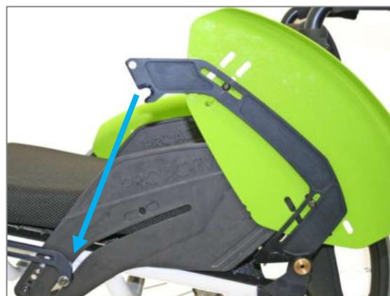
Figura 56: Staffa di sostegno inserita sull'albero snodato schienale (vista senza ruota motrice)
