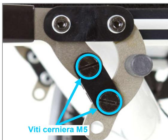
Figura 136: Viti cerniera M5 per la regolazione della forza di azionamento della leva del freno
