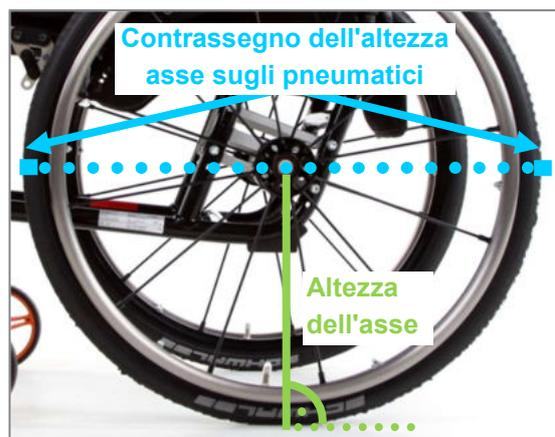
Figura 68: Contrassegno dell'altezza asse anteriormente e posteriormente su entrambi gli pneumatici
