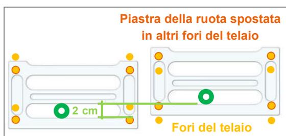
Figura 9: Modifica dell'altezza del sedile posteriore spostando la piastra della ruota nei fori del telaio
