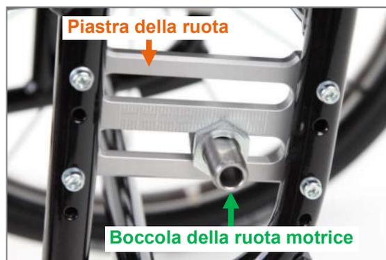
Figura 15: Piastra della ruota e boccola della ruota motrice (vista dal lato esterno del prodotto, ruota motrice rimossa)
