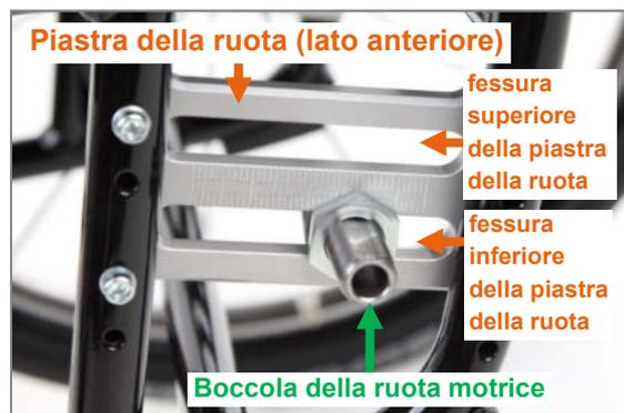
Figura 1: Piastra della ruota con 2 fessure per una regolazione dell'altezza del sedile posteriore (vista dal lato esterno del prodotto, ruota motrice rimossa)
