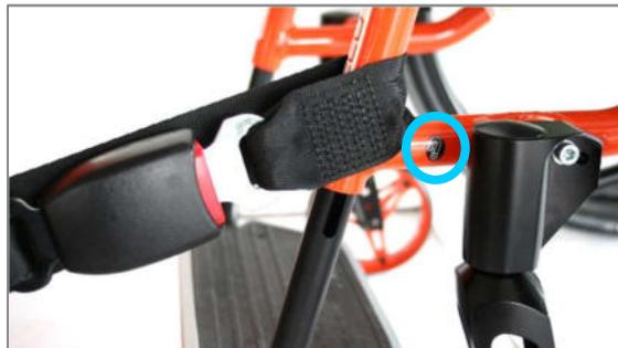
Figura 158: Simbolo del fissaggio anteriore e con occhielli della carrozzina sul davanti
