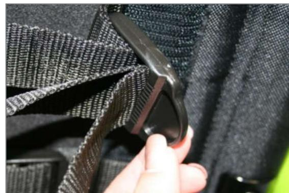
Figura 36: Passaggio 5: Rientro della cinghia attraverso l'occhiello di tensionamento per ottenere la "doppia guida" necessaria
