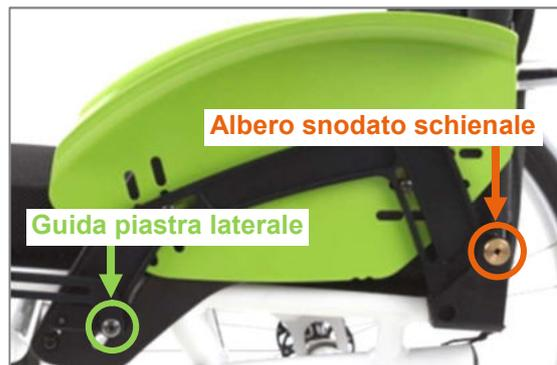
Figura 50: Spondina paraspruzzi applicata sul prodotto (vista senza ruota motrice)
