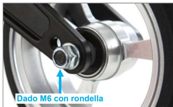
Figura 82: Dado M6 dell'asse ruota sterzante (vista dal lato interno del prodotto)
