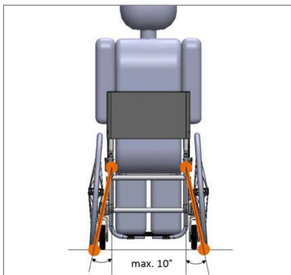
Figura 163: Andamento dei retractori posteriormente con angolazione di ancoraggio massima e punti di collegamento (vista posteriore)
