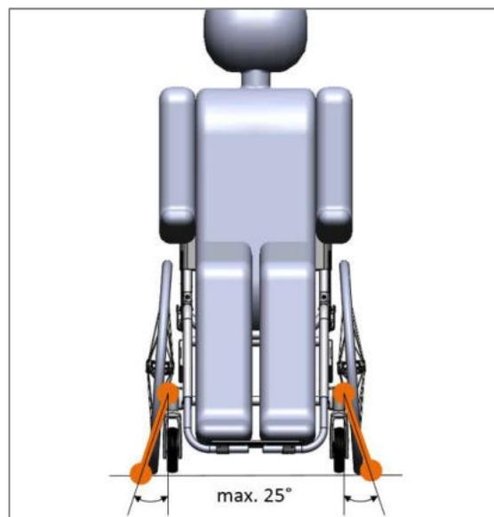
Figura 164: Andamento dei retractori anteriormente con angolazione di ancoraggio massima e punti di collegamento (vista anteriore)
