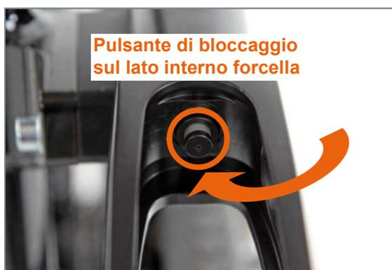
Figura 89: Forcella ruota sterzante con asse flottante e pulsante di bloccaggio
