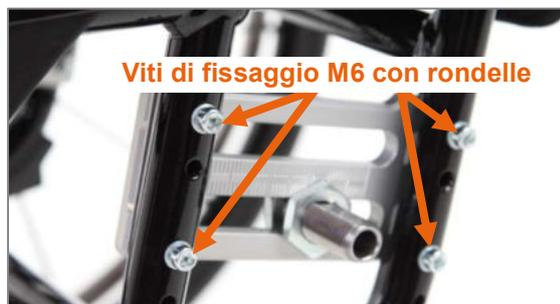
Figura 7: Viti di fissaggio M6 della piastra della ruota
