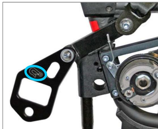
Figura 155: Collegamento del sistema di bloccaggio sul telaio posteriore con occhiello per cinghia per il retrattore posteriore e cinghia di sicurezza
