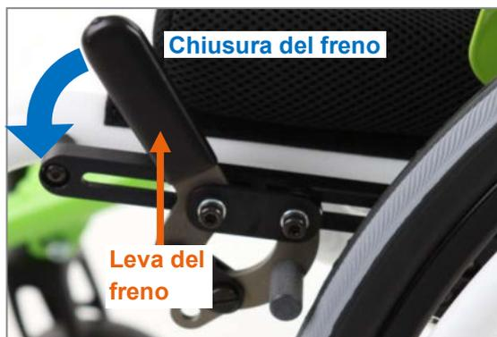
Figura 132: Freno aperto; la chiusura viene effettuata premendo in avanti verso il basso la leva del freno
