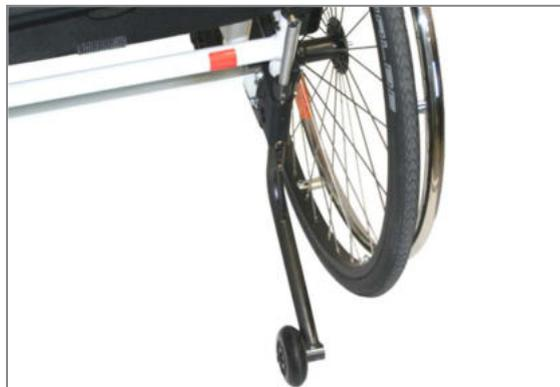
Figura 121: Posizione attiva del supporto antiribaltamento (vista posteriore)
