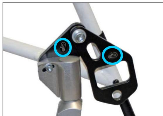
Figura 157: Piastra intermedia blocco cuscinetti ruota sterzante con occhiello per cinghia per il retrattore anteriore
