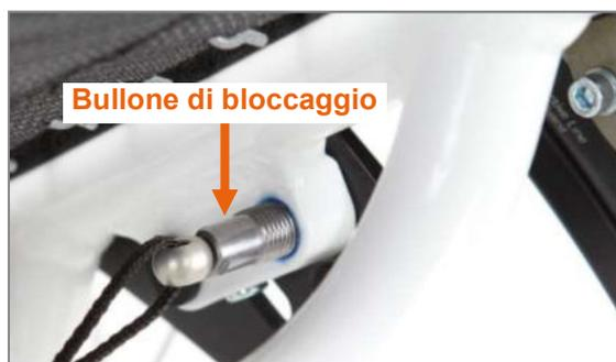
Figura 53: Bullone di bloccaggio collegato con la corda (vista dal lato interno del prodotto)
