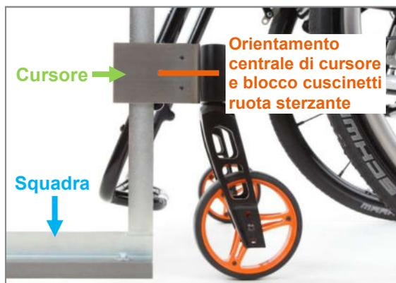
Figura 90: Verifica della regolazione degli assi di rotazione della forcella della ruota sterzante
