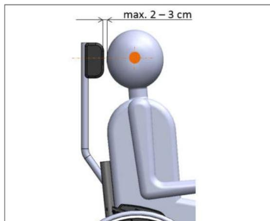
Figura 166: Regolazione dell'altezza e della distanza dalla testa del poggiatesta
