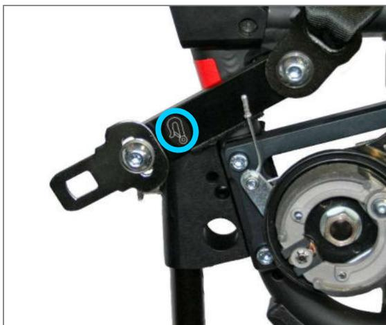
Figura 154: Collegamento del sistema di bloccaggio sul telaio posteriore con linguetta fibbia per il retrattore posteriore e cinghia di sicurezza
