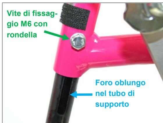
Figura 102: Vite di fissaggio M6 con rondella e foro oblungo nel tubo di supporto poggiatesta per la regolazione della lunghezza della gamba
