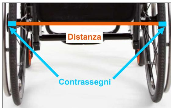
Figura 69: Distanza tra i contrassegni degli pneumatici (ad altezza asse), posteriormente
