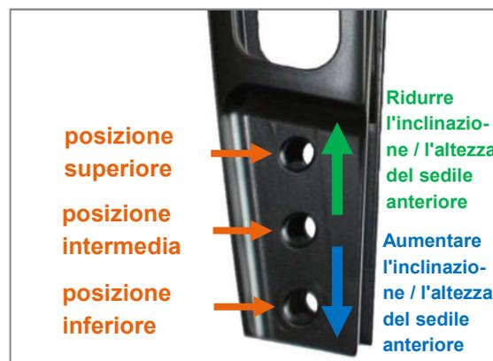
Figura 13: Tre posizioni nella forcella della ruota sterzante per il posizionamento della ruota sterzante ed effetto sull'altezza del sedile anteriore
