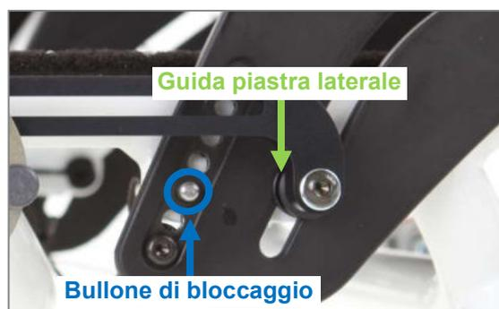
Figura 51: Il bullone di bloccaggio fa presa nel foro di bloccaggio della parte laterale (vista senza spondina paraspruzzi)
