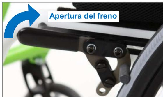
Figura 133: Freno chiuso; l'apertura viene effettuata tirando la leva del freno all'indietro verso l'alto.
