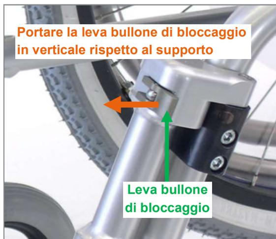
Figura 117: Posizionare in verticale la leva bullone di bloccaggio per la rimozione del poggiatesta Swing away
