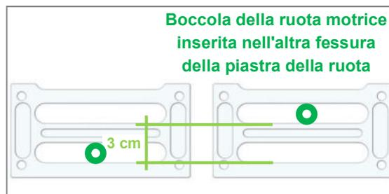
Figura 3: Modifica dell'altezza del sedile posteriore spostando la boccola della ruota motrice nelle fessure della piastra della ruota
