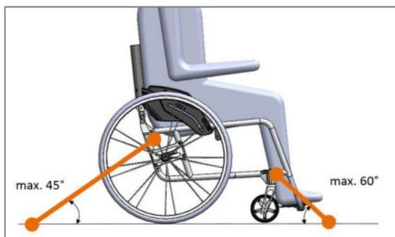
Figura 162: Andamento dei retractori anteriormente e posteriormente con angolazione di ancoraggio massima e punti di collegamento (vista dal lato)
