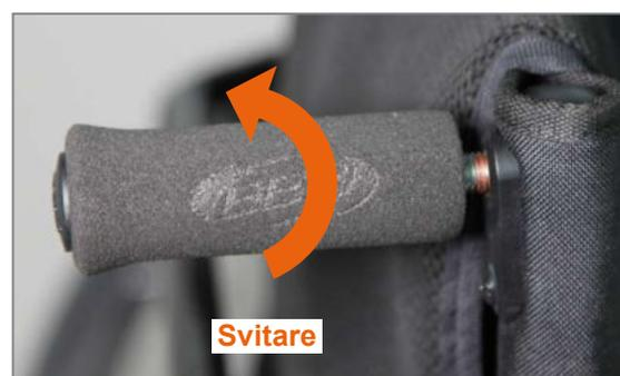
Figura 143: Svitare la maniglia di spinta in orizzontale dal tubo dello schienale
