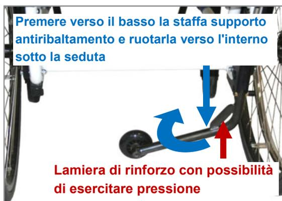
Figura 125: Portare il supporto antiribaltamento in posizione passiva (vista posteriore)
