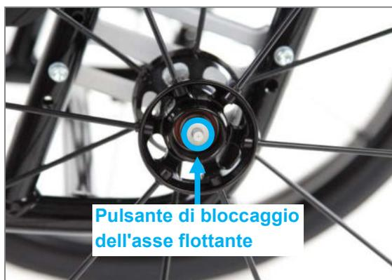
**Pulsante di bloccaggio dell'asse flottante**
