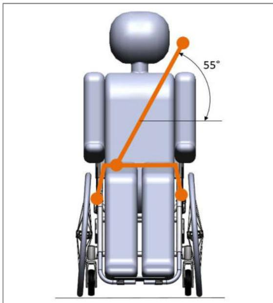
Figura 165: Andamento della cinghia di sicurezza e della cinghia trasversale con i relativi punti di collegamento (vista anteriore)
