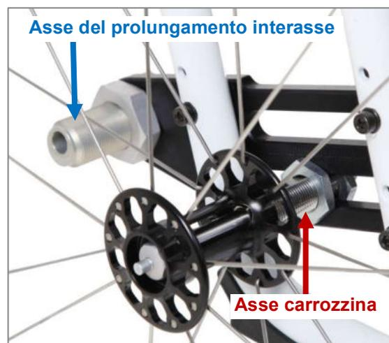
Figura 76: Prolungamento interasse mediante piastra della ruota estesa
