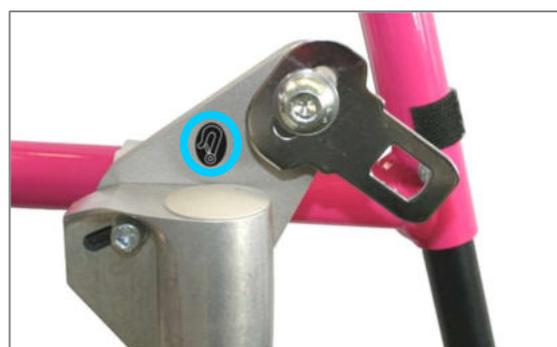
Figura 156: Piastra intermedia blocco cuscinetti ruota sterzante con linguetta fibbia per il retrattore anteriore
