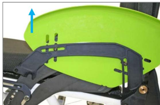
Figura 55: Spondina paraspruzzi tirata anteriormente fuori dalla guida piastra laterale (vista senza ruota motrice)
