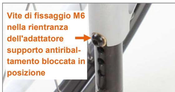
Figura 124: Supporto antiribaltamento bloccata correttamente in posizione
