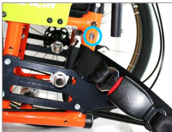
Figura 159: Simbolo del fissaggio posteriore e con occhielli della carrozzina sul dietro
