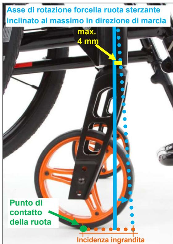
Figura 86: Ingrandimento dell'incidenza tramite inclinazione dell'asse di rotazione della forcella ruota sterzante
