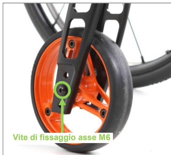
Figura 78: Vite di fissaggio M6 dell'asse ruota sterzante (vista dal lato esterno del prodotto)
