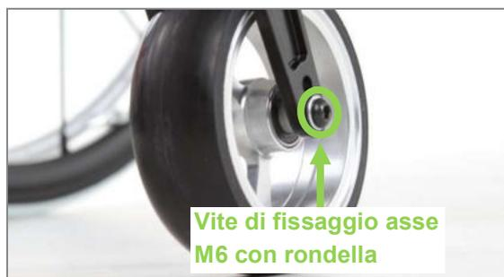
Figura 81: Vite di fissaggio M6 dell'asse ruota sterzante (vista dal lato esterno del prodotto)
