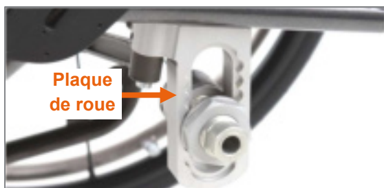
Figure 6 : Plaque de roue pour le réglage de la hauteur d'assise à l'arrière (roue d'entraînement enlevée)
