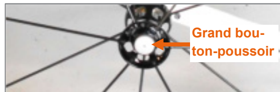
Figure 69 : Axe à démontage rapide avec assistance à la manipulation, grand bouton-poussoir
