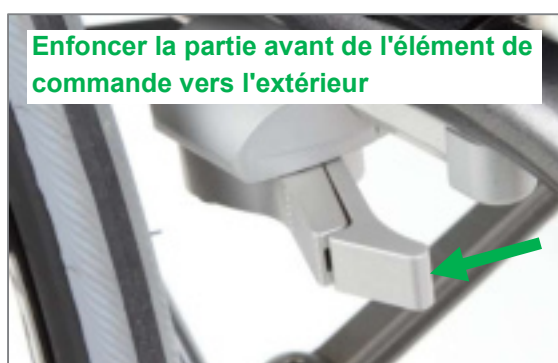
Figure 151 : Frein intégral ouvert, la fermeture s'effectue en enfonçant vers l'extérieur l'élément de commande
