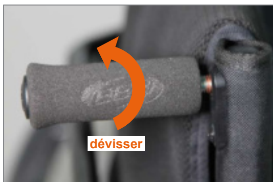
Figure 165 : Dévisser la poignée de poussée horizontalement du tube dorsal
