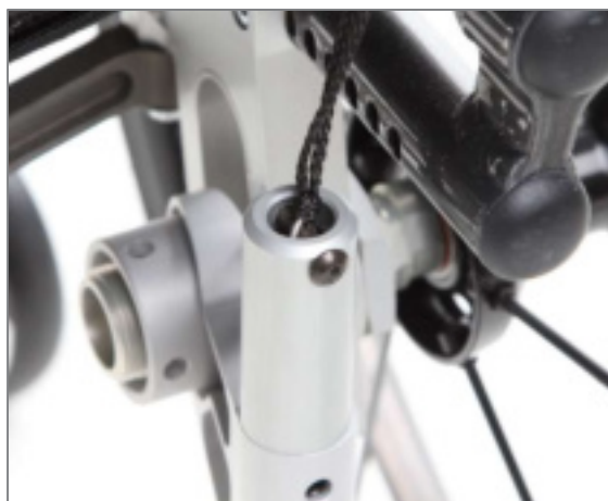
Figure 139 : Vis de fixation M5 vissée dans l'anneau d'extrémité du ressort de traction
