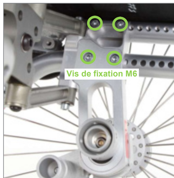
Figure 15 : Vis de fixation M6 de la plaque de roue (vue du côté intérieur du produit)
