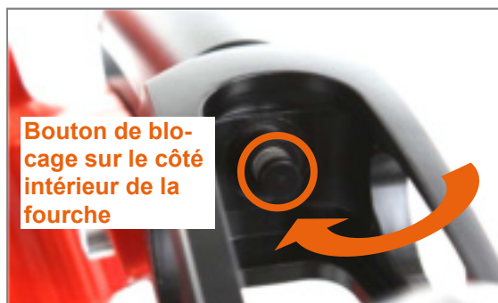
Figure 98 : Fourche de roue avant avec axe à démontage rapide et bouton de blocage
