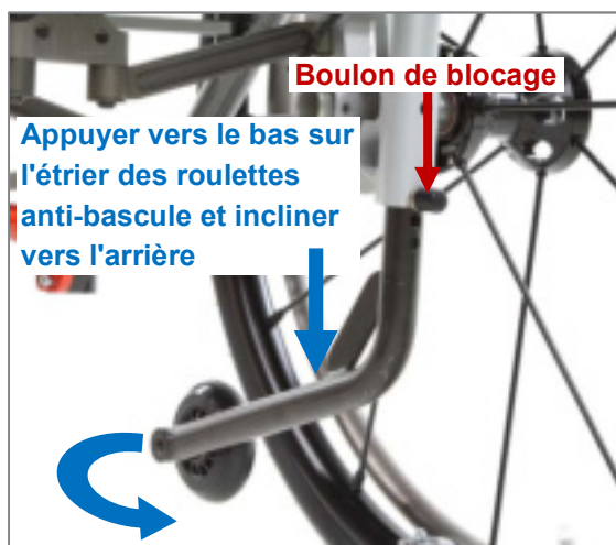
Figure 132 : Mettre les roulettes anti-basculer en position de service (vue arrière)
