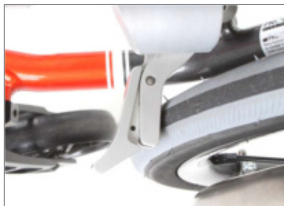
Figure 156 : Élément de frein reposant sur le pneu
