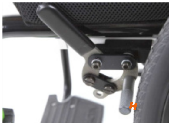
Figure 147 : Écart entre les patins de frein et les pneus d'env. 3 à 4 mm maximum lorsque le frein est ouvert
