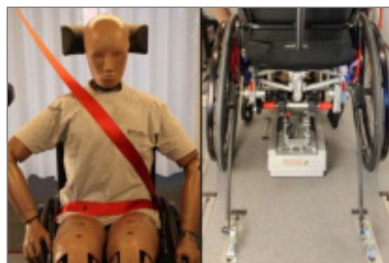
Figure 195 : Les ceintures de retenue doivent être en contact total avec l'épaule, la poitrine et le bassin. Les ceintures pelviennes doivent être positionnées bas sur le bassin, près de la jonction entre la cuisse et l'abdomen
