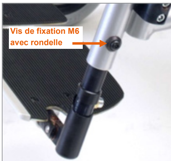
Figure 128 : Vis de fixation M6 avec rondelle pour le réglage de la longueur de la potence
