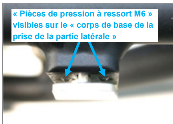
Figure 63 : Côté avant des pièces de pression à ressort visible (vue du haut)
