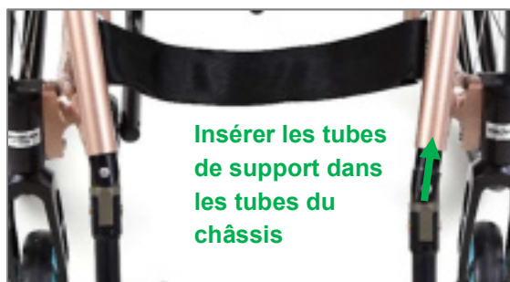
Figure 106 : Insérer les tubes de support dans les tubes du châssis jusqu'à ce que le repose-pieds s'enclenche avec un bruit audible
