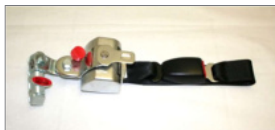
Figure 170 : Rétracteur avant « semi-automatique » avec fermeture et languette de fermeture
