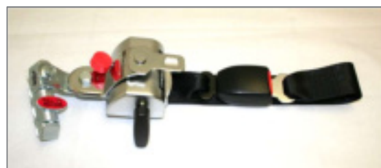
Figure 171 : Rétracteur arrière « semi-automatique » avec poignée de serrage, fermeture et languette de fermeture
