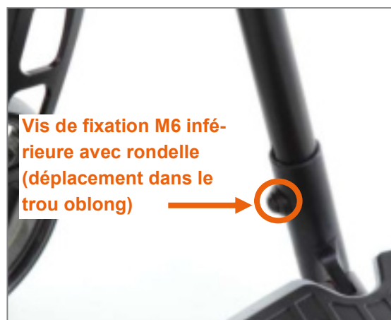
Figure 109 : La vis de fixation M6 inférieure peut être positionnée dans le trou oblong
