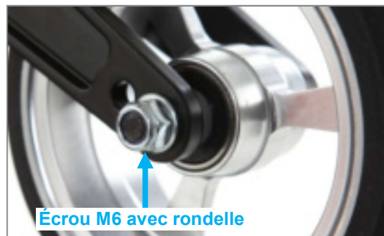
Figure 91 : Écrou M6 de l'axe de la roue avant (vue du côté intérieur du produit)
