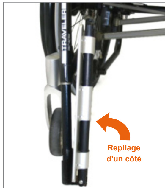
Figure 113 : Repose-pieds rabattu d'un côté (vue du produit de l'avant)
