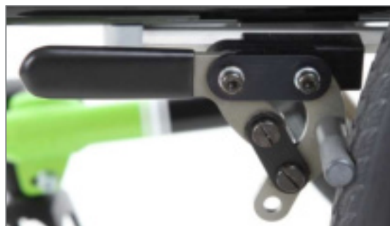
Figure 143 : Système de frein à pousser avec levier de frein standard
