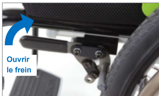
Figure 145 : Frein fermé, l'ouverture s'effectue en tirant le levier de frein vers l'arrière en haut
