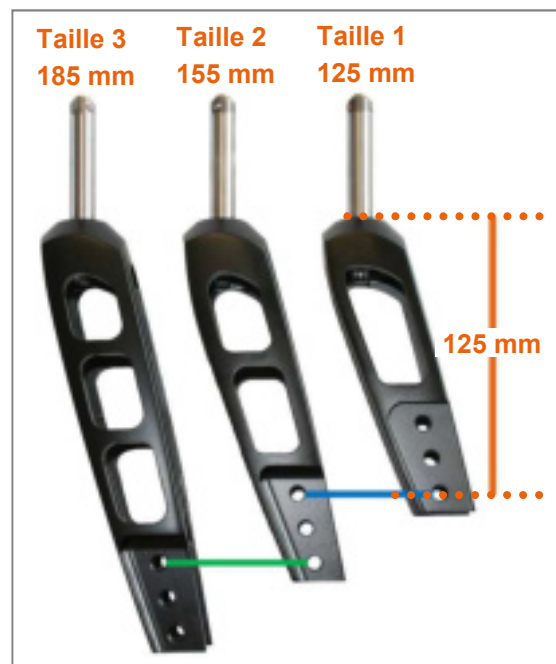
Figure 13 : Tailles de fourche de roue avant avec identification des réglages identiques de hauteur d'assise pour les différentes tailles de fourche de roue avant
