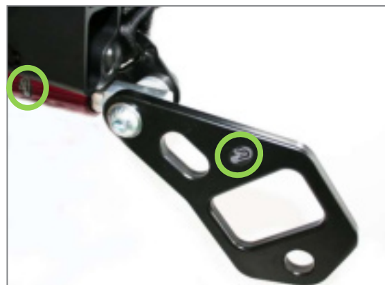
Figure 178 : Attache d'ancrage sur le châssis arrière avec oeillet de ceinture pour le rétracteur arrière et la ceinture ventrale
