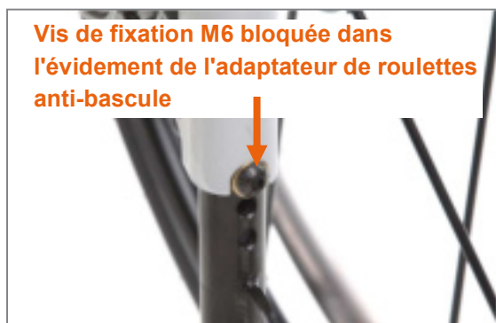
Figure 133 : Roulettes anti-basculer enclenchées correctement
