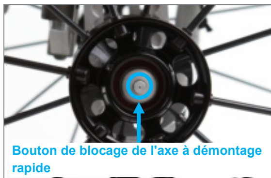
Figure 67 : Bouton de blocage de l'axe à démontage rapide au centre de l'axe de roue
