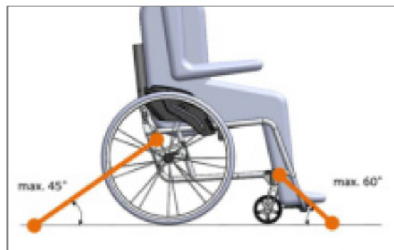
Figure 186 : Position des rétracteurs avant et arrière avec un angle de tension maximum et points d'attache (vue du côté)
