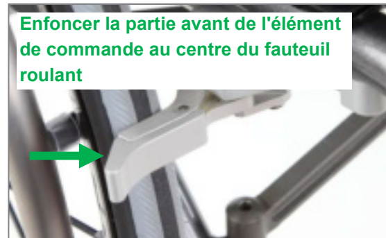
Figure 153 : Frein intégral fermé ; l'ouverture s'effectue en appuyant sur l'élément de commande au centre du fauteuil roulant
