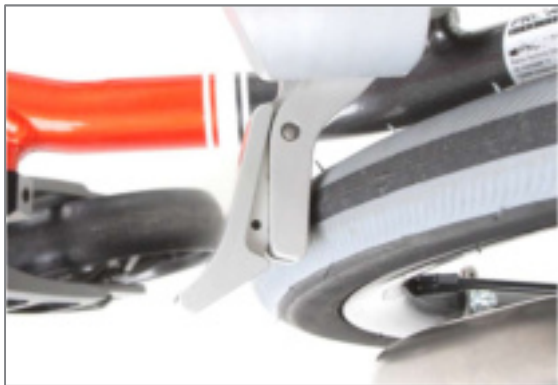
Figure 160 : Élément de frein reposant sur le pneu
