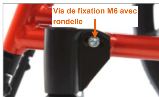
Figure 102 : Vis de fixation M6 sur le côté extérieur du châssis
