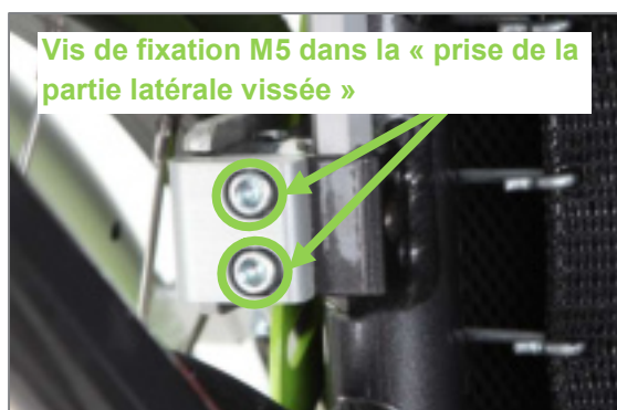
Figure 64 : « Prise de la partie latérale vissée » avec trous oblongs et vis de fixation M5 sur le corps de base de la prise de la partie latérale (vue du bas)
