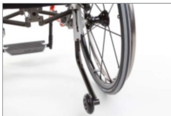
Figure 130 : Position de service des roulettes anti-bascule (vue arrière)
