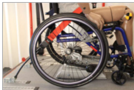
Figure 196 : Les ceintures de retenue ne doivent pas être éloignées du corps par des composants du fauteuil roulant tels que les accoudoirs ou les roues
