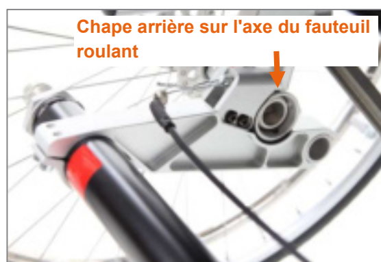
Figure 85 : Allongement d'empattement posé (vue du côté intérieur du produit)
