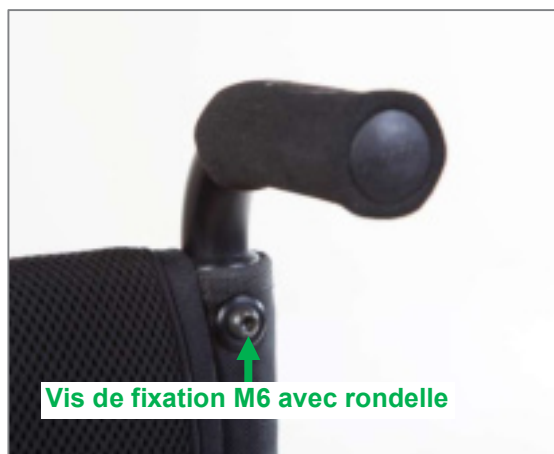
Figure 163 : Poignées de poussée en aluminium, montées fixement au tube dorsal
