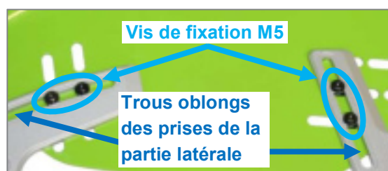
Figure 57 : Vis de fixation M5 et trous oblongs des prises de la partie latérale
