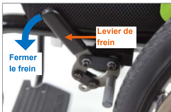
Figure 144 : Frein ouvert, la fermeture s'effectue en appuyant vers l'avant en bas sur le levier de frein
