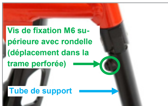
Figure 115 : La vis de fixation M6 supérieure (clé de 4 mm) peut être positionnée dans la trame perforée
