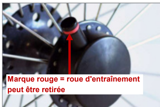
Figure 71 : Tetra-Clip avec axe de démontage rapide ouvert, la roue d'entraînement peut être retirée
