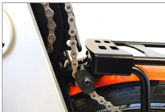
Figure 47 : Porte-bagage installé, chaîne tendue par le renvoi de chaîne
