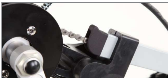
Figure 19 : Guide-chaîne en matière plastique dans le tube rectangulaire
