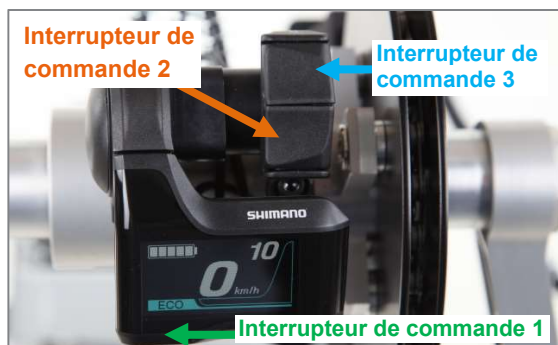
Figure 41 : Interrupteurs de commande pour activer l'éclairage à LED
