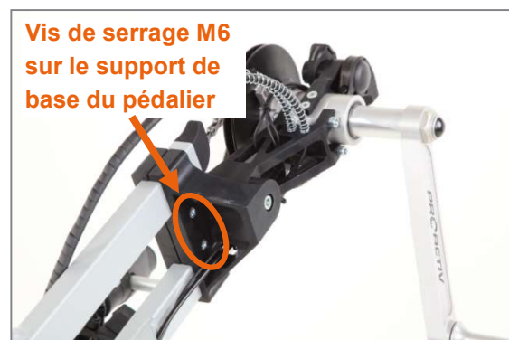
Figure 20 : Vis de serrage M6 sur le support de base du pédalier pour le réglage de la longueur
