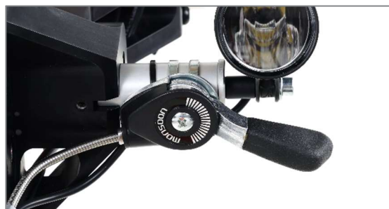
Figure 29 : Frein stationnement avec levier de blocage
