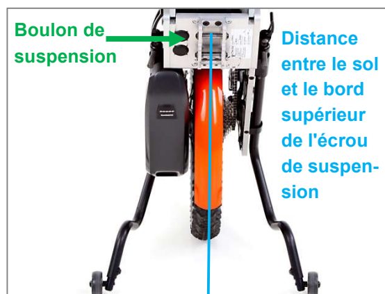
Figure 10 : Distance entre le sol et le bord supérieur de l'écrou de suspension
