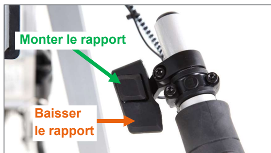
Figure 25 : Boutons pour monter et baisser le rapport
