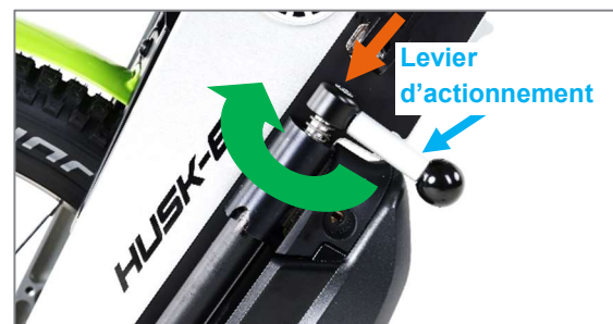
Figure 6 : Pousser le levier d'actionnement vers le bas et le tourner
