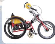
Adattamento affidabile e maneggevolezza. Lo SPIKE si fissa rapidamente alla carrozzina utilizzando l'adattatore centrale o anteriore. Il pratico supporto di parcheggio facilita inoltre l'aggancio e lo sgancio.
