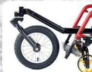
Pour l'attelage, l'adaptateur de roue est fixé, selon la variante, par une pince de serrage ou une plaque de verrouillage. Dans les deux cas : attelage et dételage rapides en quelques gestes.
