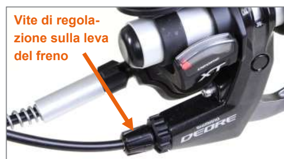
Figura 35: Vite di regolazione sulla leva del freno
