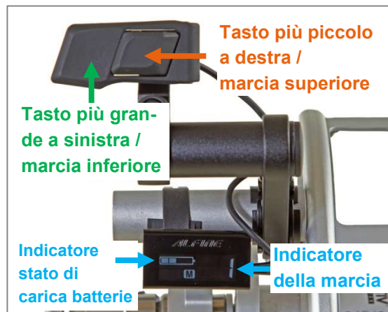
Figura 26: Cambio marcia tramite tasti elettronici con cambio a mozzo Shimano Alfine Di2
