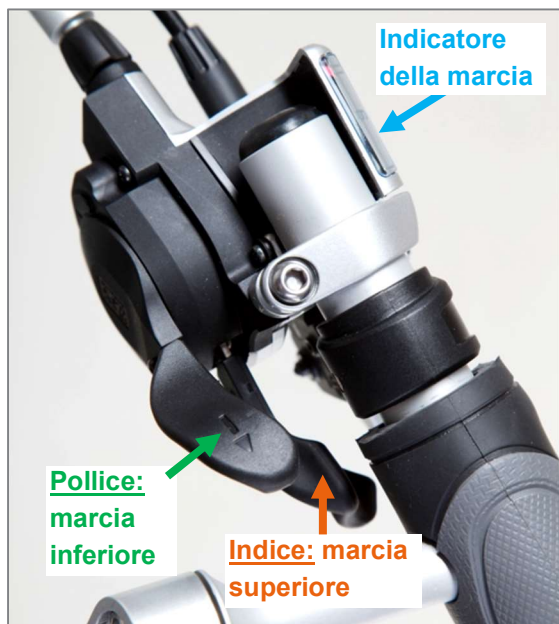
Figura 25: Cambio marcia tramite dispositivo di cambio pollice-indice con cambio a mozzo Shimano Alfine
