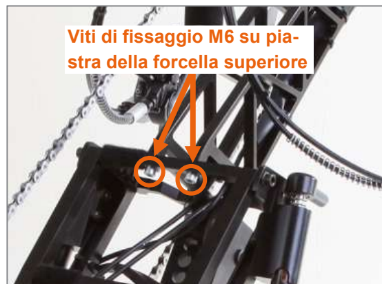
Figura 12: Viti di fissaggio M6 su piastra della forcella superiore
