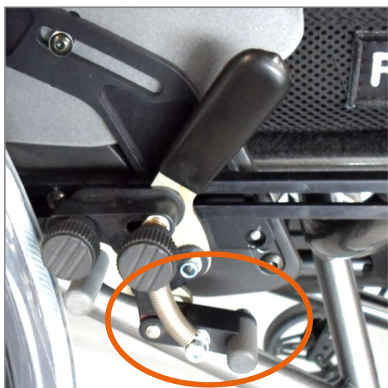
Figura 2: Sicura contro la retromarcia accidentale
