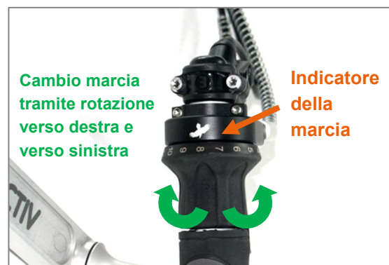
Figura 23: Cambio marcia tramite impugnatura girevole con cambio a mozzo Rohloff
