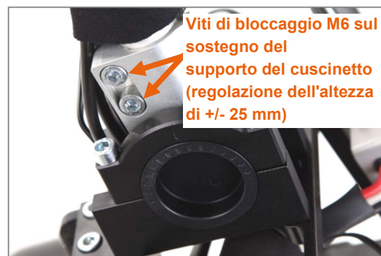
Figura 15: Viti di bloccaggio M6 per la regolazione dell'altezza della posizione del cuscinetto di movimento
