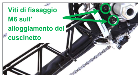
Figura 13: Viti di fissaggio M6 sull'alloggiamento del cuscinetto
