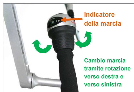
Figura 24: Cambio marcia tramite impugnatura girevole con cambio a mozzo Shimano Nexus
