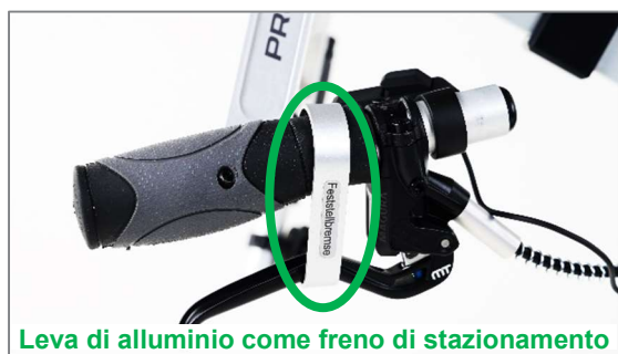
Figura 36: Leva di alluminio come freno di stazionamento
