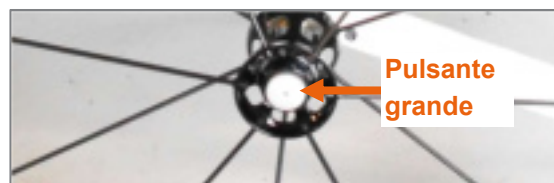
Figura 69: Asse flottante con supporto di comando e pulsante grande
