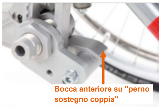
Figura 84: Prolungamento interasse applicato (vista dal lato esterno del prodotto senza ruota motrice)
