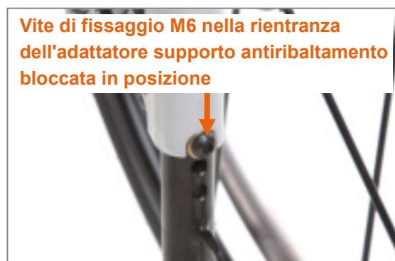
Figura 133: Supporto antiribaltamento bloccata correttamente in posizione
