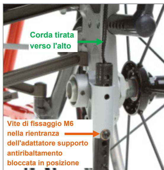
Figura 136: Staffa supporto antiribaltamento inserita nell'adattatore supporto antiribaltamento
