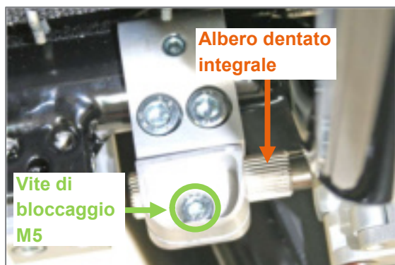
Figura 158: Vite di bloccaggio M5 per lo spostamento del freno integrale con albero dentato integrale nella pinza a morsa (vista dal lato interno del prodotto)
