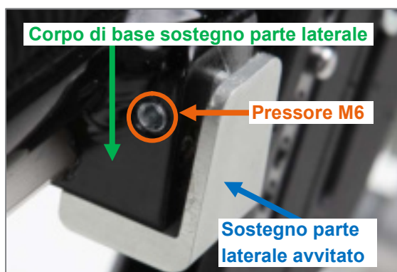
Figura 59: Pressore M6 avvitato nel "corpo di base del sostegno parte laterale"
