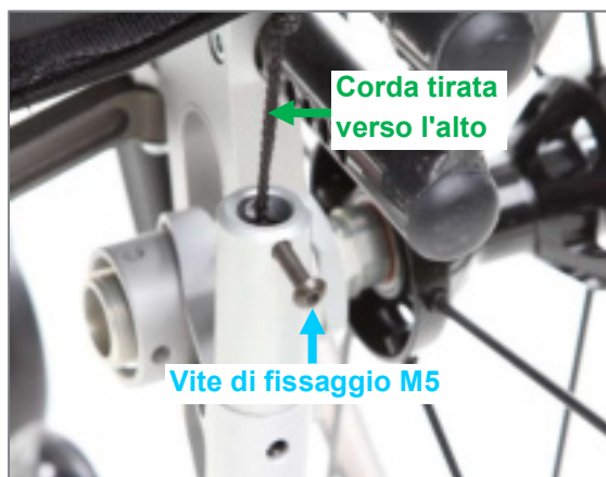
Figura 137: Perno di fissaggio molle appoggiato sull'adattatore supporto antiribaltamento, corda tirata verso l'alto e vite di fissaggio M5 applicata
