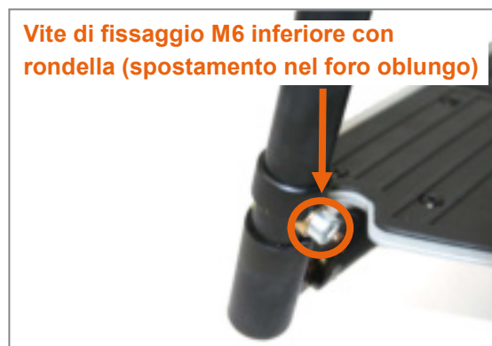
Figura 123: La vite di fissaggio M6 inferiore (apertura della chiave di 5 mm) può essere posizionata nel foro oblungho
