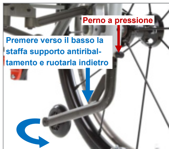
Figura 132: Portare il supporto antiribaltamento in posizione attiva (vista posteriore)
