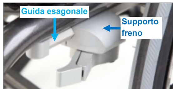
Figura 154: Guida esagonale e supporto freno
