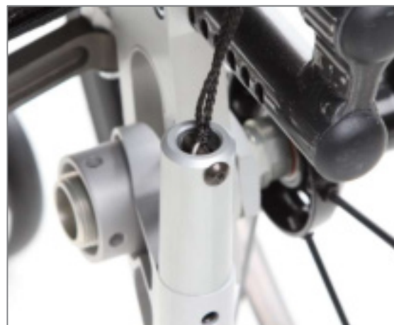
Figura 139: Vite di fissaggio M5 avvitata attraverso l'occhiello di chiusura della molla di trazione
