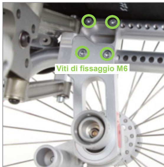
Figura 15: Viti di fissaggio M6 della piastra della ruota (vista dal lato interno del prodotto)
