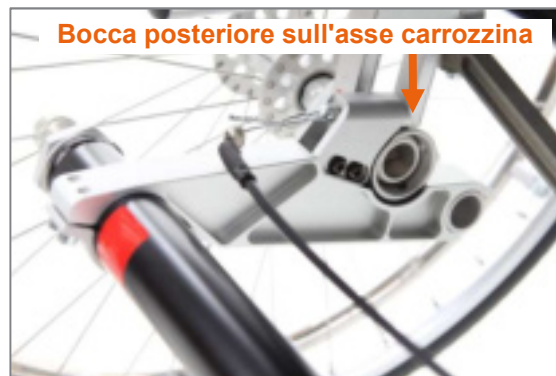
Figura 85: Prolungamento interasse applicato (vista dal lato interno prodotto)
