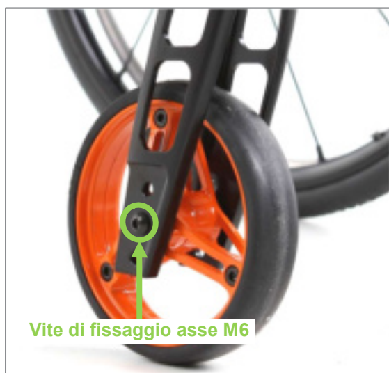
Figura 87: Vite di fissaggio M6 dell'asse ruota sterzante (vista dal lato esterno del prodotto)
