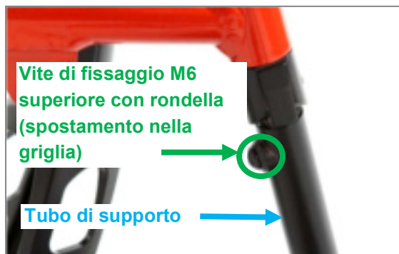
Figura 115: La vite di fissaggio M6 superiore (apertura della chiave di 4 mm) può essere posizionata nella griglia
