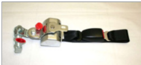
Figura 170: Retrattore anteriore "Semiautomatico" con fibbia di chiusura e linguetta fibbia
