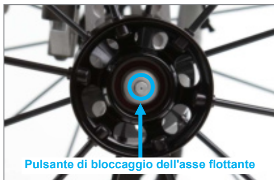
Figura 67: Pulsante di bloccaggio dell'asse flottante al centro dell'asse ruota
