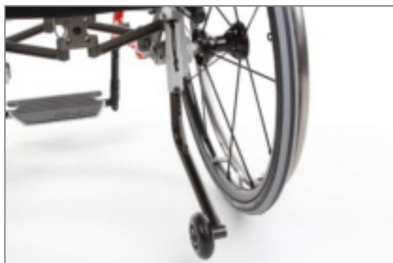
Figura 130: Posizione attiva del supporto antiribaltamento (vista posteriore)
