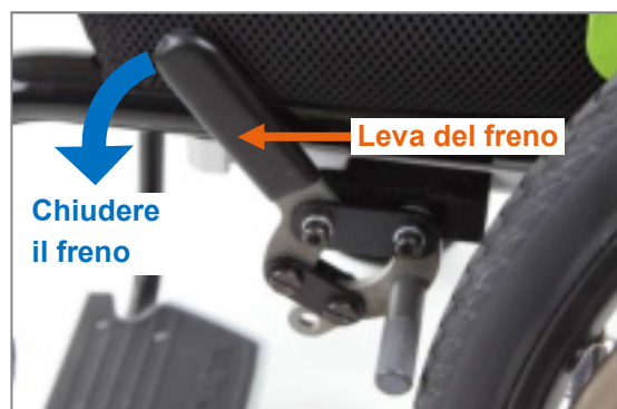
Figura 144: Freno aperto; la chiusura viene effettuata premendo in avanti verso il basso la leva del freno
