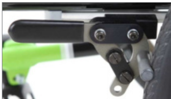
Figura 143: Sistema dei freni a leve separate con leva del freno standard
