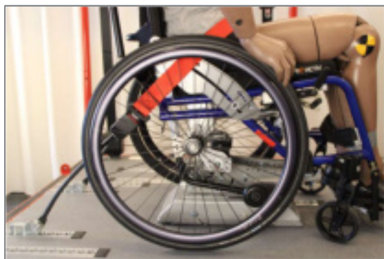
Figura 196: Le cinture di sicurezza non devono essere tenute lontane dal corpo da componenti della sedia a rotelle quali braccioli o ruote
