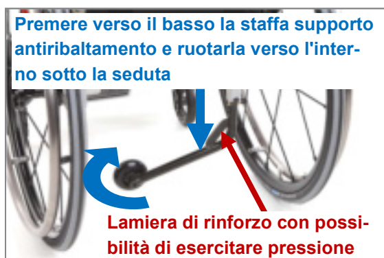
Figura 134: Portare il supporto antiribaltamento in posizione passiva (vista posteriore)
