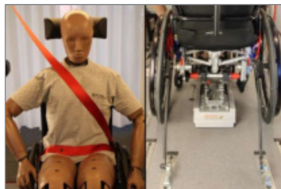
Figura 195: I sistemi di ritenuta dei passeggeri dovrebbero garantire un contatto completo con le spalle, il torace e il bacino, mentre le cinture addominali dovrebbero essere posizionate in basso sul bacino, nella zona tra le cosce e l'addome
