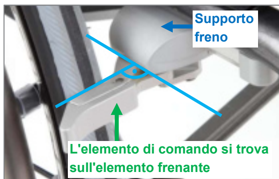
Figura 152: Freno integrale chiuso; elemento frenante in verticale rispetto al supporto freno
