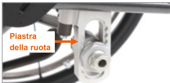
Figura 6: Piastra della ruota per la regolazione dell'altezza del sedile posteriore (ruota motrice rimossa)
