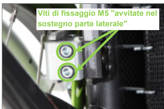
Figura 64: "Sostegno parte laterale avvitato" con fori oblunghi e viti di fissaggio M5 al corpo di base del sostegno parte laterale (vista dal basso)
