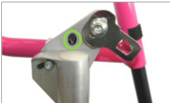
Figura 179: Piastra intermedia blocco cuscinetti ruota sterzante con linguetta fibbia per il retrattore anteriore
