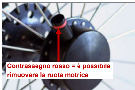
Figura 71: Tetra Clip con asse flottante aperto: è possibile rimuovere la ruota motrice
