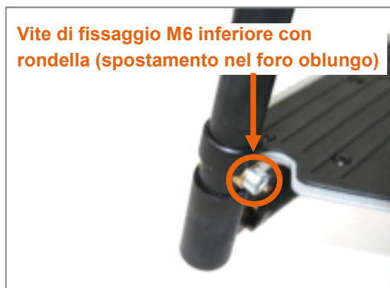
Figura 116: La vite di fissaggio M6 inferiore (apertura della chiave di 5 mm) può essere posizionata nel foro oblungho
