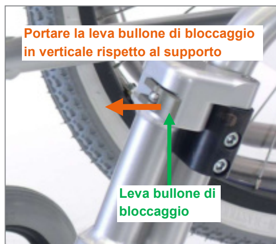
Figura 126: Posizionare in verticale la leva bullone di bloccaggio per la rimozione del poggiapiedi Swing away
