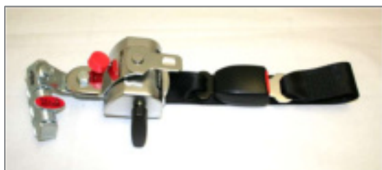
Figura 171: Retrattore posteriore "Semiautomatico" con volantino, fibbia di chiusura e linguetta fibbia
