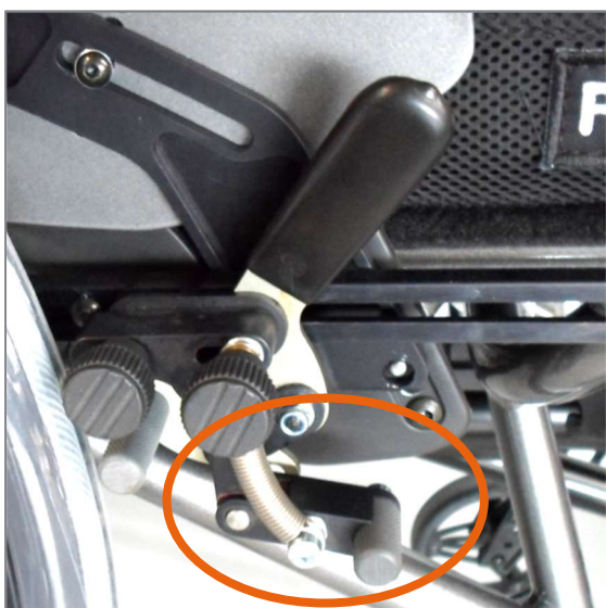
Figura 2: Sicura contro la retromarcia accidentale
