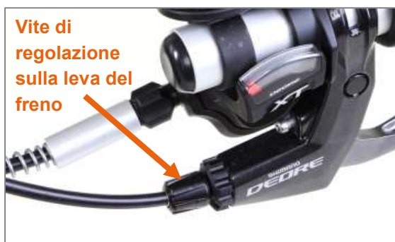
Figura 22: Vite di regolazione sulla leva del freno
