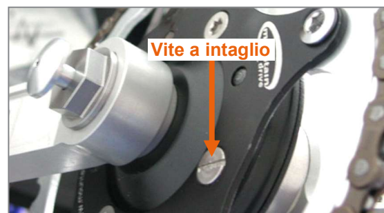
Figura 19: Vite a intaglio da ingrassare
