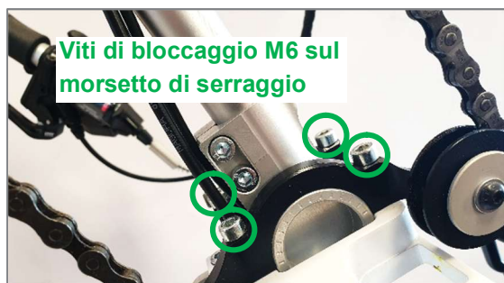
Figura 12: Viti di bloccaggio M6 sul morsetto di serraggio
