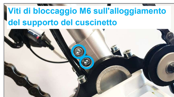
Figura 14: Viti di bloccaggio M6 sull'alloggiamento del supporto del cuscinetto per la regolazione in verticale della posizione del cuscinetto e la sostituzione del relativo supporto
