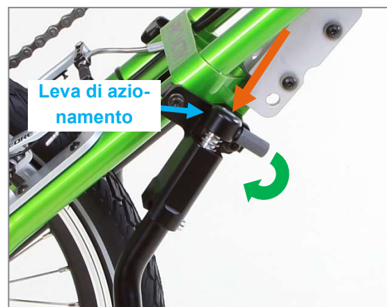
Figura 6: Premere la leva di azionamento verso il basso e ruotarla
