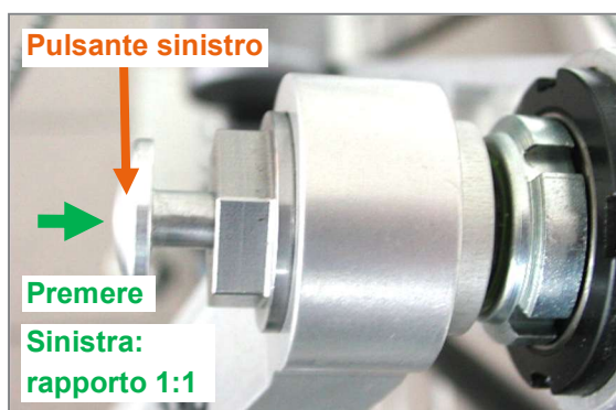
Figura 18: Pulsante sinistro del cambio anteriore integrato
