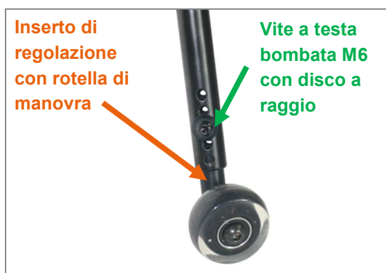
Figura 11: Vite a testa bombata M6 con disco a raggio e inserto di regolazione per la regolazione in altezza del cavalletto o della rotella di manovra
