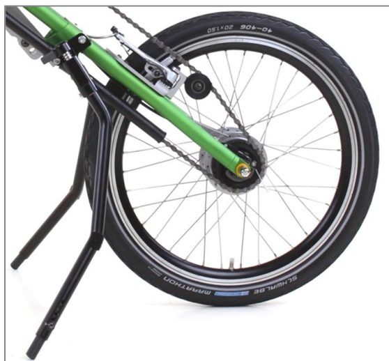
Figura 7: Cavalletto in posizione attiva
