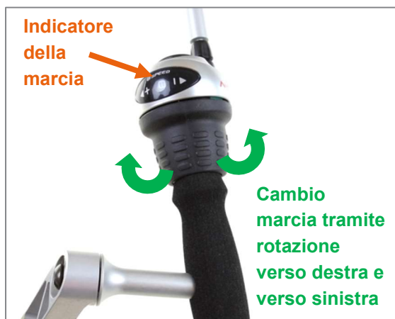
Figura 17: Cambio marcia tramite impugnatura girevole con cambio a mozzo Shimano Nexus
