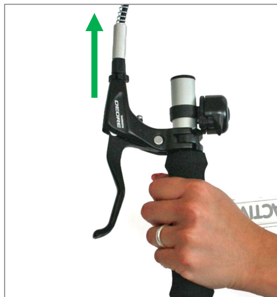
Figura 16: Posizione corretta dell'impugnatura
