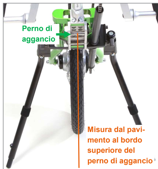
Figura 10: Misura dal pavimento al bordo superiore del perno di aggancio
