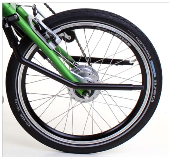
Figura 8: Cavalletto in posizione passiva
