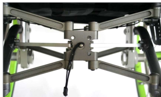
Figure 16 : Mauvaise position du cordon de déclenchement, alésages pour tenons de centrage en bas à gauche cachés
