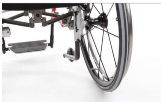
Figura 131: Posizione passiva del supporto antiribaltamento (vista posteriore)
