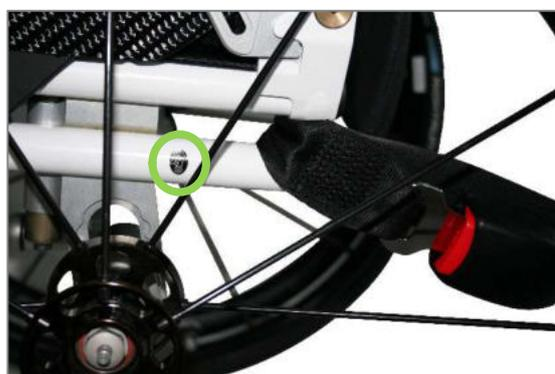
Figura 181: Simbolo del fissaggio posteriore e con occhielli della carrozzina sul dietro
