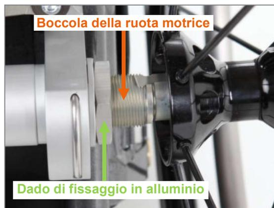
Figura 74: Boccola della ruota motrice e dado di fissaggio in alluminio (vista dal basso)
