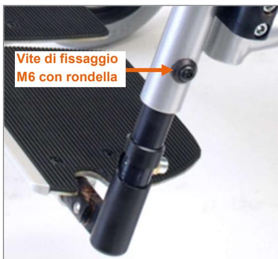
Vite di fissaggio M6 con rondella
