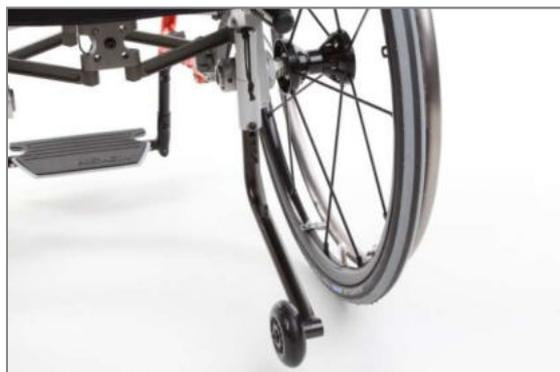
Figura 130: Posizione attiva del supporto antiribaltamento (vista posteriore)
