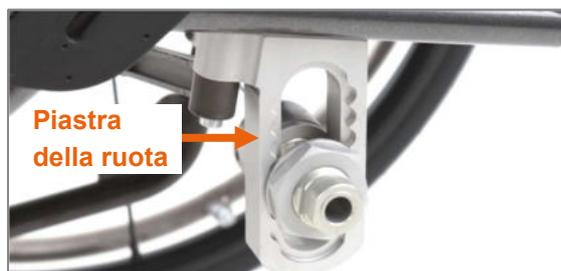
Figura 6: Piastra della ruota per la regolazione dell'altezza del sedile posteriore (ruota motrice rimossa)
