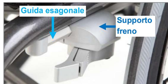
Figura 154: Guida esagonale e supporto freno
