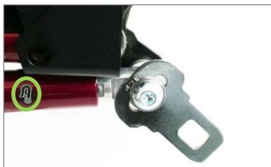
Figura 176: Collegamento del sistema di bloccaggio sul telaio posteriore con linguette fibbia per il retrattore posteriore e cinghia di sicurezza (vista laterale)
