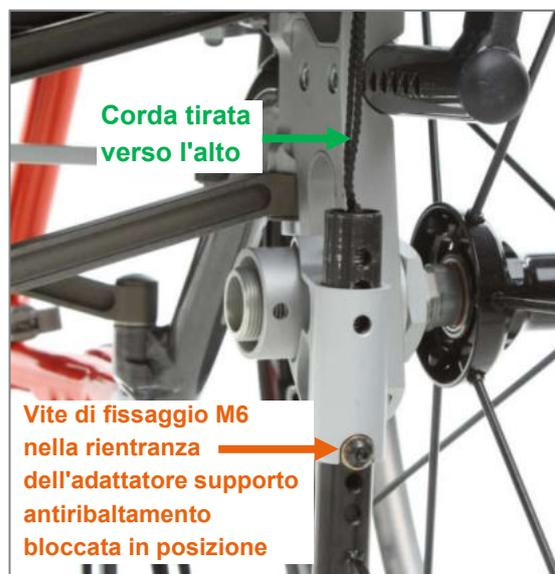
Figura 136: Staffa supporto antiribaltamento inserita nell'adattatore supporto antiribaltamento
