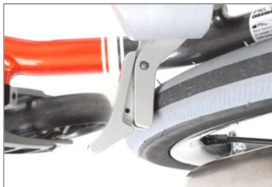
Figura 160: Elemento frenante a contatto con lo pneumatico
