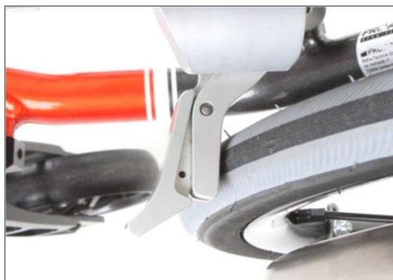
Figura 156: Elemento frenante a contatto con lo pneumatico
