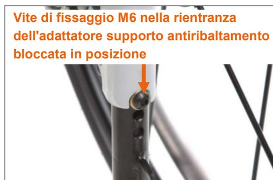
Figura 133: Supporto antiribaltamento bloccata correttamente in posizione
