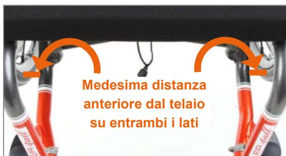
Figura 75: Distanza anteriore dal telaio
