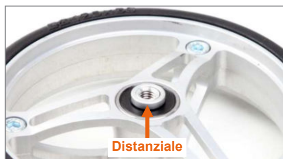
Figura 83: Distanziale sulla ruota sterzante
