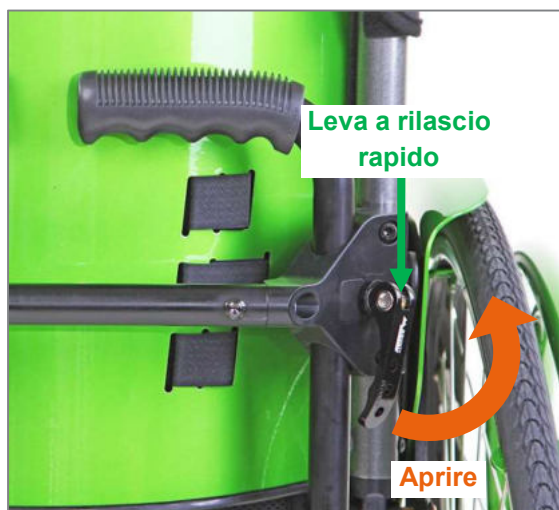
Figura 149: Leva a rilascio rapida chiusa
