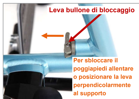
Figura 98: Leva bullone di bloccaggio in posizione normale, poggiapiedi bloccato. Per rimuoverlo, mettere la leva del bullone di bloccaggio in posizione verticale
