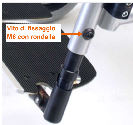
Figura 122: Vite di fissaggio M6 con rondella per la regolazione della lunghezza della gamba
