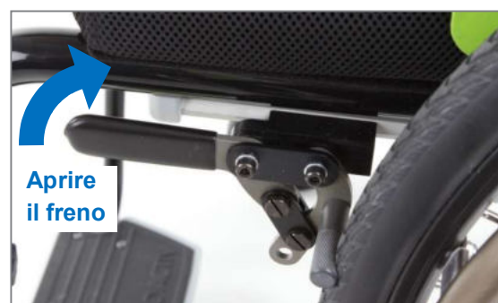
Figura 136: Freno chiuso; l'apertura viene effettuata tirando la leva del freno all'indietro verso l'alto.
