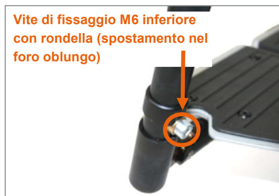
Figura 117: La vite di fissaggio M6 inferiore (apertura della chiave di 5 mm) può essere posizionata nel foro oblungho
