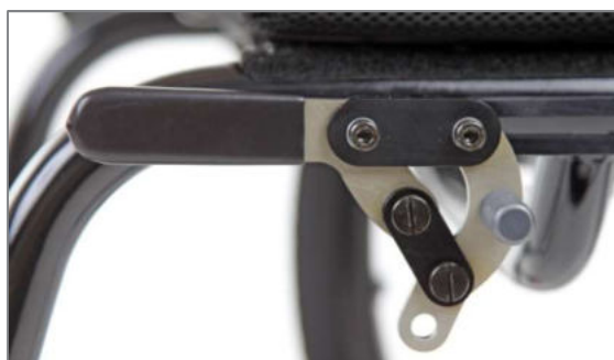
Figura 134: Sistema dei freni a leve separate con leva del freno standard
