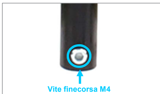
Figura 150: Vite finecorsa M4 inserita in basso su una maniglia di spinta arretrata
