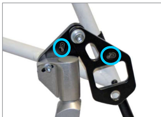
Figura 160: Piastra intermedia blocco cuscinetti ruota sterzante con occhiello per cinghia per il retractor anteriore
