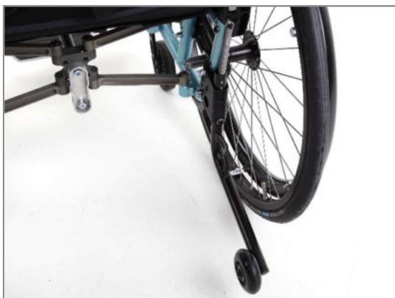
Figura 124: Posizione attiva del supporto antiribaltamento (vista posteriore)
