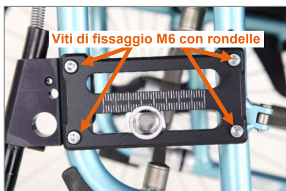
Figura 12: Viti di fissaggio M6 della piastra della ruota (vista dal lato esterno del prodotto, ruota motrice rimossa)
