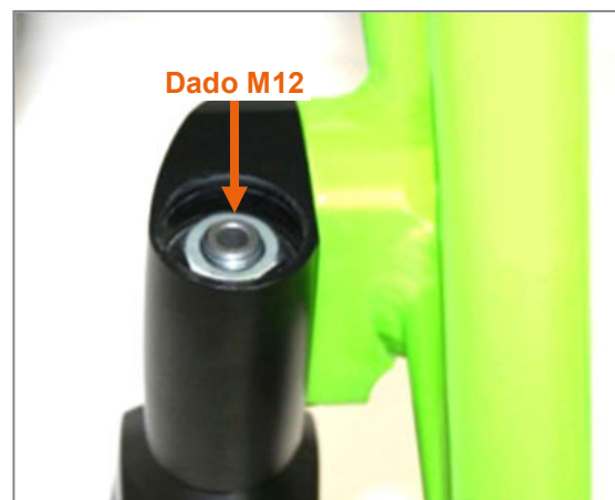
Figura 91: Tappo in alluminio rimosso e dado M12 visibile
