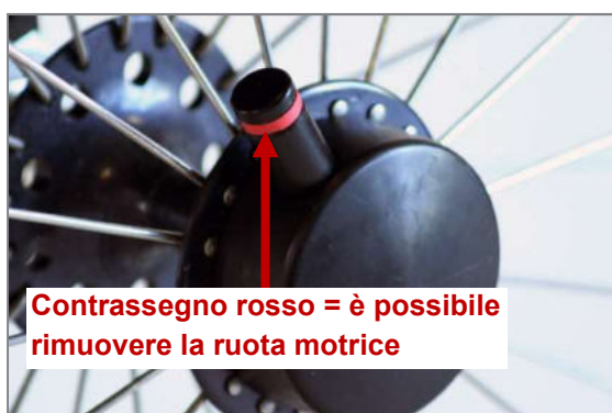
Figura 70: Tetra Clip con asse flottante aperto: è possibile rimuovere la ruota motrice
