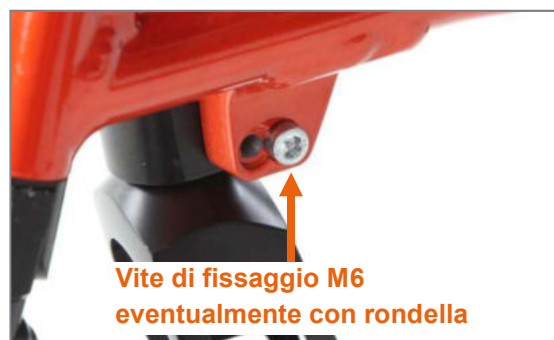
Figura 95: Vite di fissaggio M6 sul lato interno del telaio, rondella presente sui telai a forma di G, ma non sui telai a forma di V
