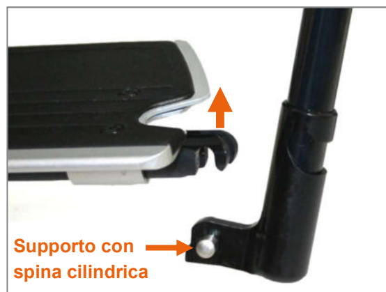
Figura 106: Supporto pedana sollevato dal sostegno (vista del prodotto da davanti)
