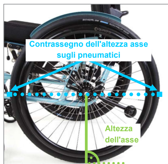
Figura 72: Contrassegno dell'altezza asse anteriormente e posteriormente su entrambi gli pneumatici
