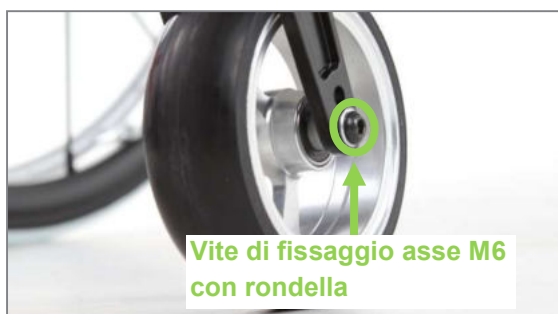
Figura 84: Vite di fissaggio M6 dell'asse ruota sterzante (vista dal lato esterno del prodotto)
