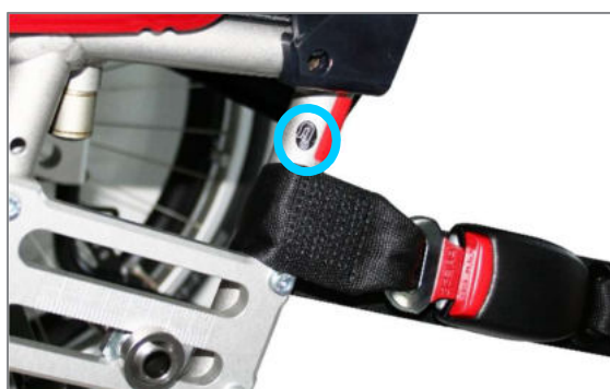
Figura 162: Simbolo del fissaggio posteriore e con occhielli della carrozzina sul dietro
