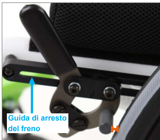
Figura 138: Distanza tra i bulloni del freno e gli pneumatici compresa tra circa 3 e max. 4 mm con il freno aperto
