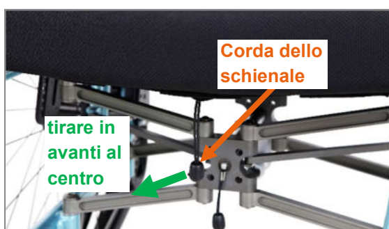
Figura 27: Corda per l'azionamento dei bulloni di bloccaggio e quindi la regolazione dell'angolazione dello schienale
