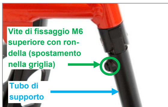
Figura 109: La vite di fissaggio M6 superiore (apertura della chiave di 4 mm) può essere posizionata nella griglia
