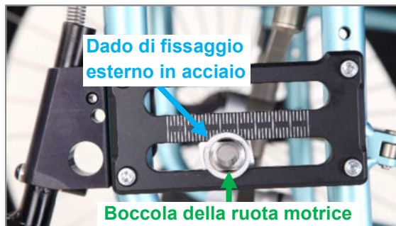
Figura 21: Dado di fissaggio esterno in acciaio e boccola della ruota motrice (vista dal lato esterno del prodotto, ruota motrice rimossa)
