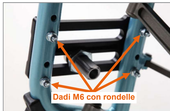
Figura 13: Dadi M6 della piastra della ruota (vista dal lato interno del prodotto, ruota motrice rimossa)
