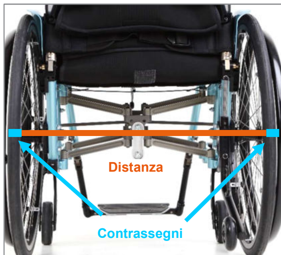
Figura 73: Distanza tra i contrassegni degli pneumatici (ad altezza asse), posteriormente
