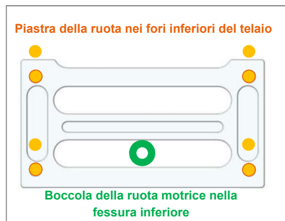
Figura 16: Esempio di posizione iniziale per la regolazione
