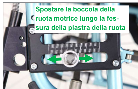
Figura 23: Spostare la boccola della ruota motrice lungo la fessura della piastra della ruota (vista dal lato esterno del prodotto, ruota motrice rimossa)
