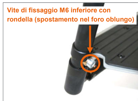
Figura 110: La vite di fissaggio M6 inferiore (apertura della chiave di 5 mm) può essere posizionata nel foro oblungho
