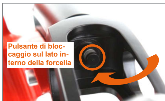
Figura 92: Forcella ruota sterzante con asse flottante e pulsante di bloccaggio
