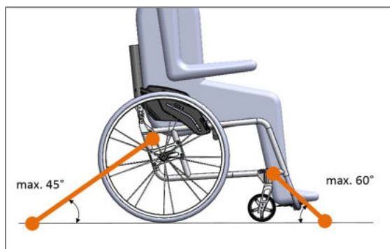
Figura 165: Andamento dei retractori anteriormente e posteriormente con angolazione di ancoraggio massima e punti di collegamento (vista dal lato)
