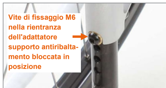
Figura 127: Supporto antiribaltamento bloccata correttamente in posizione
