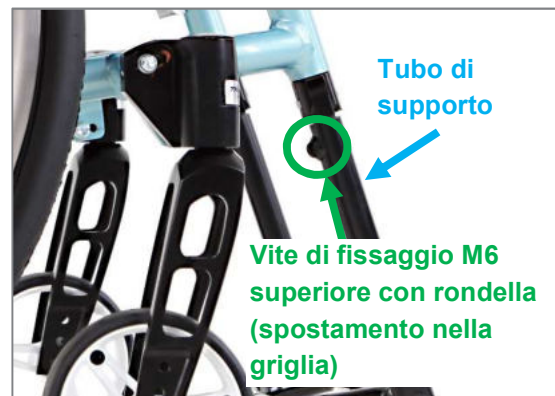
Figura 102: La vite di fissaggio M6 superiore può essere posizionata nella griglia
