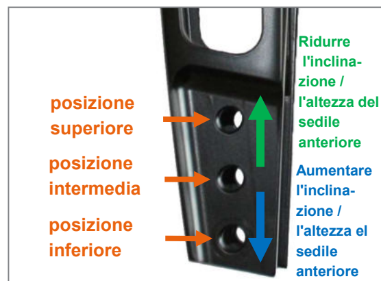
Figura 18: Tre posizioni nella forcella della ruota sterzante per il posizionamento della ruota sterzante ed effetto sull'altezza del sedile anteriore
