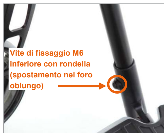
Figura 103: La vite di fissaggio M6 inferiore può essere posizionata nel foro oblungo
