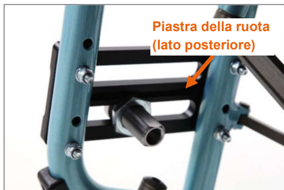
Figura 7: Piastra della ruota con 2 fessure per una regolazione dell'altezza del sedile posteriore (vista dal lato interno del prodotto, ruota motrice rimossa)
