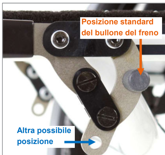
Figura 140: Posizioni del bullone del freno
