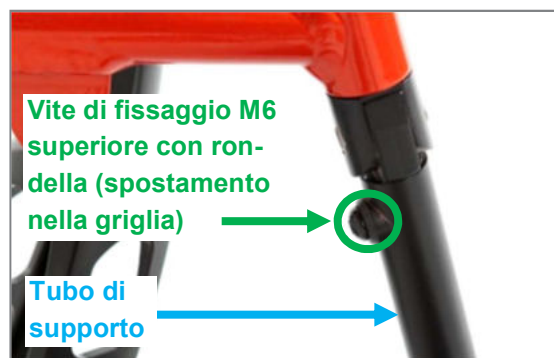
Figura 116: La vite di fissaggio M6 superiore (apertura della chiave di 4 mm) può essere posizionata nella griglia
