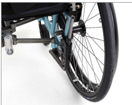
Figura 125: Posizione passiva del supporto antiribaltamento (vista posteriore)
