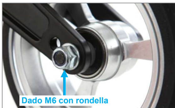
Figura 85: Dado M6 dell'asse ruota sterzante (vista dal lato interno del prodotto)
