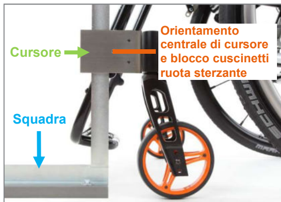
Figura 93: Verifica della regolazione degli assi di rotazione della forcella della ruota sterzante
