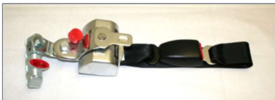
Figura 151: Retrattore anteriore "Semiautomatico" con fibbia di chiusura e linguetta fibbia
