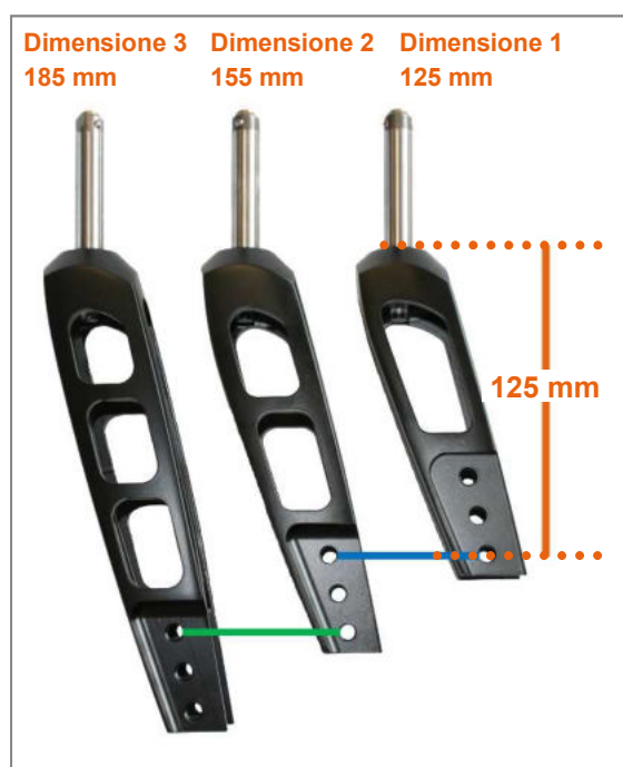
Figura 19: Dimensioni forcella della ruota sterzante con contrassegno delle stesse regolazioni dell'altezza del sedile per diverse dimensioni forcella della ruota sterzante
