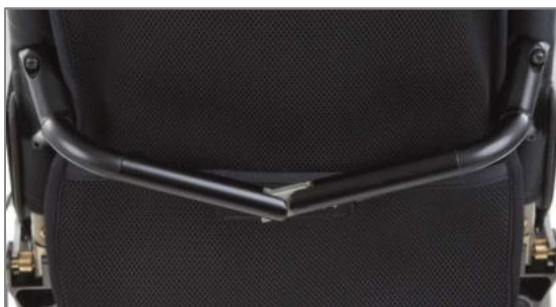
Figura 2: barra posteriore trasversale sbloccata
