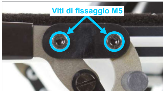
Figura 137: Viti di fissaggio M5 sulla guida di arresto del freno
