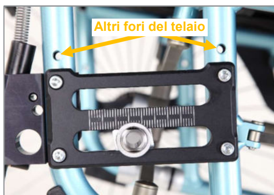
Figura 15: Fori del telaio (vista dal lato esterno del prodotto, ruota motrice rimossa)
