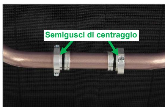
Figura 64: Semigusci di centraggio sul tubo trasversale anteriore del telaio
