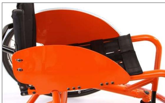
Figura 2: Schienale saldamente avvitato sulla piastra laterale, dotazione piastra laterale in alluminio
