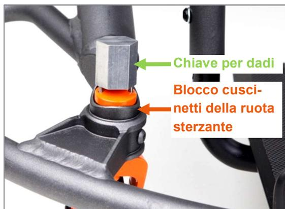
Figura 46: Allentamento del dado dell'asse di rotazione della forcella della ruota sterzante con la chiave per dadi
