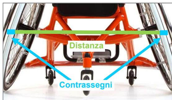
Figura 37: Distanza tra i contrassegni degli pneumatici (ad altezza asse), posteriormente
