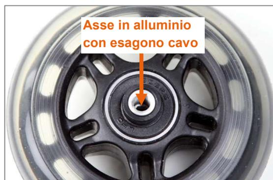
Figura 44: Ruota sterzante con asse in alluminio
