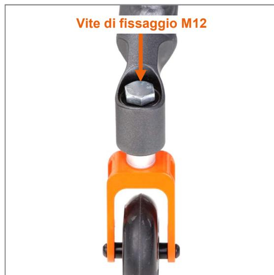
Figura 66: Tappo rimosso e vite di fissaggio M12 visibile
