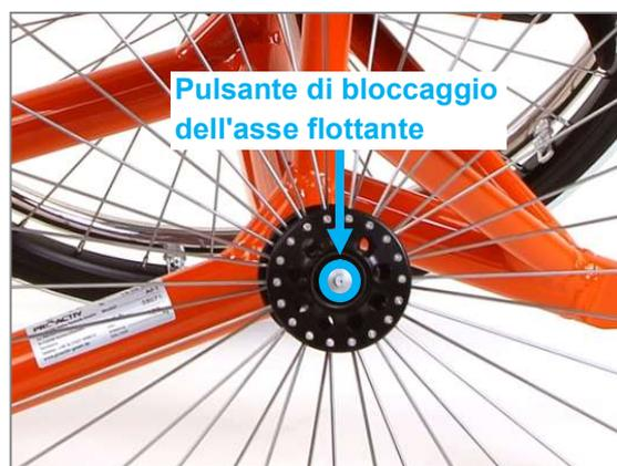
Figura 31: Pulsante di bloccaggio dell'asse flottante al centro dell'asse ruota
