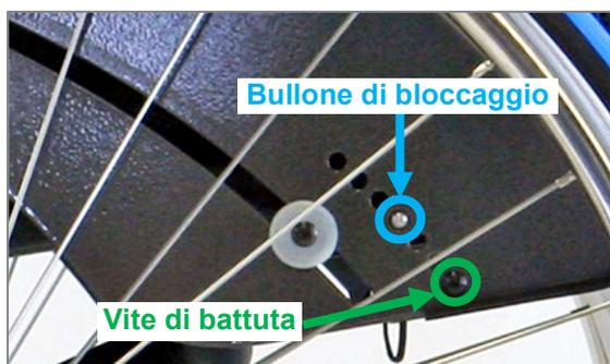
Figura 5: Bullone di bloccaggio e vite di battuta (vista dal lato esterno del prodotto)
