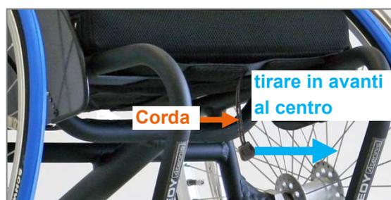
Figura 7: Corda per l'azionamento dei bulloni di bloccaggio e quindi la regolazione dell'angolazione dello schienale
