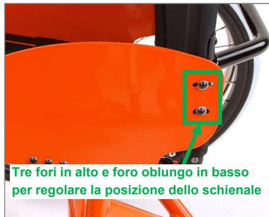
Tre fori in alto e foro oblungo in basso per regolare la posizione dello schienale
