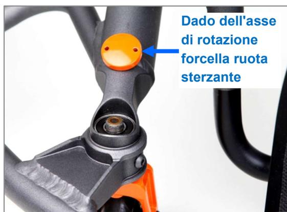
Figura 47: Dado dell'asse di rotazione forcella ruota sterzante completamente rimosso
