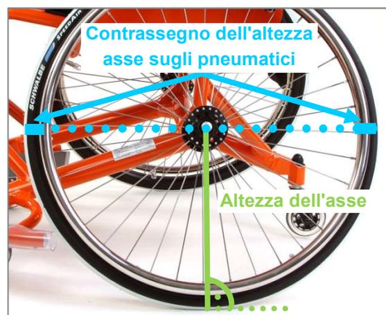
Figura 33: Contrassegno dell'altezza asse anteriormente e posteriormente su entrambi gli pneumatici
