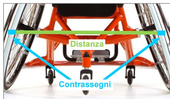
Figura 34: Distanza tra i contrassegni degli pneumatici (ad altezza asse), posteriormente
