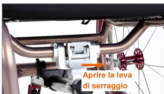
Figura 61: Tirare in avanti la leva di serraggio per aprirla
