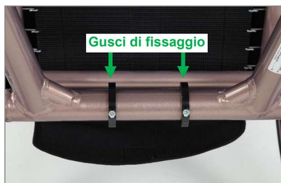
Figura 63: Gusci di fissaggio sul tubo trasversale posteriore del telaio
