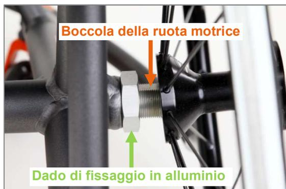
Figura 35: Boccola della ruota motrice e dado di fissaggio in alluminio (vista posteriore)
