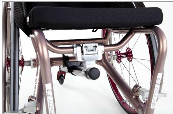
Figura 60: Supporto antiribaltamento centrale rimovibile (vista anteriore)
