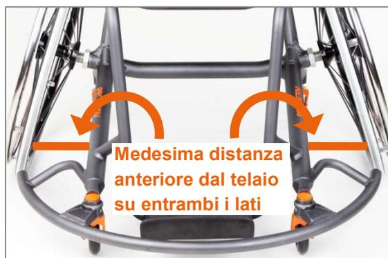
Figura 36: Distanza anteriore dal telaio
