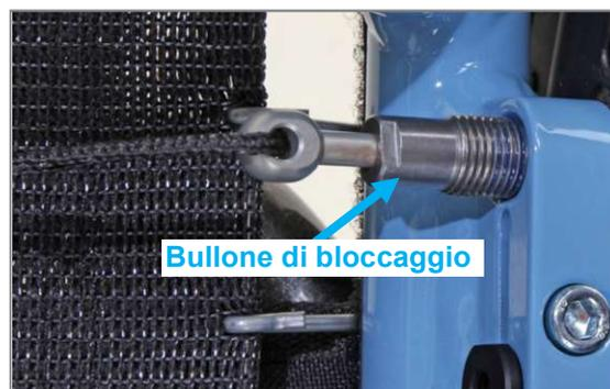
Figura 6: Bullone di bloccaggio collegato con la corda (vista dal basso)
