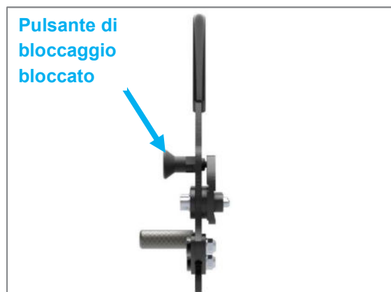
Figura 111: Pulsante di bloccaggio innestato nel blocco di arresto (vista anteriore)
