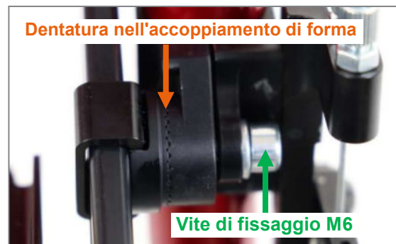
Figura 92: Dentatura sul dispositivo di serraggio del poggiatesta, nell'accoppiamento di forma
