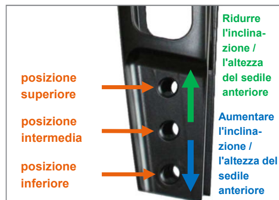
Figura 10: Tre posizioni nella forcella della ruota sterzante per il posizionamento della ruota sterzante ed effetto sull'altezza del sedile anteriore
