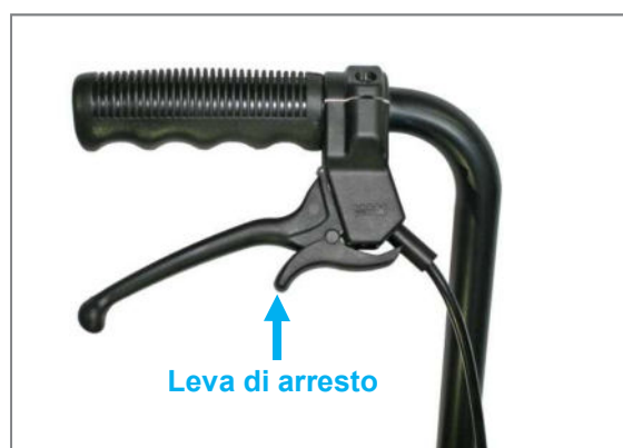
Figura 113: Presa del freno sul dispositivo di spinta con leva di arresto
