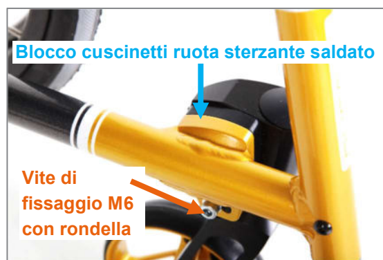
Figura 73: Vite di fissaggio M6 sul lato interno del telaio con rondella
