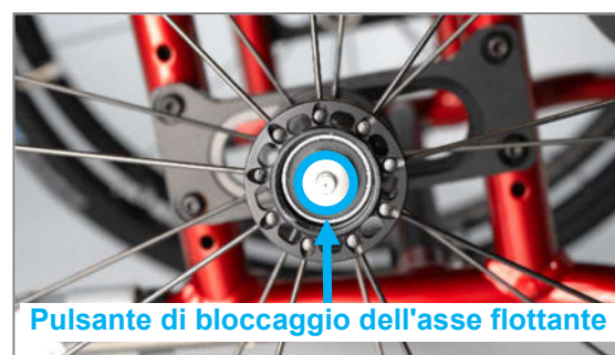
Figura 43: Pulsante di bloccaggio dell'asse flottante al centro dell'asse ruota
