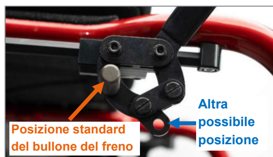
Figura 106: Posizioni del bullone del freno
