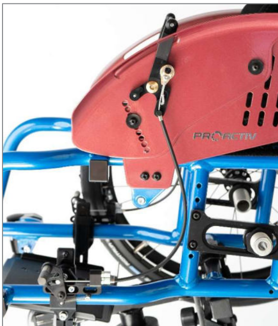
Figura 116: Sistema frenante a leve separate con comando dei freni integrato in alto nella spondina paraspruzzi
