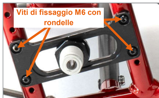
Figura 4: Viti di fissaggio M6 della piastra della ruota (vista dal lato esterno del prodotto, ruota motrice rimossa)
