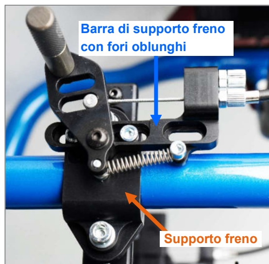
Figura 118: Supporto freno e barra di supporto freno
