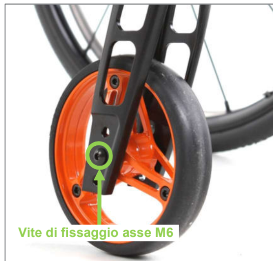
Figura 59: Vite di fissaggio M6 dell'asse ruota sterzante (vista dal lato esterno del prodotto)
