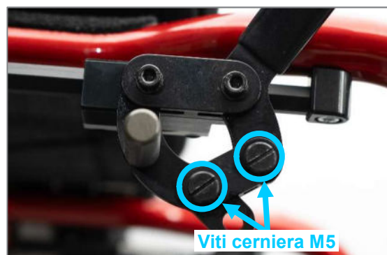
Figura 105: Viti cerniera M5 per la regolazione della forza di azionamento della leva del freno
