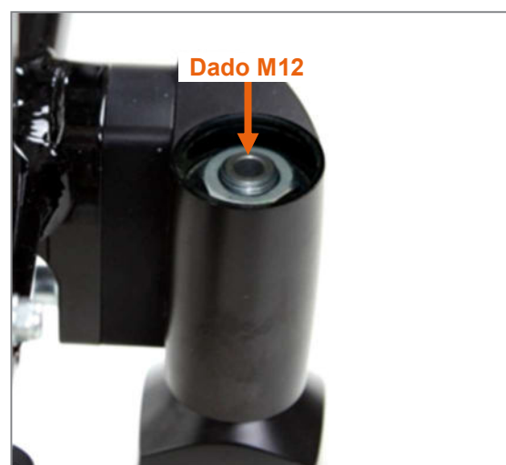
Figura 69: Tappo in alluminio rimosso e dado M12 visibile
