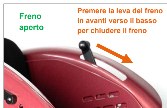
Figura 114: Freno aperto, premere la leva del freno in avanti verso il basso per chiudere il freno
