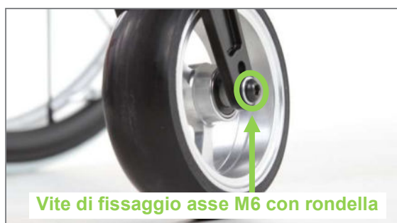
Figura 62: Vite di fissaggio M6 dell'asse ruota sterzante (vista dal lato esterno del prodotto)
