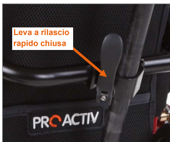
Figura 127: Leva a rilascio rapida chiusa
