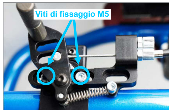
Figura 117: Viti di fissaggio M5
