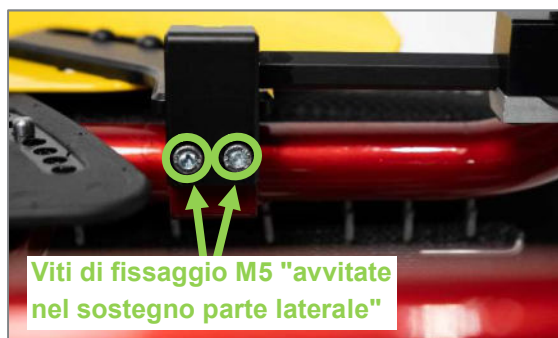
Figura 40: "Sostegno parte laterale avvitato" con fori oblunghi e viti di fissaggio M5 al corpo di base del sostegno parte laterale (vista dal basso)
