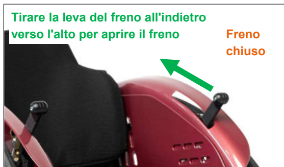
Figura 115: Freno chiuso, tirare la leva del freno all'indietro per aprire il freno
