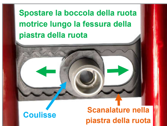
Figura 14: Spostare la boccola della ruota motrice lungo la fessura della piastra della ruota (vista dal lato interno del prodotto)
