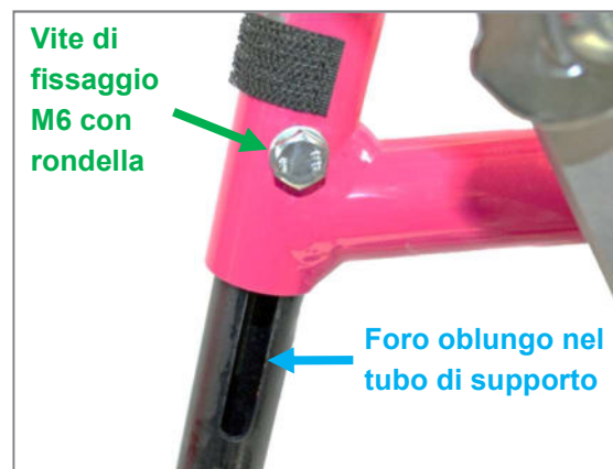
Figura 84: Vite di fissaggio M6 con rondella e foro oblungo nel tubo di supporto poggiapiedi per la regolazione della lunghezza della gamba
