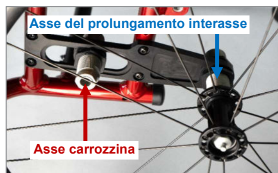
Figura 57: Prolungamento interasse mediante piastra della ruota estesa
