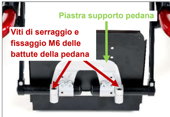
Figura 95: Supporto pedana ribaltabile all'indietro, ribaltato verso l'alto
