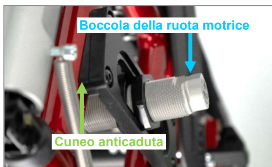
Figura 51: Boccola della ruota motrice (con campanatura integrata) e cuneo anticaduta 4°
