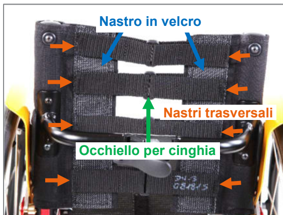
Figura 19: Regolazione dell'imbando mediante nastri trasversali
