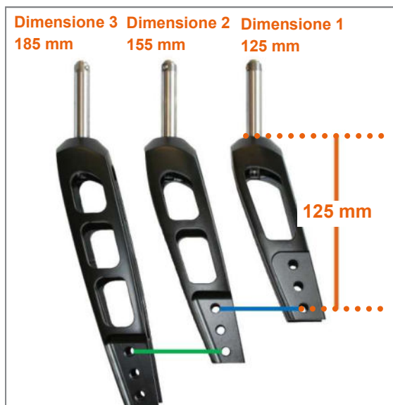
Figura 11: Dimensioni forcella della ruota sterzante con contrassegno delle stesse regolazioni dell'altezza del sedile per diverse dimensioni forcella della ruota sterzante
