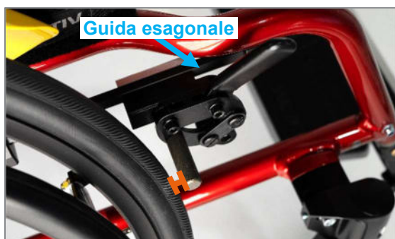
Figura 104: Distanza tra i bulloni del freno e gli pneumatici compresa tra circa 3 e max. 4 mm con il freno aperto
