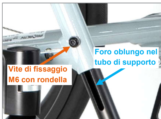
Figura 77: Vite di fissaggio M6 con rondella e foro oblungo nel tubo di supporto poggipiedi per la regolazione della lunghezza della gamba
