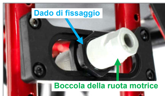
Figura 49: Boccola della ruota motrice e dado di fissaggio
