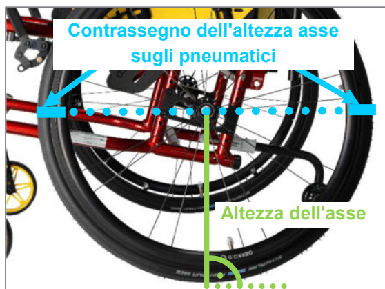
Figura 47: Contrassegno dell'altezza asse anteriormente e posteriormente su entrambi gli pneumatici
