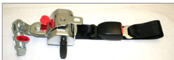
Figura 133: Retrattore posteriore "Semiautomatico" con volantino, fibbia di chiusura e linguetta fibbia
