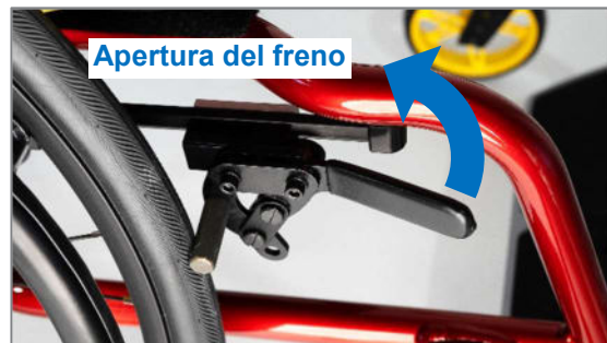
Figura 102: Freno chiuso; l'apertura viene effettuata tirando la leva del freno all'indietro verso l'alto.
