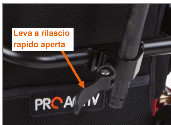
Figura 128: Leva a rilascio rapido aperta
