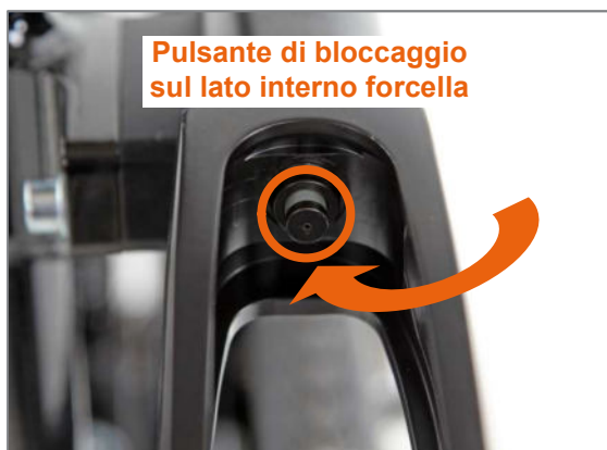
Figura 70: Forcella ruota sterzante con asse flottante e pulsante di bloccaggio
