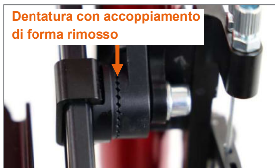
Figura 93: Dentatura sul dispositivo di serraggio del poggiapiedi, accoppiamento di forma rimosso
