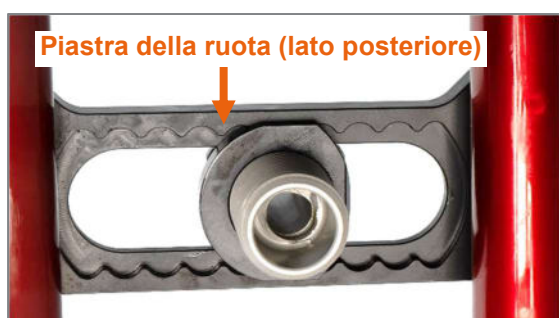
Figura 2: Piastra della ruota per una regolazione dell'altezza del sedile posteriore (vista dal lato interno del prodotto)
