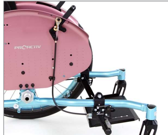
Figure 60 : Système de frein unilatéral avec commande de frein intégrée en haut au protège-vêtements
