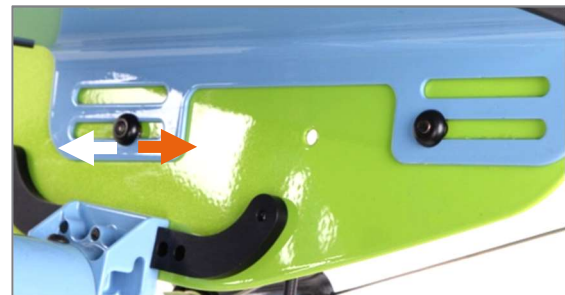
Figure 9 : Réglage de la profondeur d'assise en poussant la plaque d'assise le long des trous oblongs
