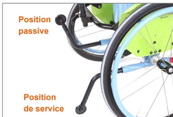
Figure 51 : Positions de service et passive des roulettes anti-bascule
