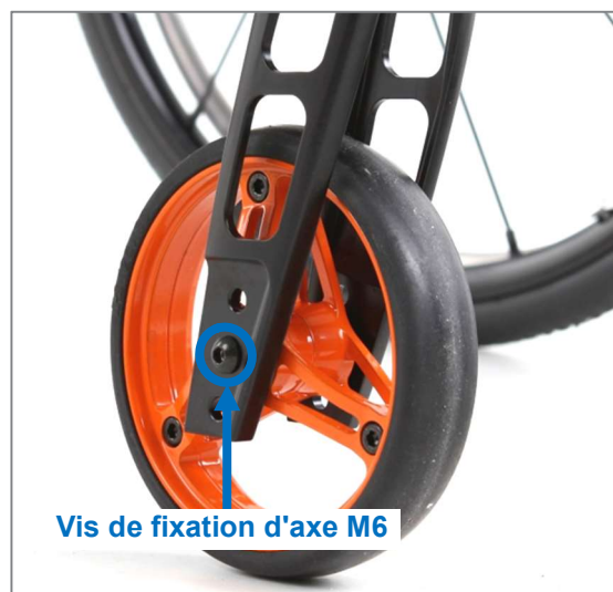
Figure 38 : Vis de fixation d'axe M6 de l'axe de la roue avant (vue du côté extérieur du produit)
