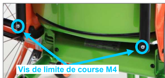
Figure 72 : Vis de limite de course M4 sur poignées de poussée déportées vers l'arrière posées en bas
