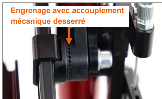
Figure 18 : Engrenage sur le tendeur du cale-pieds, à accouplement mécanique desserré
