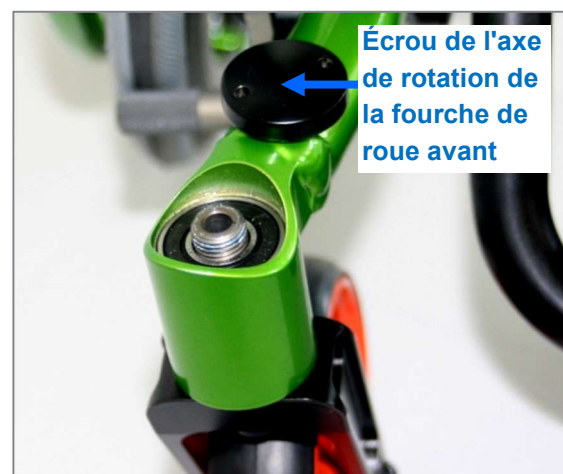
Figure 47 : Écrou entièrement retiré de l'axe de rotation de la fourche de roue avant
