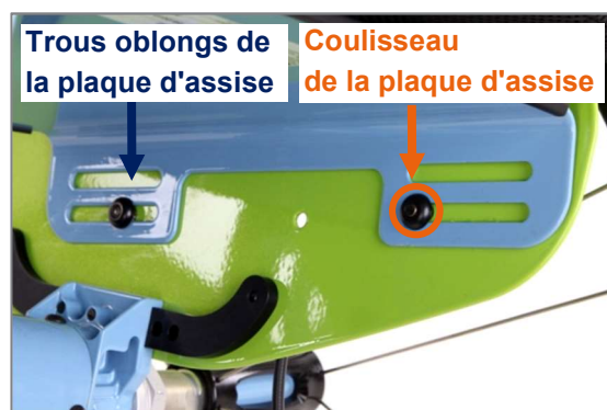
Figure 7 : Plaque d'assise avec trous oblongs et coulisseaux
