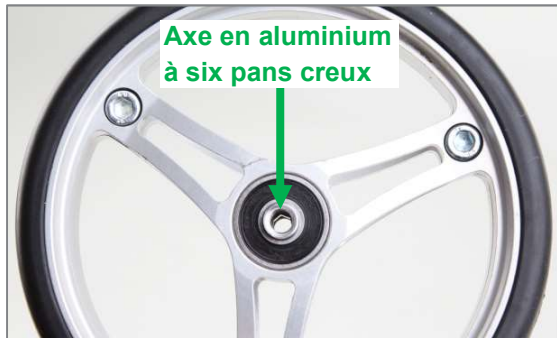
Figure 39 : Roue avant avec axe en aluminium à six pans creux
