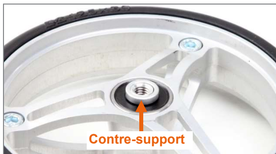
Figure 40 : Contre-support sur la roue avant
