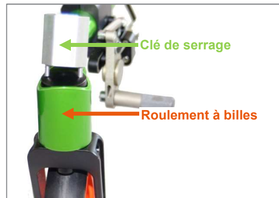
Figure 46 : Desserrage de l'écrou de l'axe de rotation de la fourche de roue avant avec clé de serrage
