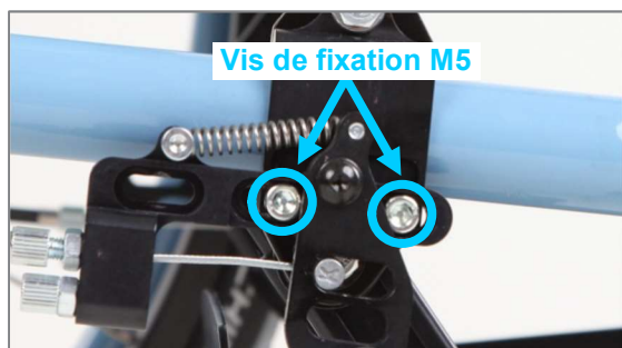
Figure 61 : Vis de fixation M5
