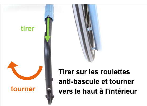
Figure 52 : Mettre les roulettes anti-bascule de la position de service à la position passive (vue arrière)
