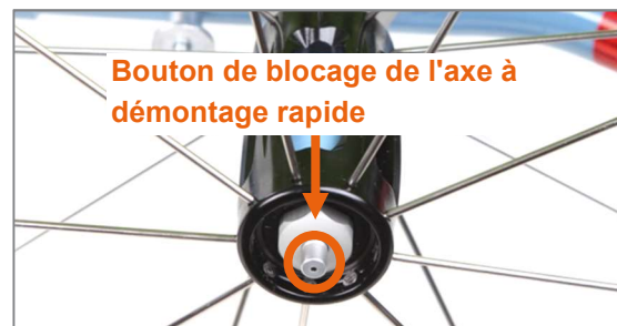
Figure 24 : Bouton de blocage de l'axe à démontage rapide au centre de l'axe de roue
