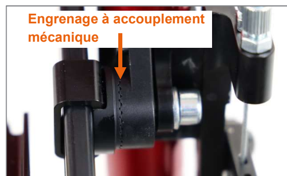
Figure 16 : Engrenage sur le tendeur du cale-pieds, à accouplement mécanique
