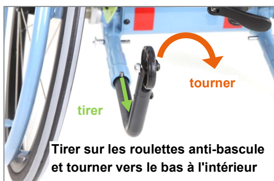
Figure 53 : Mettre les roulettes anti-bascule de la position passive à la position de service (vue arrière)
