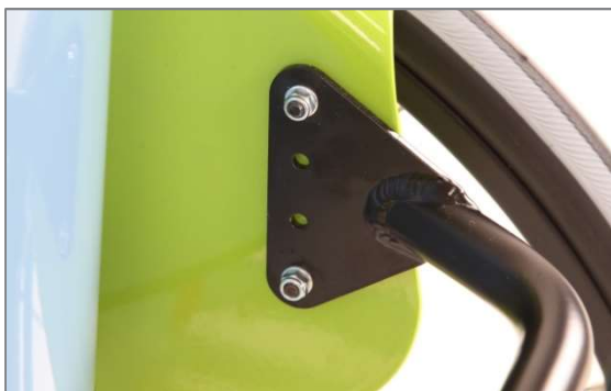
Figure 14 : Montage de la barre de renfort du dossier sur le LITTY 4all
