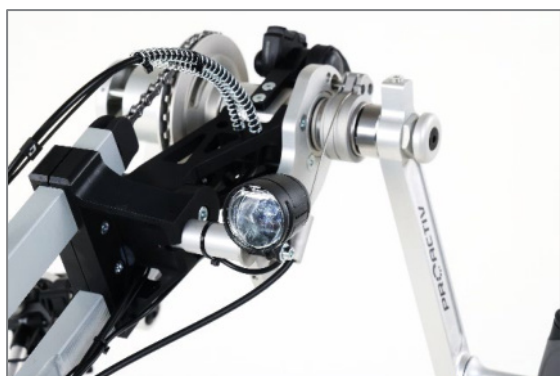
Figure 42 : Éclairage avant du kit d'éclairage à LED
