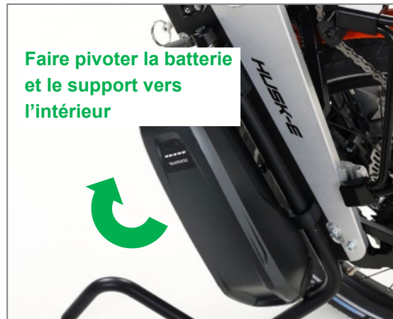
Figure 37 : Faire pivoter la batterie et le support vers l'intérieur pour les fixer
