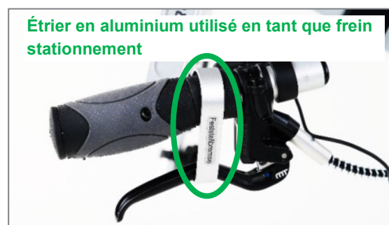
Figure 30 : Étrier en aluminium utilisé en tant que frein stationnement
