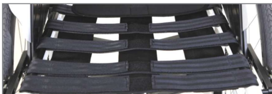
Figura 33: Sistema di cinghie aperto con nastri in pile-velcro per la regolazione dell'imbando
