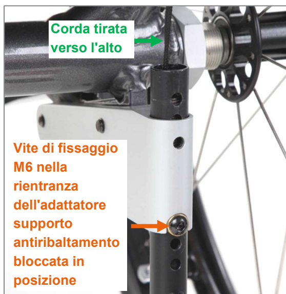
Figura 125: Staffa supporto antiribaltamento inserita nell'adattatore supporto antiribaltamento
