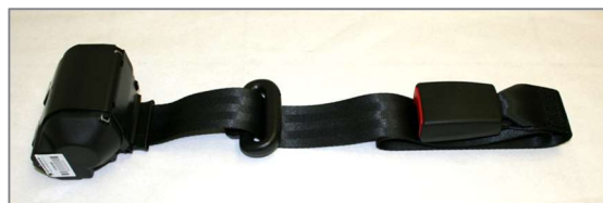
Figura 179: Cinghia trasversale per spalle automatica con rinvio e fibbia di chiusura
