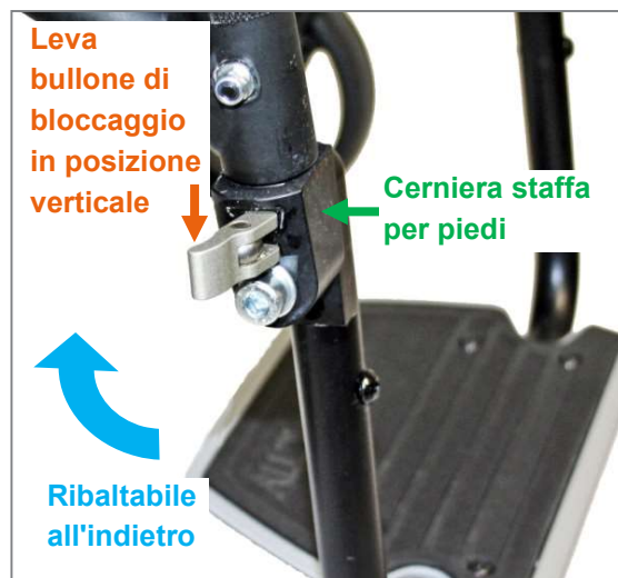
Figura 110: Leva bullone di bloccaggio in posizione verticali per la cerniera staffa per piedi, aperta
