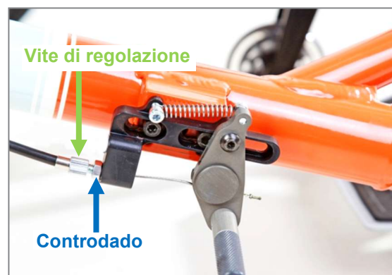
Figura 152: Regolazioni fini del freno tramite la vite di regolazione sul supporto inferiore del paranco a fune
