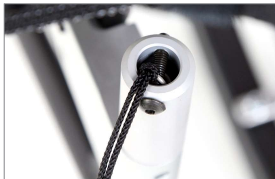
Figura 128: Vite di fissaggio M5 avvitata attraverso l'occhiello di chiusura della molla di trazione
