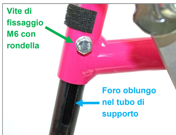
Figura 108: Vite di fissaggio M6 con rondella e foro oblungo nel tubo di supporto poggiapiedi per la regolazione della lunghezza della gamba
