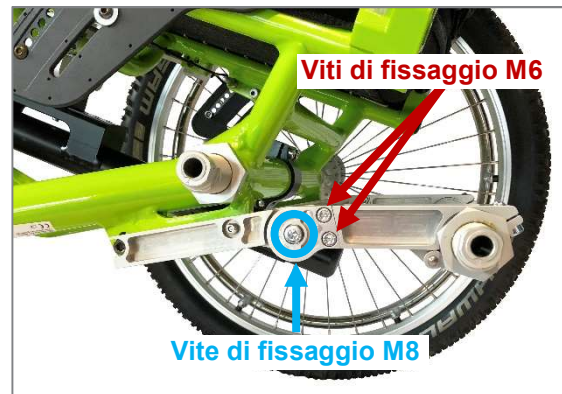
Figura 78: Viti di fissaggio M8 e M6 per la regolazione dell'inclinazione in caso di "prolungamento interasse con inclinazione regolabile e rimovibile"
