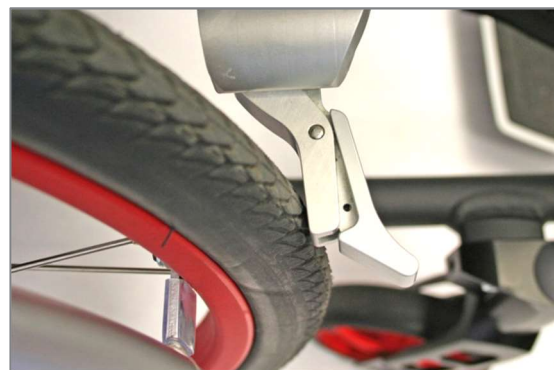
Figura 166: Elemento frenante a contatto con lo pneumatico
