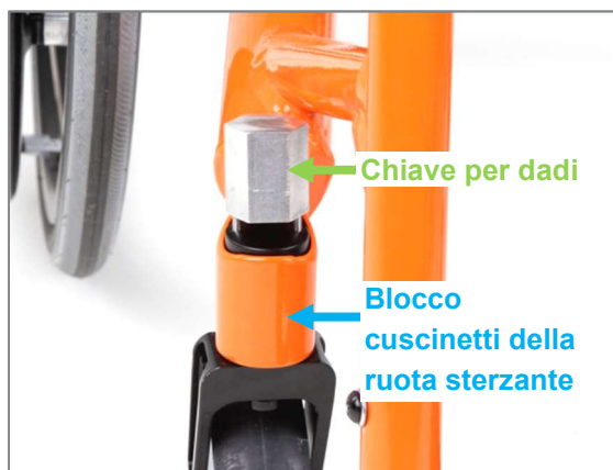
Figura 93: Allentamento del dado dell'asse di rotazione della forcella della ruota sterzante con la chiave per dadi
