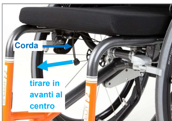
Figura 46: Corda per l'azionamento del bullone di bloccaggio
