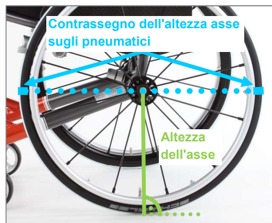
Figura 59: Contrassegno dell'altezza asse anteriormente e posteriormente su entrambi gli pneumatici
