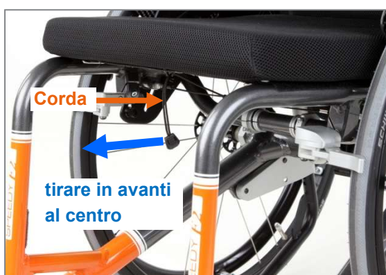
Figura 8: Corda per l'azionamento dei bulloni di bloccaggio e quindi la regolazione dell'angolazione dello schienale
