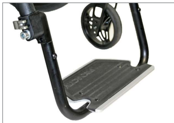
Figura 109: Poggiapiedi ribaltabile all'indietro, in posizione standard
