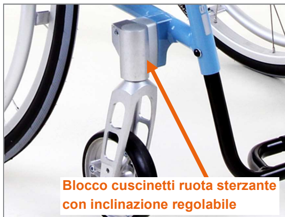
Figura 1: Blocco cuscinetti ruota sterzante con inclinazione regolabile
