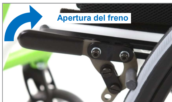
Figura 139: Freno chiuso; l'apertura viene effettuata tirando la leva del freno all'indietro verso l'alto.
