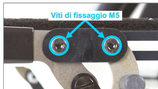
Figura 140: Viti di fissaggio M5 sulla guida di arresto del freno
