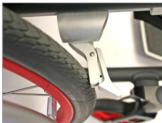
Figura 159: Elemento frenante a contatto con lo pneumatico
