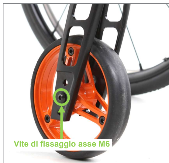
Figura 82: Vite di fissaggio M6 dell'asse ruota sterzante (vista dal lato esterno del prodotto)
