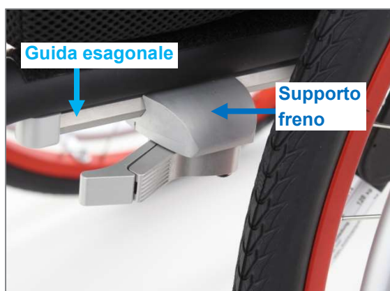
Figura 157: Guida esagonale e supporto freno
