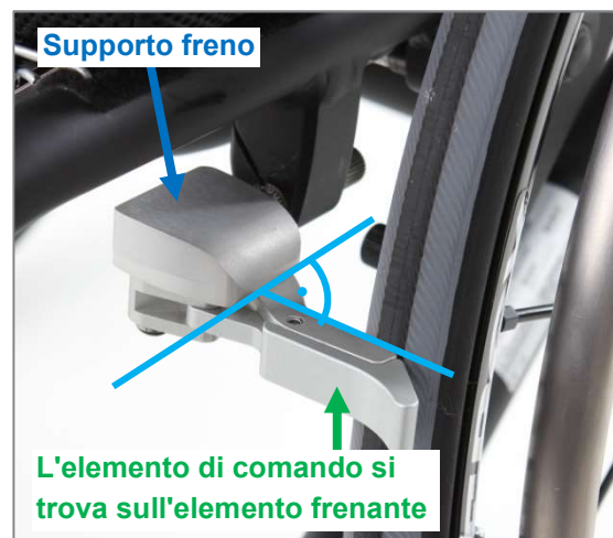
Figura 155: Freno integrale chiuso; elemento frenante in verticale rispetto al supporto freno
