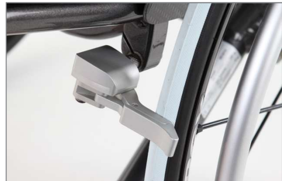
Figura 161: Applicazione del freno integrale sul tubo superiore del telaio
