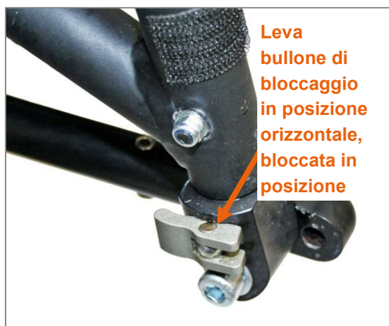
Figura 112: Leva bullone di bloccaggio, in posizione orizzontale, bloccata in posizione e quindi poggiante sulla cerniera staffa per piedi
