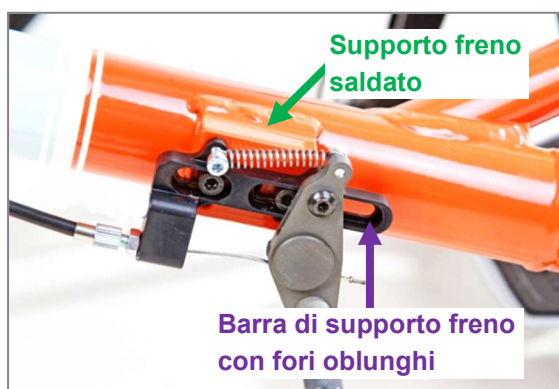
Figura 150: Supporto freno e barra di supporto freno
