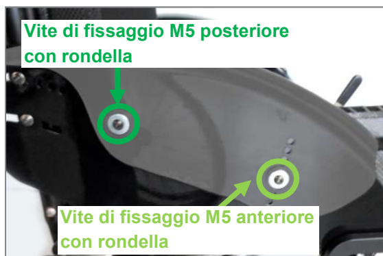
Figura 35: Piastra laterale con spondina paraspruzzi avvitata e viti di fissaggio M5 (vista senza ruota motrice)
