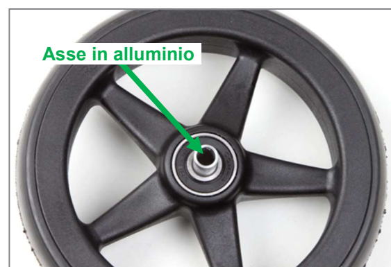
Figura 87: Ruota sterzante con asse in alluminio
