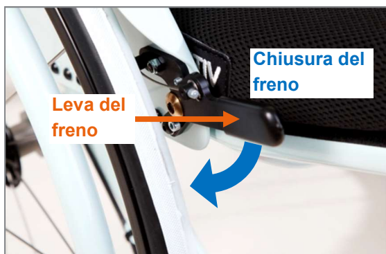
Figura 146: Freno aperto; la chiusura viene effettuata premendo in avanti verso il basso la leva del freno
