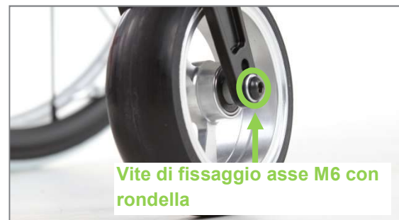
Figura 85: Vite di fissaggio M6 dell'asse ruota sterzante (vista dal lato esterno del prodotto)
