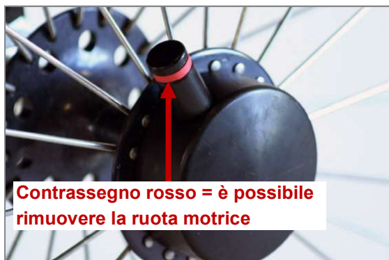
Figura 58: Tetra Clip con asse flottante aperto: è possibile rimuovere la ruota motrice
