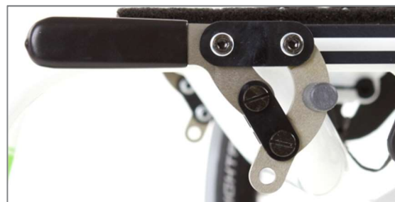
Figura 137: Sistema dei freni a leve separate con leva del freno standard
