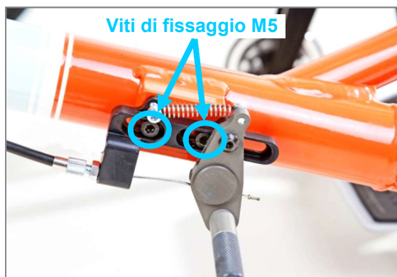
Figura 149: Viti di fissaggio M5
