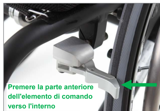
Figura 156: Freno integrale chiuso; l'apertura avviene premendo l'elemento di comando verso il centro della carrozzina
