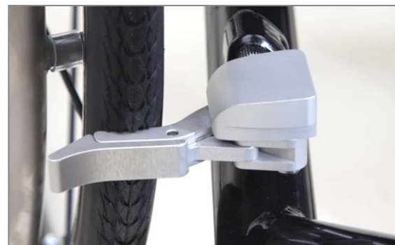
Figura 163: Applicazione del freno integrale sul tubo inferiore del telaio
