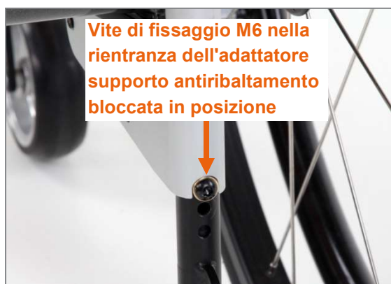
Figura 122: Supporto antiribaltamento bloccata correttamente in posizione
