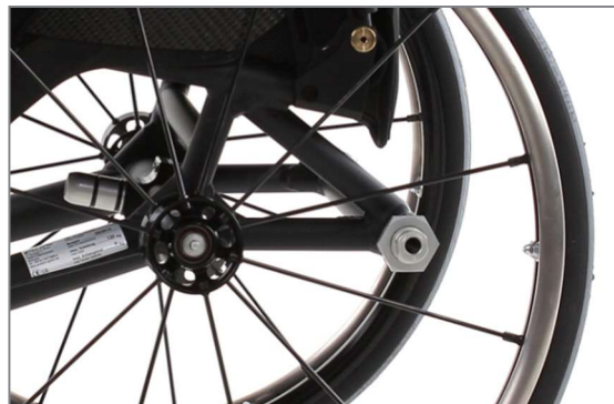
Figura 69: Prolungamento interasse saldato fisso (SPEEDY F2 sovradimensionata)
