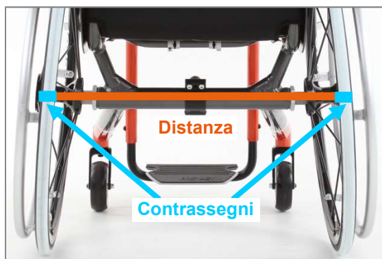
Figura 60: Distanza tra i contrassegni degli pneumatici (ad altezza asse), posteriormente
