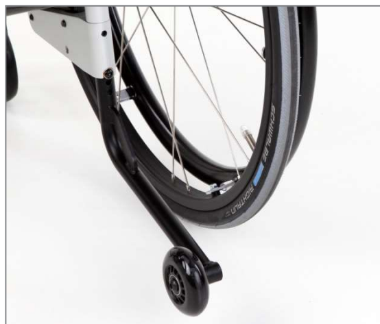
Figura 119: Posizione attiva del supporto antiribaltamento (vista posteriore)
