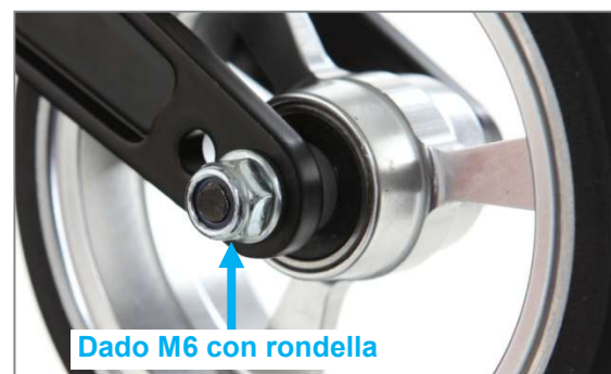
Figura 86: Dado M6 dell'asse ruota sterzante (vista dal lato interno del prodotto)
