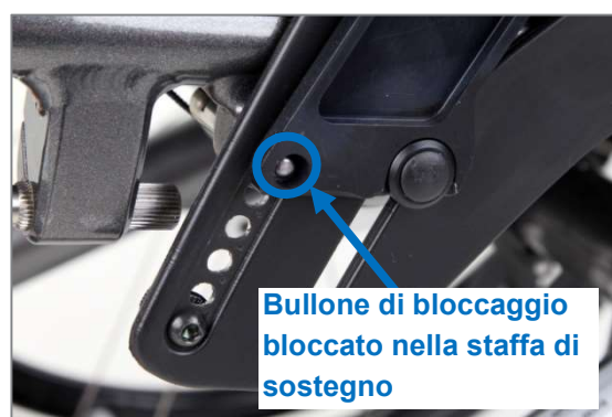
Figura 44: Bullone di bloccaggio bloccato nella staffa di sostegno della spondina paraspruzzi (vista con spondina paraspruzzi)
