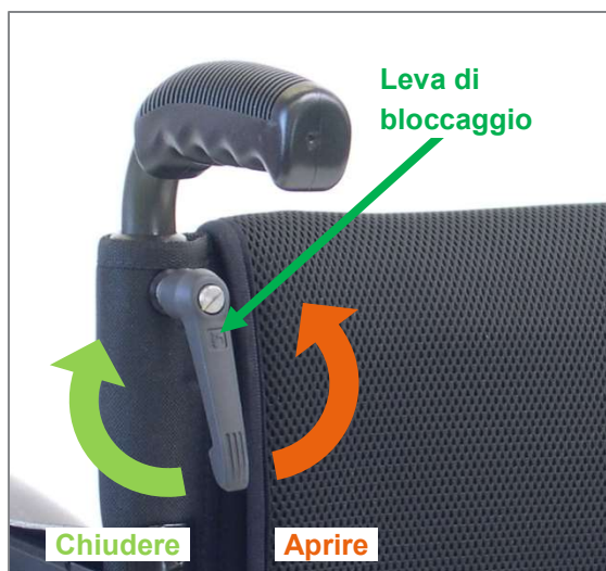
Figura 172: Maniglia di spinta di sicurezza con regolazione continua in altezza
