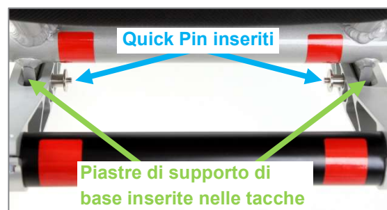
Figura 75: Prolungamento interasse applicato, Quick Pin inseriti (vista posteriore)
