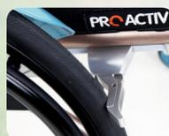
Elegante freno di stazionamento integrale con funzionamento comodo e sicuro.
