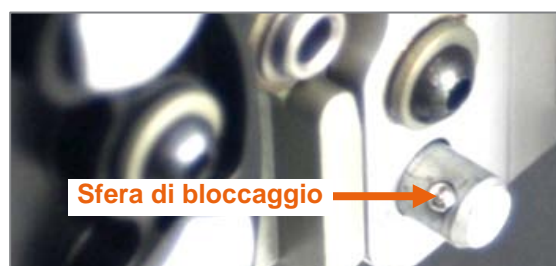
Figura 69: Perno di sicurezza con sfera di bloccaggio, sfera di bloccaggio bloccata sul lato esterno destro della piastra di posizionamento
