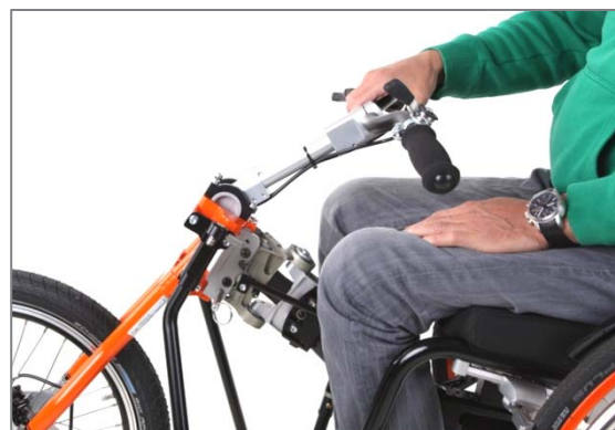
Figura 80: Perno di sospensione inserito nella bocca di aggancio sulla testa di sterzo
