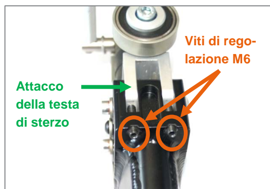
Figura 19: Viti di regolazione M6 in alto sull'attacco della testa di sterzo
