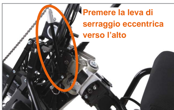
Figura 67: La leva di serraggio a eccentrico viene premuta su "tendere"
