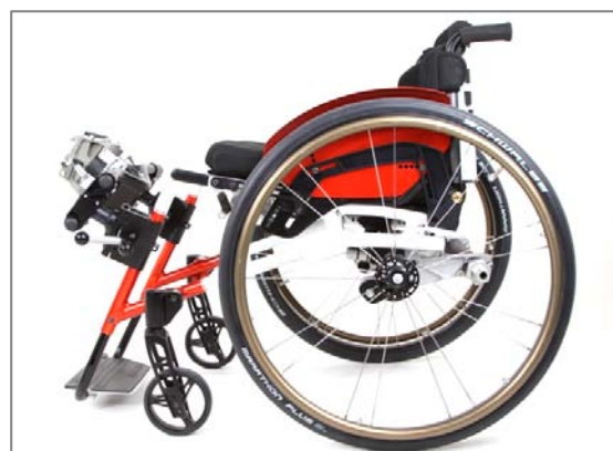
Figura 46: Adattatore frontale sui tubi anteriori del telaio
