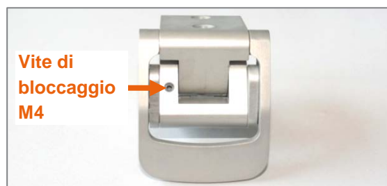
Figura 39: Vite di bloccaggio M4 per la regolazione della forza di azionamento per l'apertura e la chiusura della pinza a morsa
