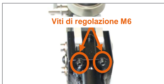
Figura 45: Viti di regolazione M6 posizionate sull'attacco della testa di sterzo
