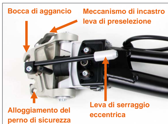
Figura 76: Termini testa di sterzo
