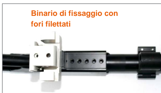
Figura 28: Posizionamento della pinza a morsa in scatti di 15 mm
