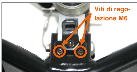
Figura 58: Viti di regolazione M6 posizionate sull'attacco della testa di sterzo
