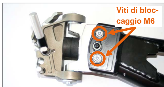
Figura 44: Viti di bloccaggio M6 sulla testa di sterzo
