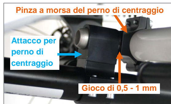
Figura 30: Attacco del perno di centraggio sul perno di centraggio
