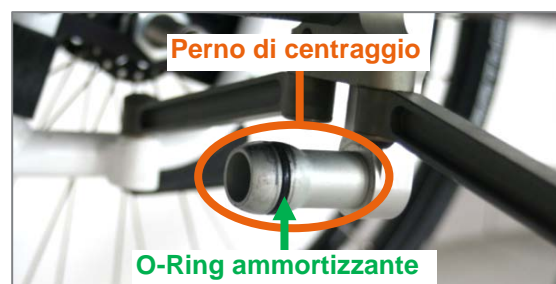
Figura 4: Meccanismo di piegatura con piastra adattatrice e perno di centraggio (lato carrozzina)
