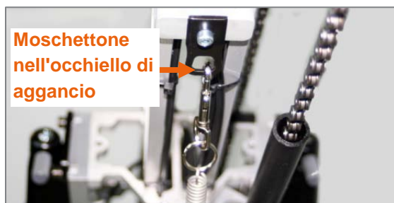
Figura 70: Kit di aggancio per adattatore frontale, moschettone nell'occhiello di aggancio
