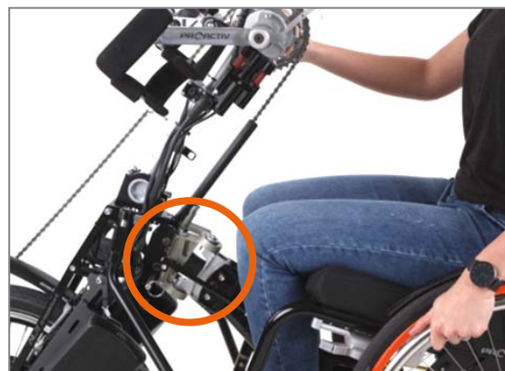
Figura 64: Aggancio del perno della piastra di posizionamento nella bocca di aggancio sulla testa di sterzo
