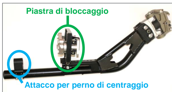
Figura 5: Elementi di adattamento dell'adattatore
