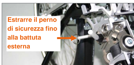
Figura 72: Regolazioni dell'adattatore frontale per iniziare l'adattamento
