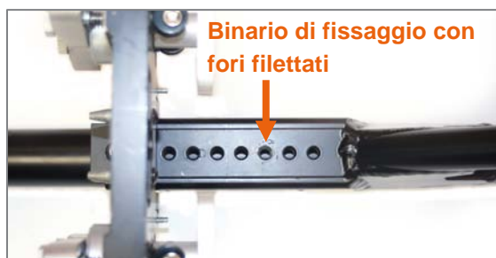
Figura 6: Posizionamento della piastra di bloccaggio in scatti di 15 mm
