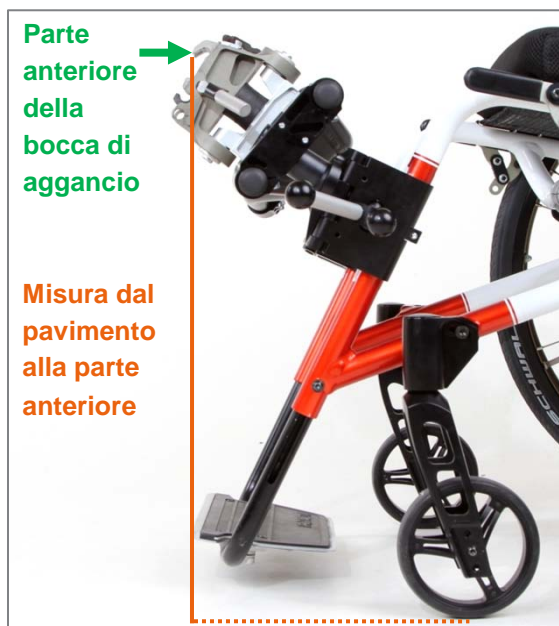
Figura 51: Misura dal pavimento fino alla parte anteriore della bocca di aggancio
