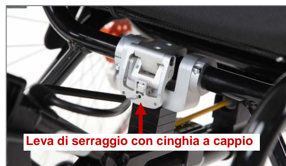
Figura 33: Leva di serraggio con cinghia a cappio in posizione chiusa, adattatore per telaio rigido montato pronto all'uso
