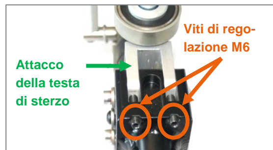
Figura 42: Viti di regolazione M6 in alto sull'attacco della testa di sterzo
