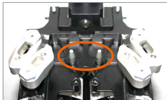
Figura 10: Perna di centraggio montati per pezzo centrale largo
