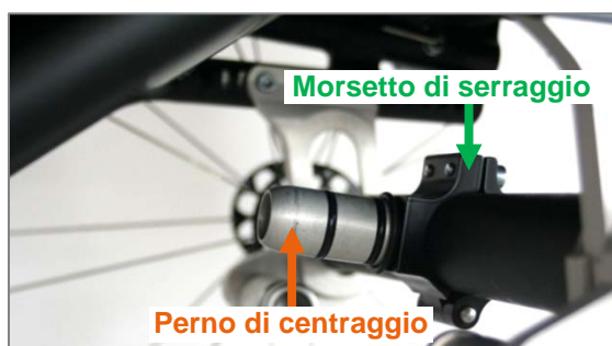
Figura 25: Perno di centraggio con morsetto di serraggio
