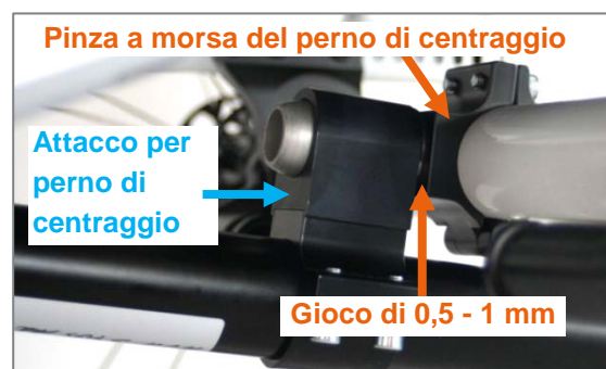
Figura 34: Attacco del perno di centraggio sul perno di centraggio, adattatore per telaio rigido montato pronto all'uso
