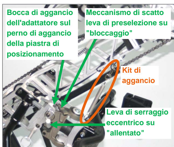
Figura 71: Regolazioni dell'adattatore frontale per iniziare l'adeguamento (meccanismo di scatto leva di preselezione e leva di serraggio eccentrico)
