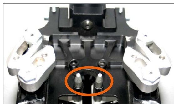
Figura 11: Perna di centraggio montati per pezzo centrale stretto
