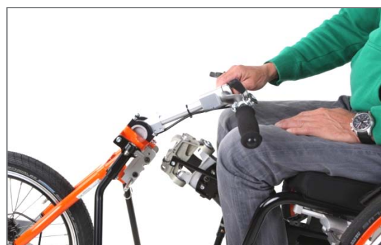
Figura 79: Aggancio del perno della piastra di posizionamento nella bocca di aggancio sulla testa di sterzo
