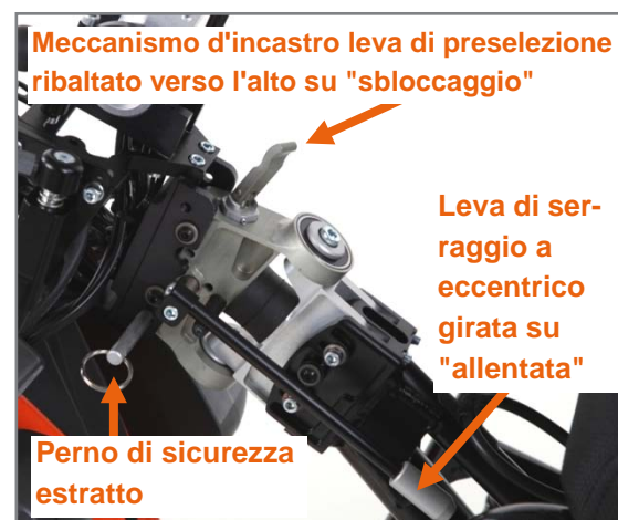
Figura 94: Preparazione al disaccoppiamento
