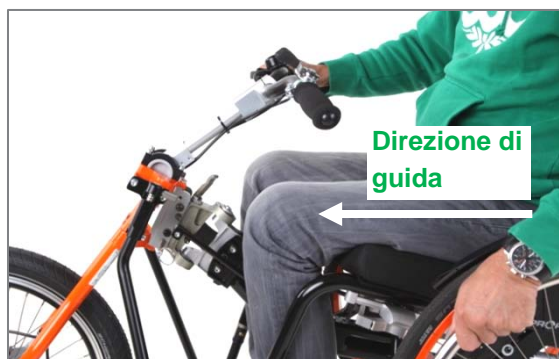
Figura 81: Premere il freno del prodotto e avanzare con i mancorrenti in direzione del prodotto fino all'arresto
