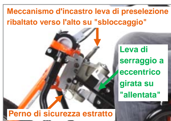
Figura 84: Preparazione al disaccoppiamento
