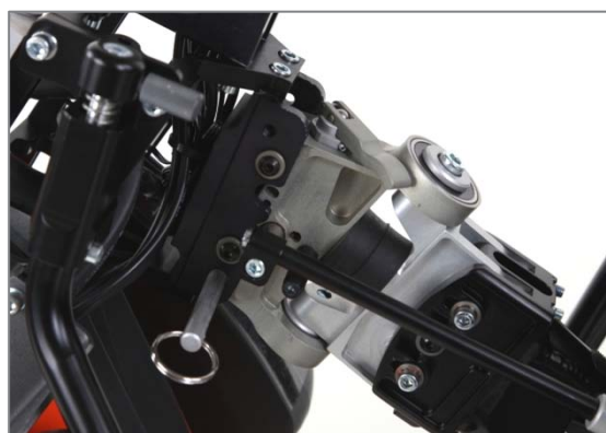
Figura 91: Testa dell'adattatore completamente posizionata sulla piastra di posizionamento
