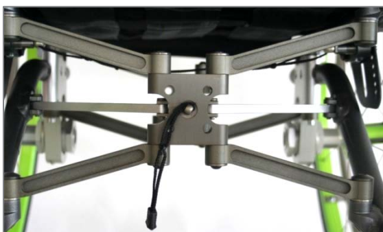
Figura 18: Posizione cordino di sgancio errata, fori per i perni di centraggio coperti in basso a sinistra
