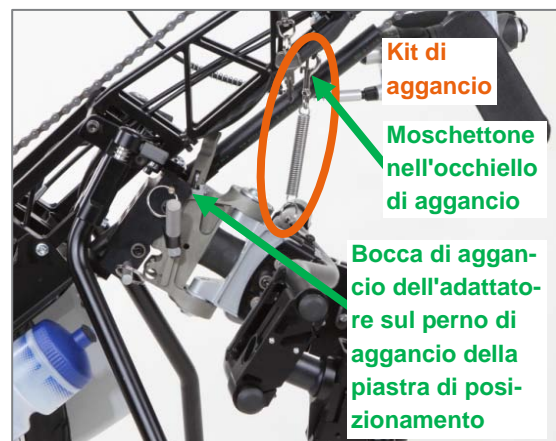
Figura 75: Adattatore frontale sul prodotto che rimane con meccanismo quick-snap aperto
