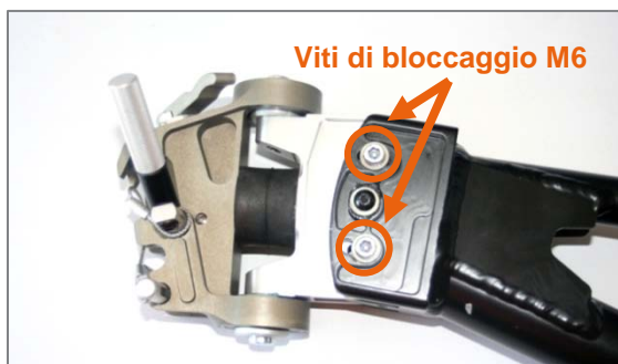
Figura 20: Viti di bloccaggio M6 sulla testa di sterzo
