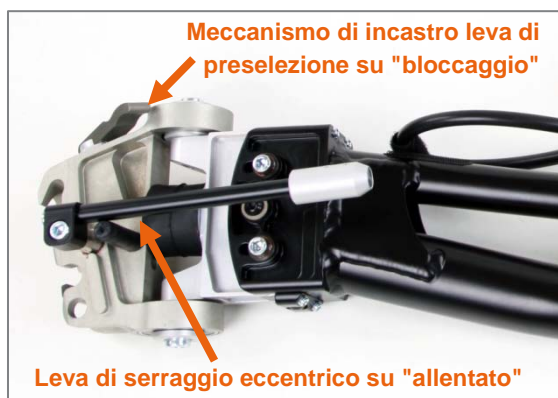
Figura 62: Regolazioni dell'adattatore all'inizio dell'adattamento
