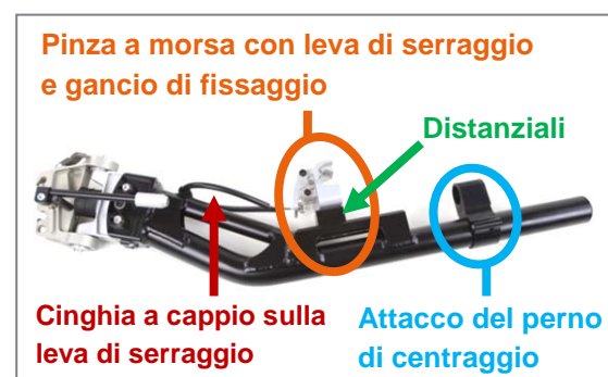
Figura 26: Elementi di adattamento dell'adattatore
