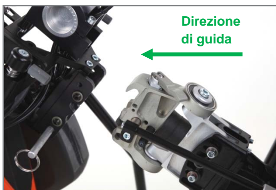
Figura 89: Aggancio del perno di sospensione della piastra di posizionamento nella bocca di aggancio sulla testa dell'adattatore
