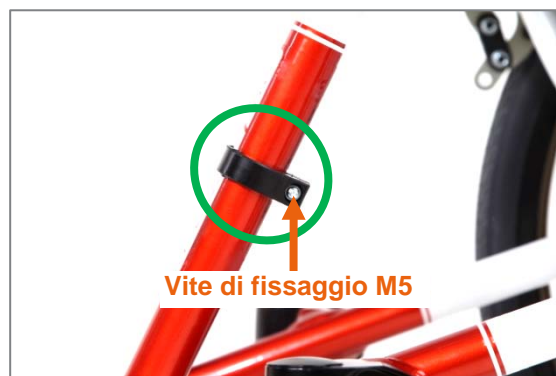
Figura 53: Battuta manicotto di bloccaggio montata (lato carrozzina)
