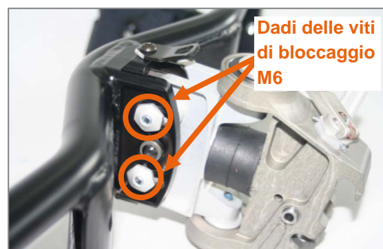
Figura 57: Dadi delle viti di bloccaggio M6 sulla testa di sterzo
