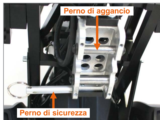
Figura 61: Termini piastra di posizionamento
