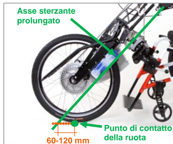
Figura 56: Incidenza a seconda della regolazione dell'inclinazione della testa di sterzo
