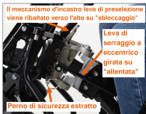
Figura 73: Preparazione al disaccoppiamento
