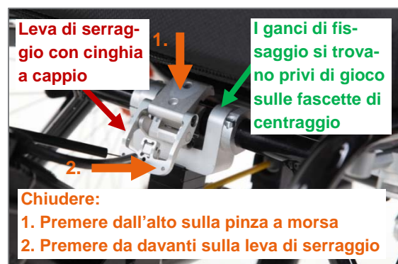
Figura 32: Leva di serraggio con cinghia a cappio in posizione aperta e i ganci di fissaggio si trovano privi di gioco sulle fascette di centraggio; per bloccare l'adattatore sulla carrozzina premere sulla leva di serraggio fino a quando il dispositivo di bloccaggio non si innesta con un suono udibile.
