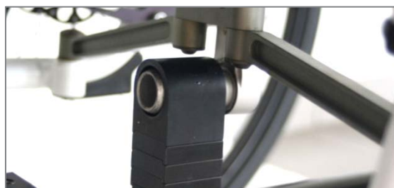
Figura 14: Perno di centraggio con attacco applicato
